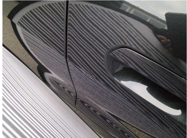
Beschädigung 1: Tür vorn rechts: Tür - Delle(n) - Smart Repair
