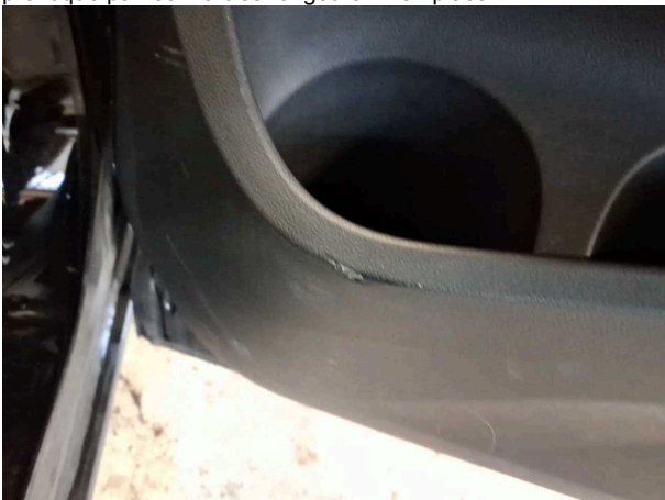
Domage #3: Habillages/Protections: Habillage porte arrière dro... - Erafilé - Diminution de valeur
