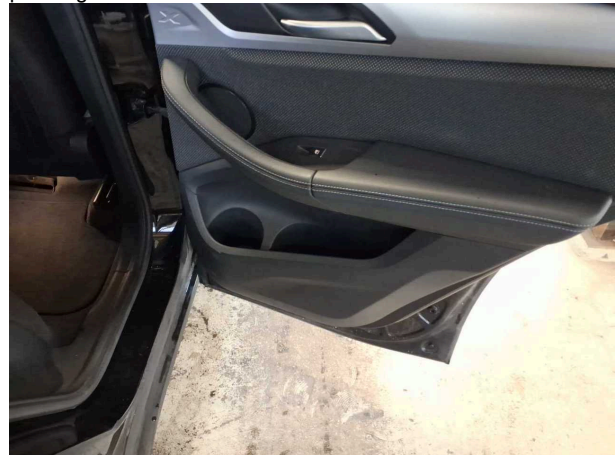
Domage #3: Habillages/Protections: Habillage porte arrière droite - Erafilé - Diminution de valeur
