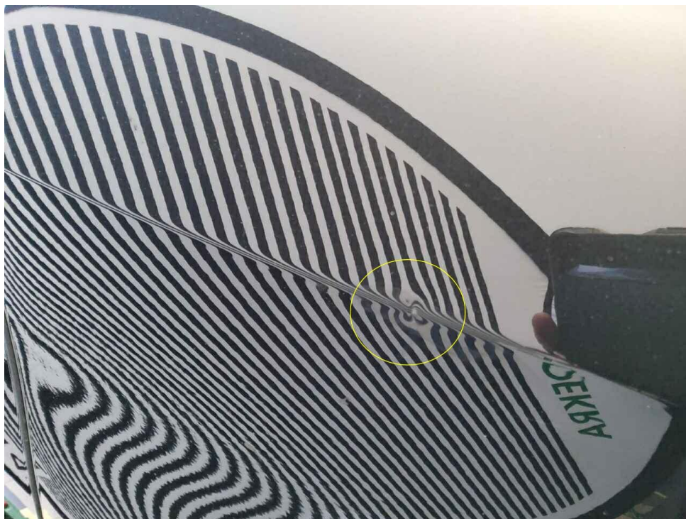
Bild 18 : Tür vorne links, deformiert, instandsetzen und lackieren mit Lackaufbau
