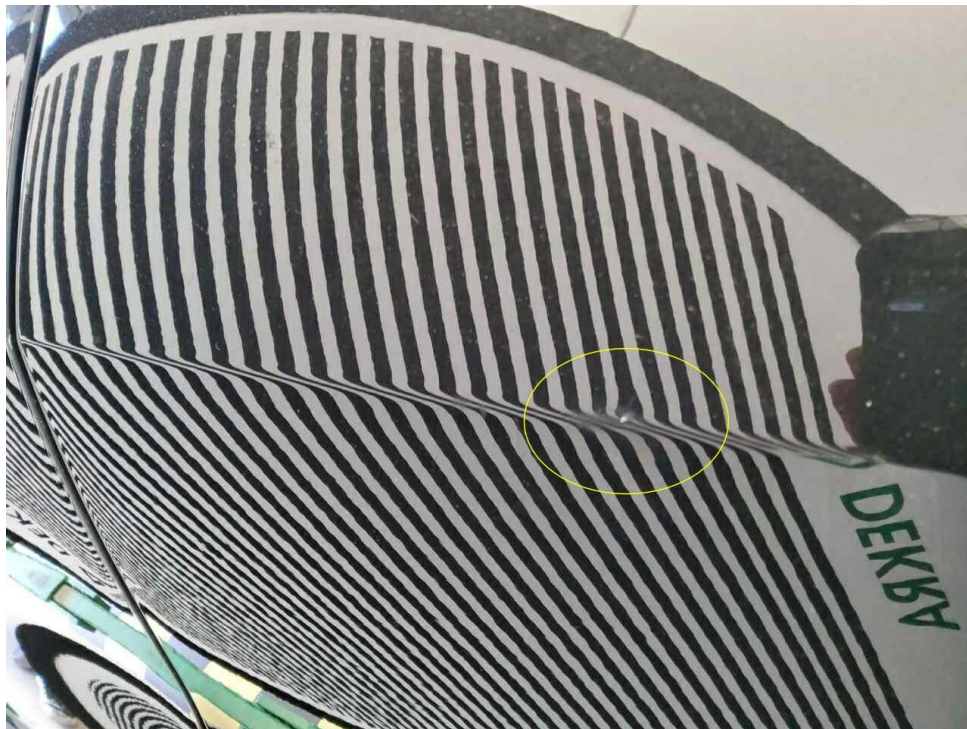
Bild 17 : Tür hinten links, deformiert, instandsetzen und lackieren mit Lackaufbau
