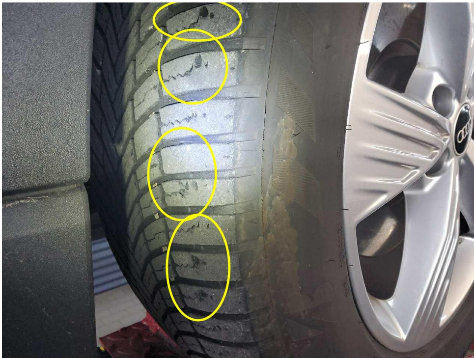
Bild 16 : Vorderachse Reifen beschädigt ( Schadhaut )
