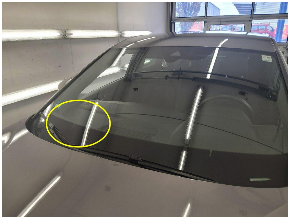
Bild 14 : Frontscheibe, Steinschlag mit Rissbildung
