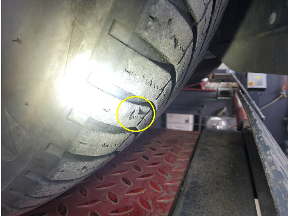
Bild 21 : Vorderachse Reifen beschädigt ( Schadhft )
