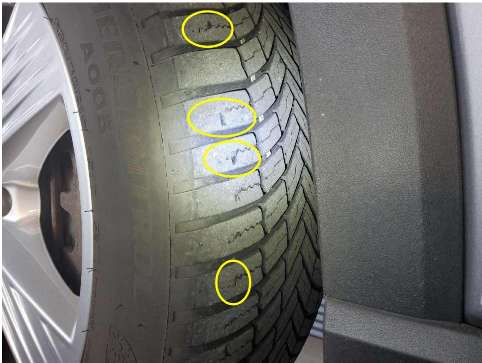
Bild 18 : Vorderachse Reifen beschädigt ( Schadhaft )
