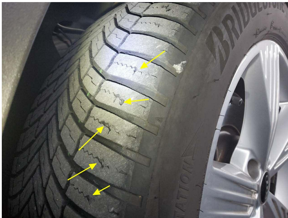
Bild 19 : Vorderachse Reifen beschädigt ( Schadhaft )
