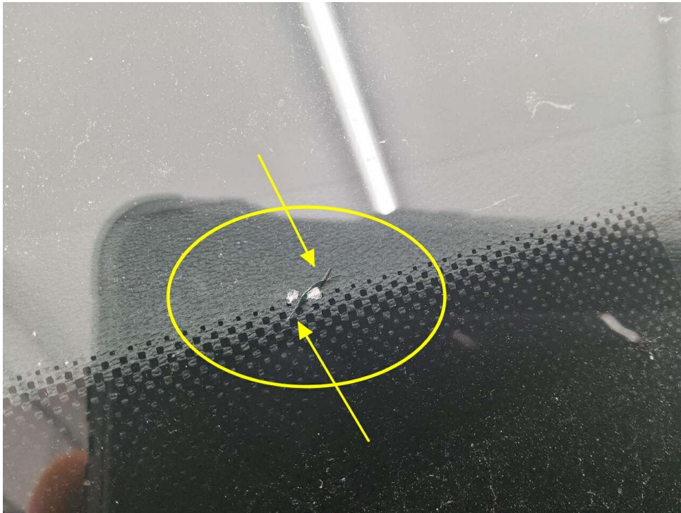
Bild 15 : Frontscheibe, Steinschlag mit Rissbildung
