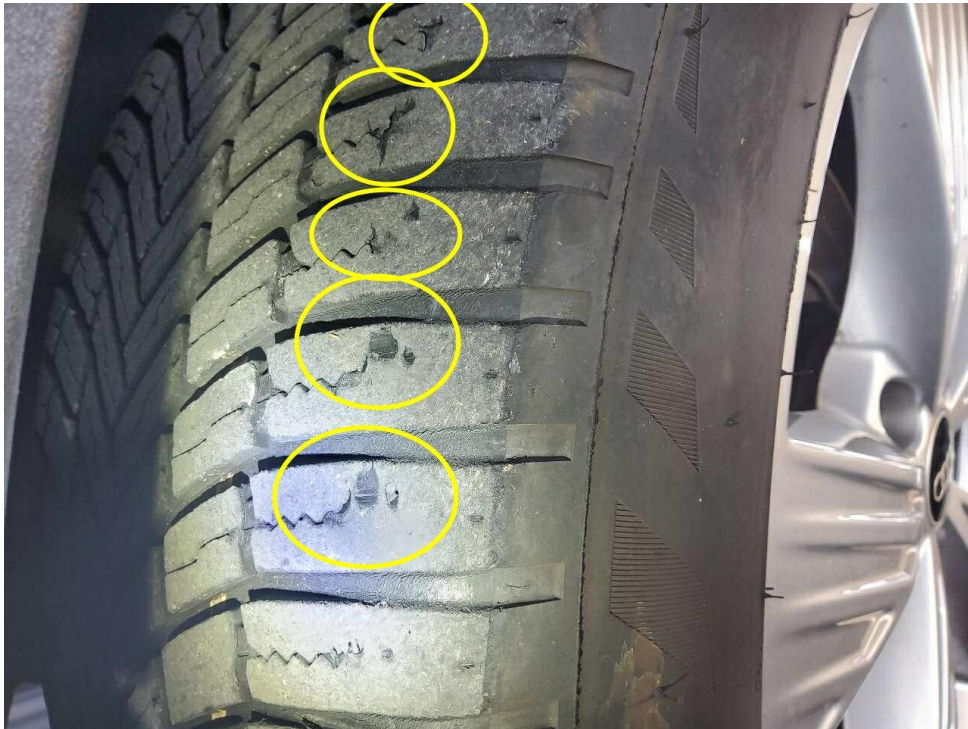
Bild 17 : Vorderachse Reifen beschädigt ( Schadhaft )
