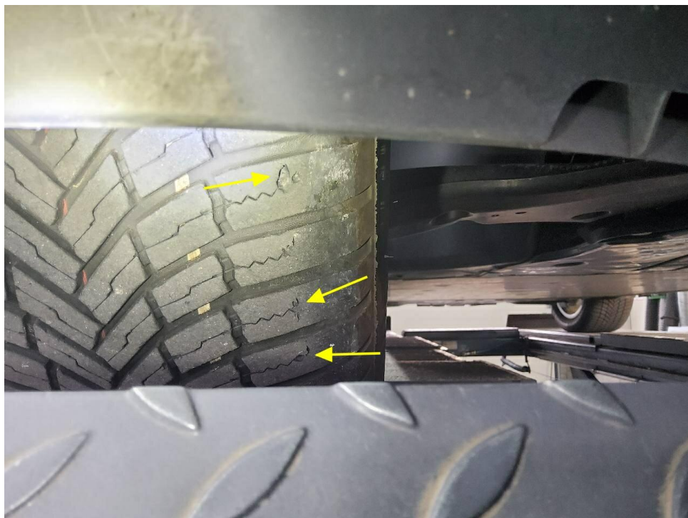
Bild 20 : Vorderachse Reifen beschädigt ( Schadhaft )
