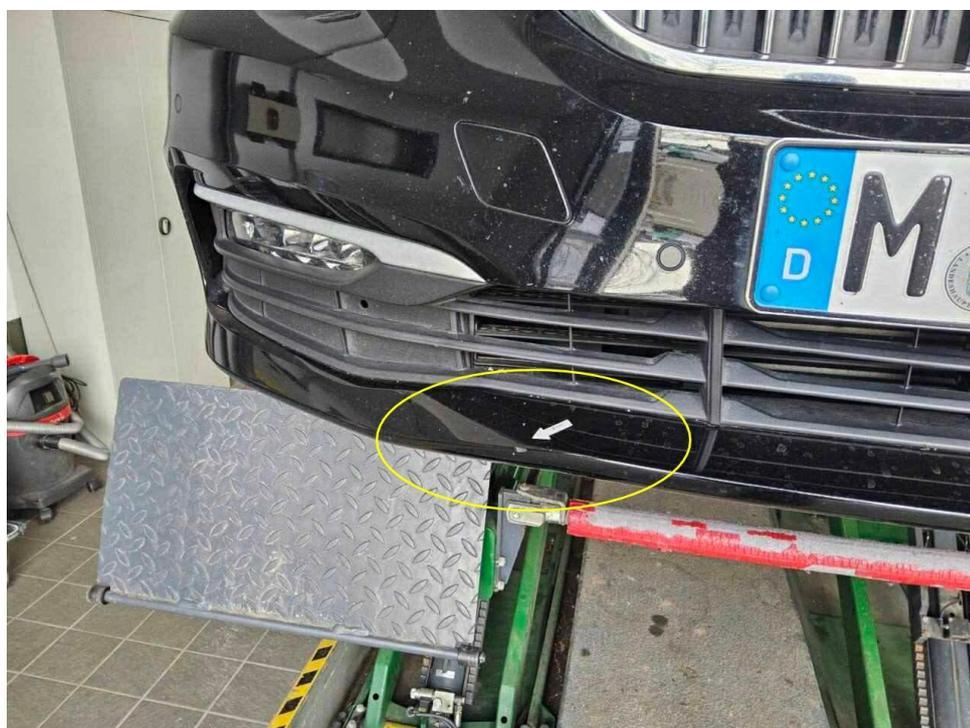
Bild 16 : Stoßfänger vorne Lackierung, zerkratzt, smart repair
