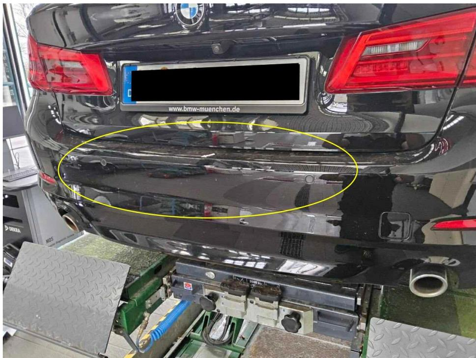
Bild 14 : Stoßfänger hinten Lackierung, verschrammt, Gebrauchsspur
