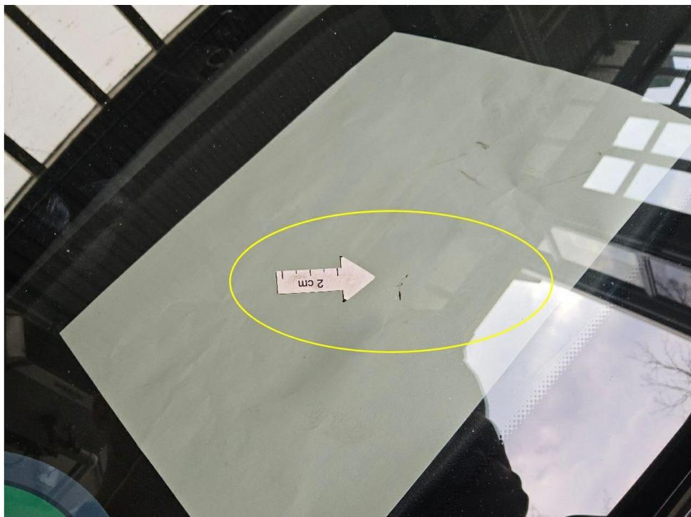
Bild 26 : Frontscheibe, instandgesetzter Steinschlag
