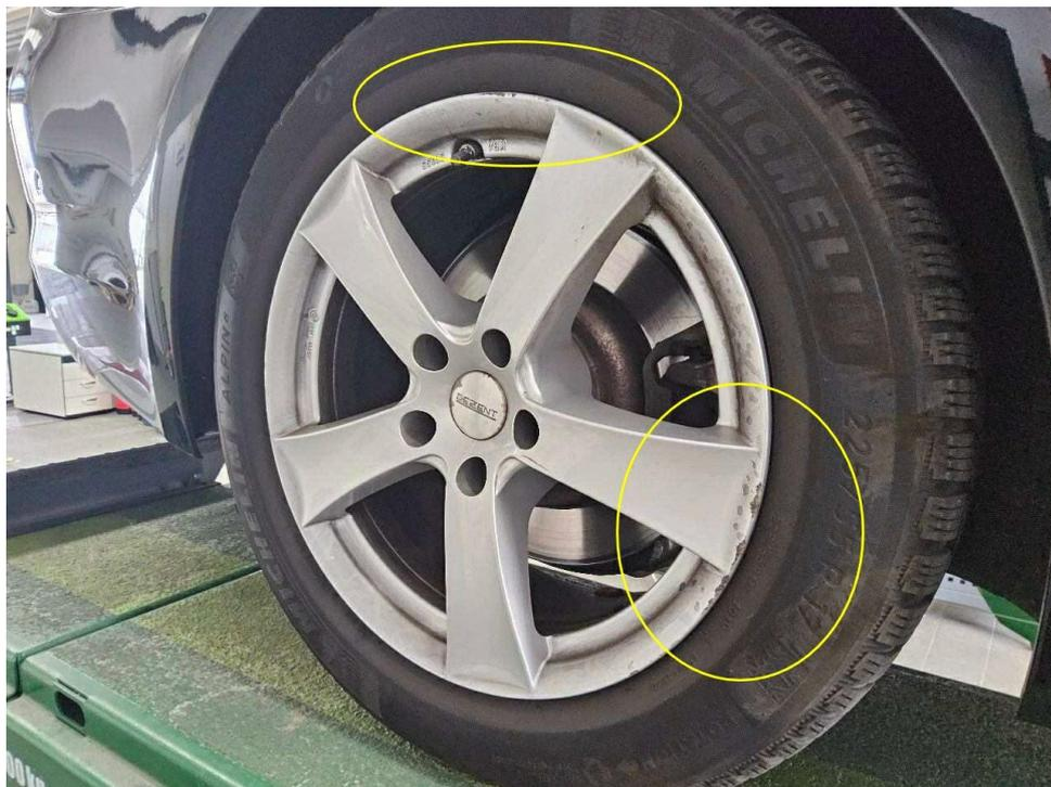
Bild 21 : Zubehörfelge hinten rechts, zerkratzt
