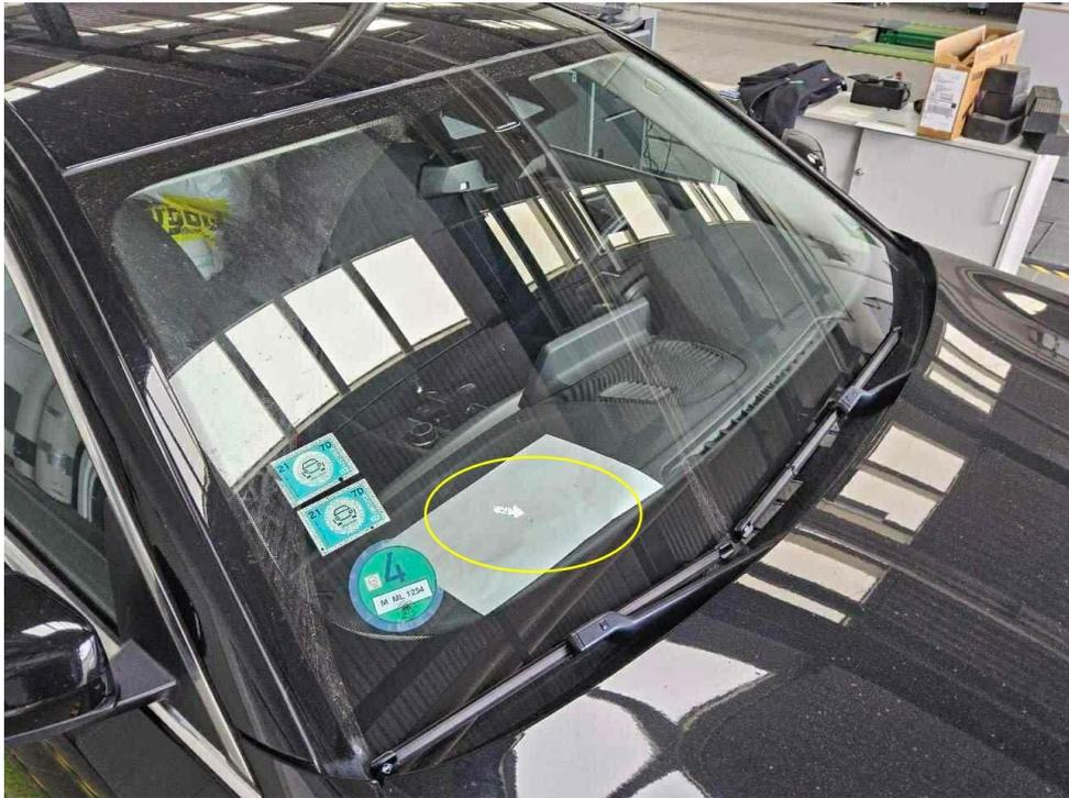
Bild 27 : Frontscheibe, instandgesetzter Steinschlag
