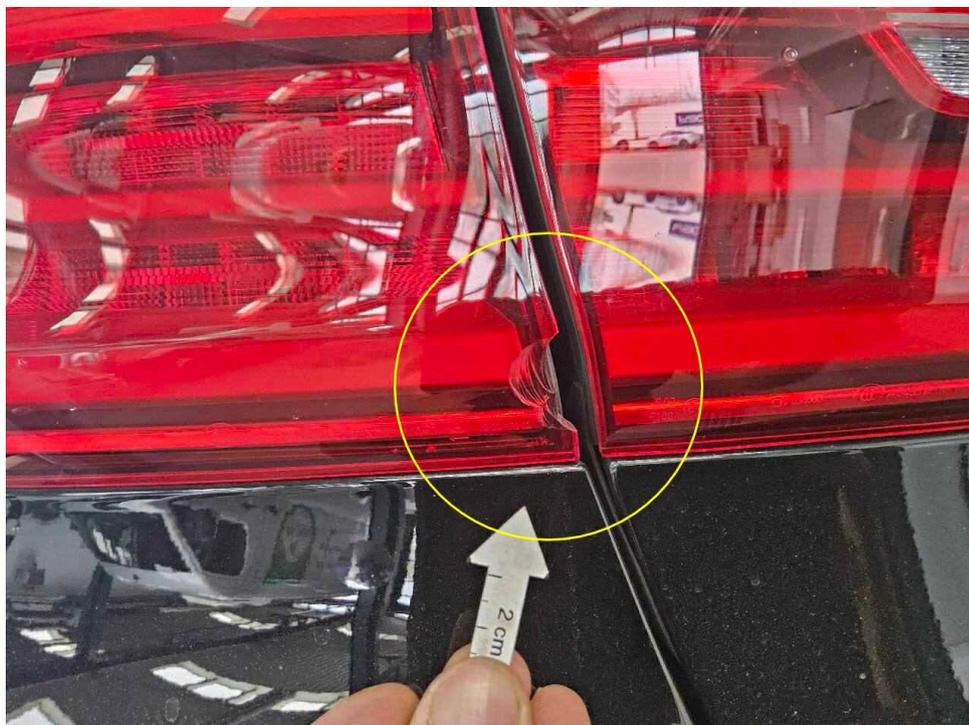
Bild 24 : Rücklicht links, gebrochen
