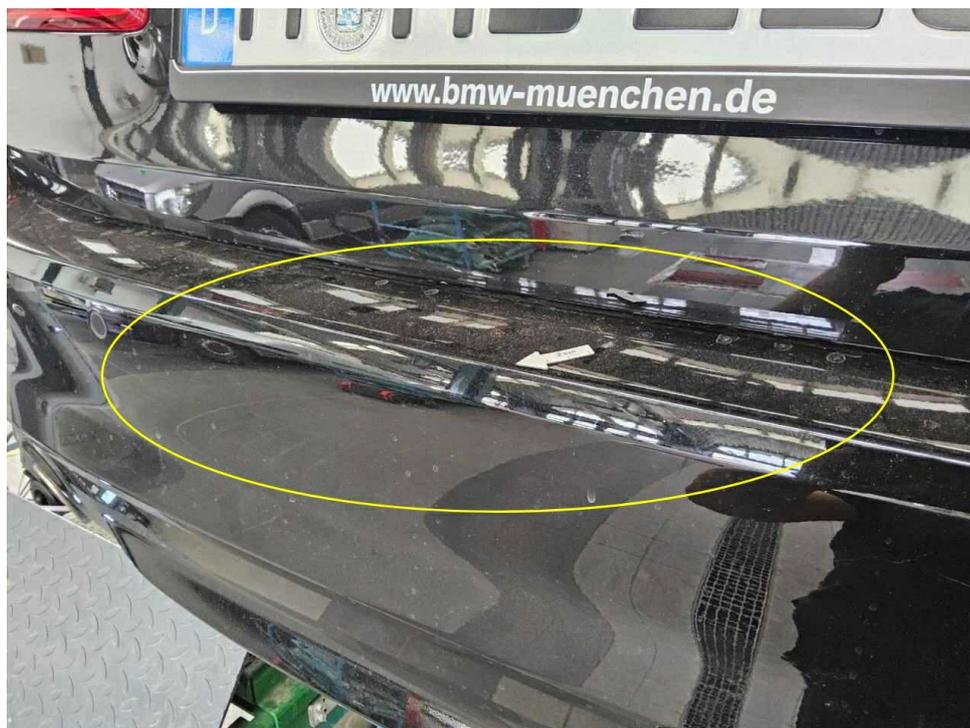
Bild 15 : Stoßfänger hinten Lackierung, verschrämmt, Gebrauchsspur
