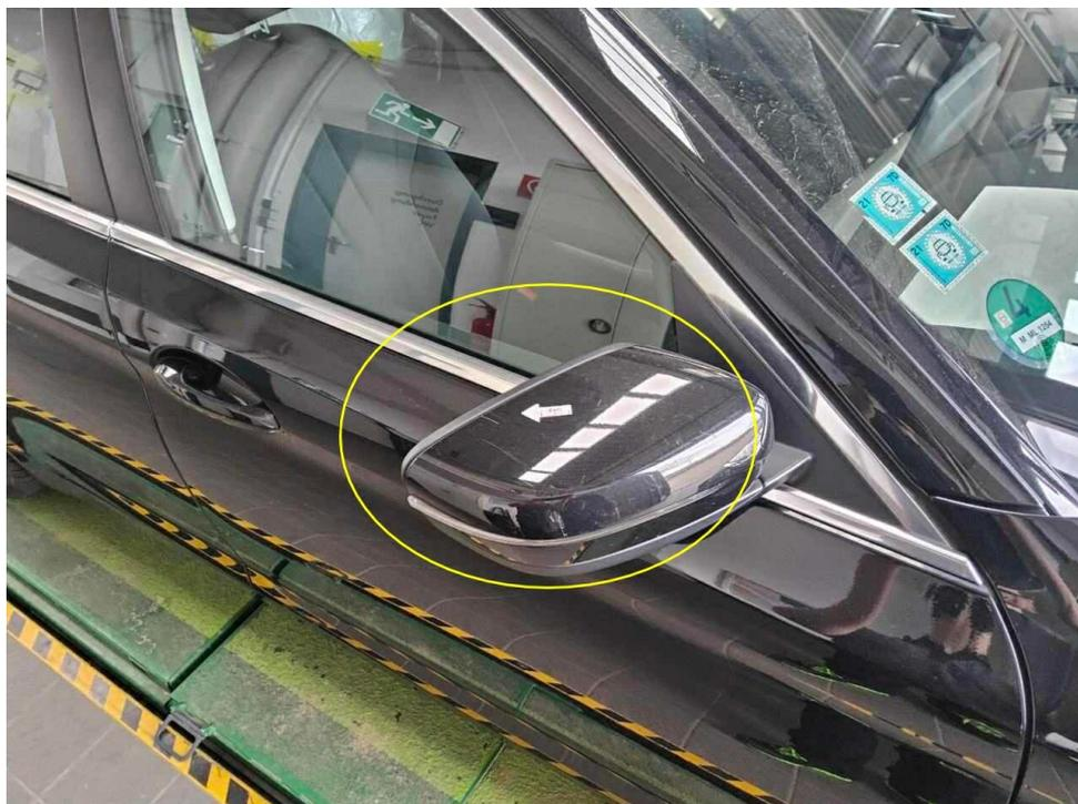
Bild 18 : Außenspiegel rechts Lackierung, verschrammt, Gebrauchsspur
