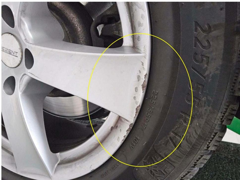
Bild 20 : Zubehörfelge hinten rechts, zerkratzt
