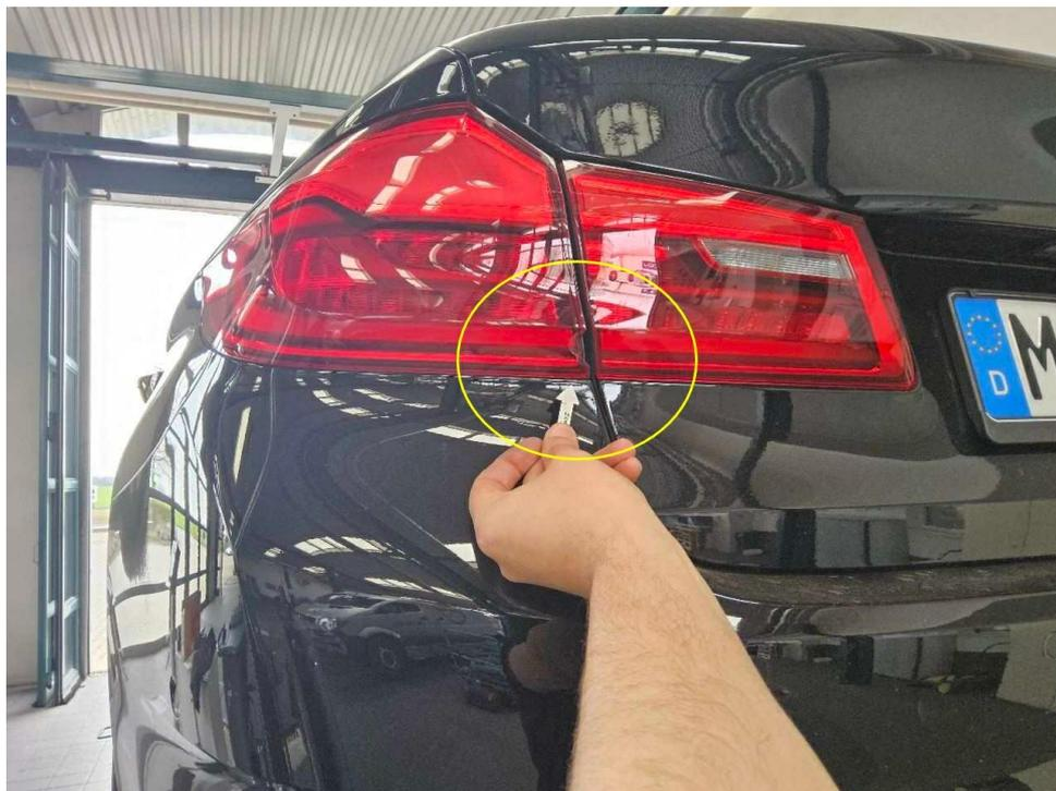
Bild 25 : Rücklicht links, gebrochen
