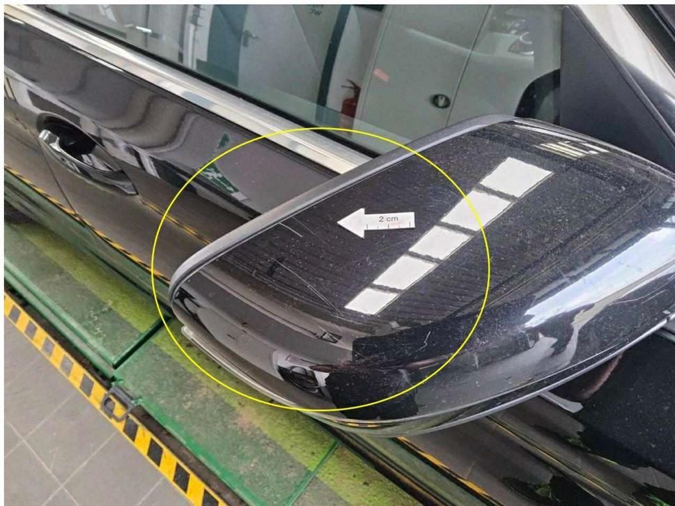
Bild 19 : Außenspiegel rechts Lackierung, verschrämmt, Gebrauchsspur
