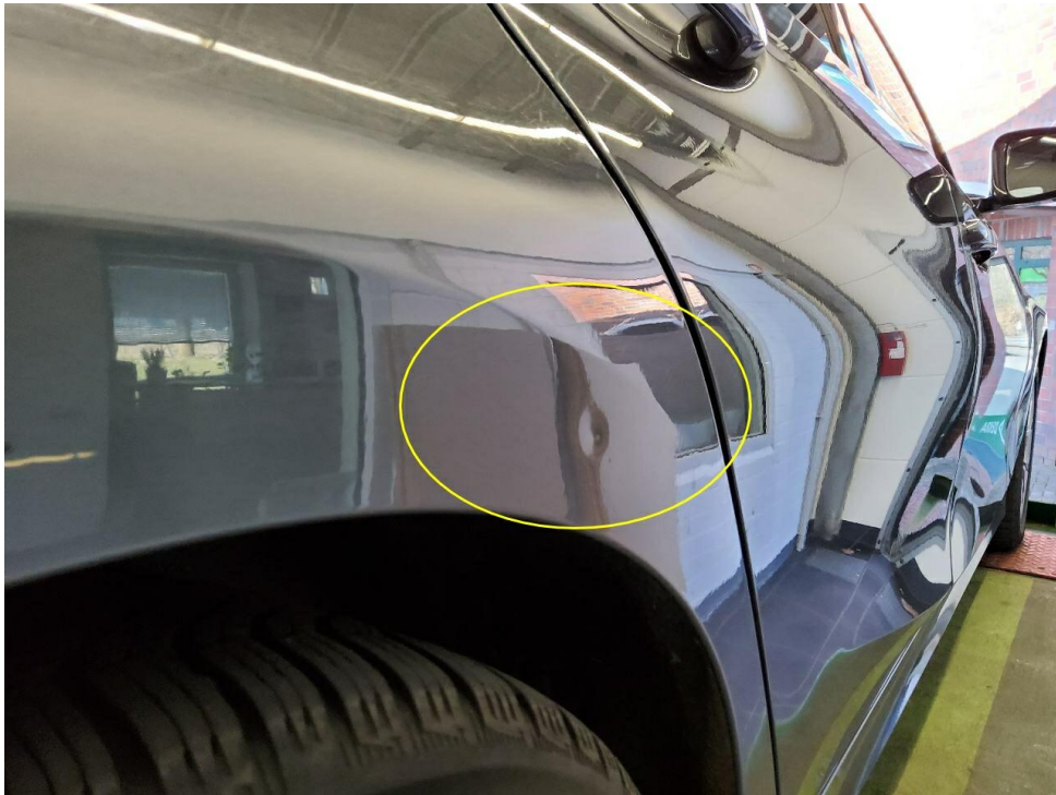
Bild 17 : Seitenteil hinten rechts, eingedellt, smart repair
