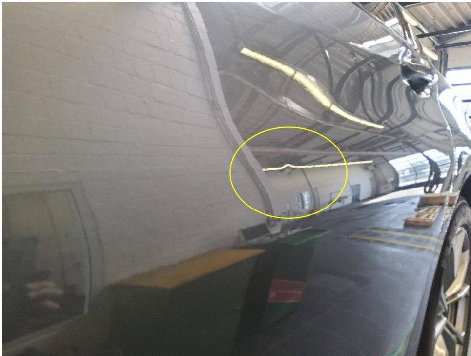
Bild 16 : Tür hinten links, eingedellt, smart repair
