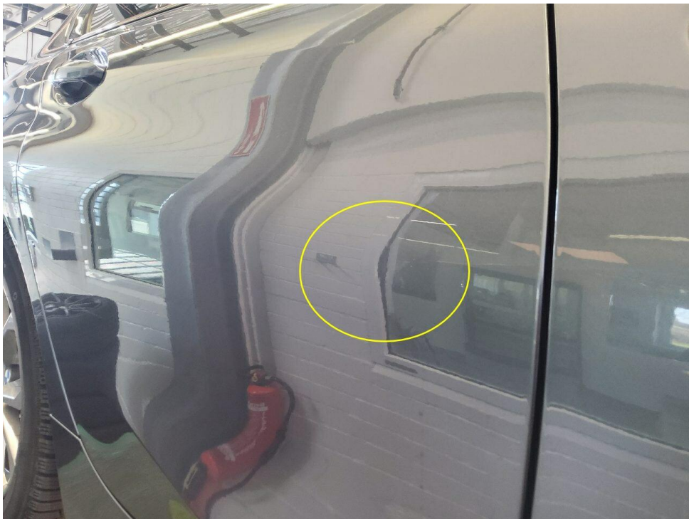
Bild 18 : Tür hinten rechts, eingedellt, smart repair
