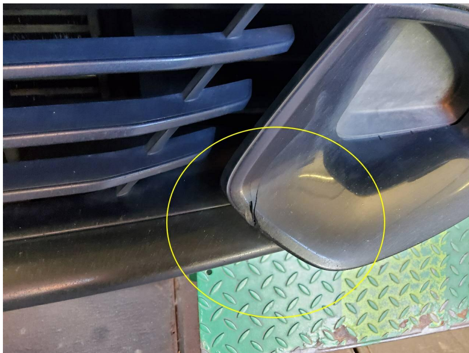
Bild 20 : Spoiler vorn links gebrochen
