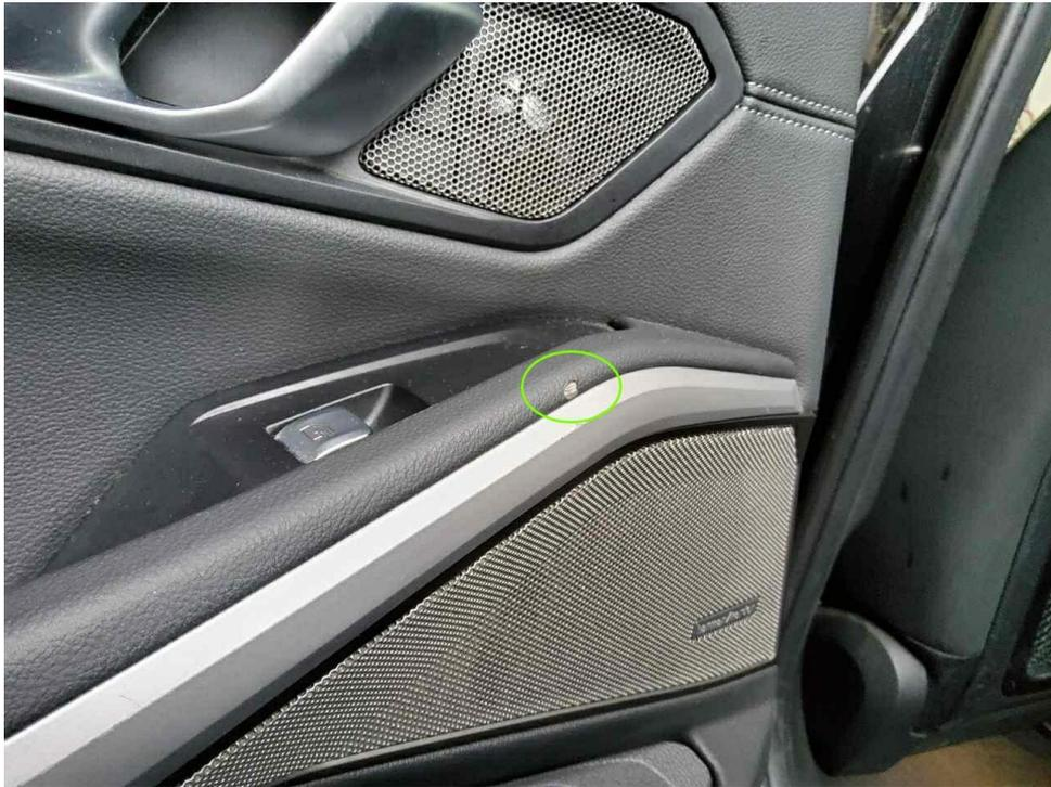
Bild 31 : Türverkleidung hinten links, eingerissen
