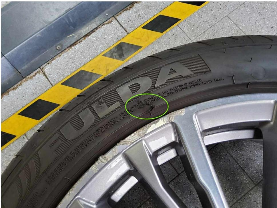
Bild 26 : Sommerreifen hinten links, Außenflanke eingeschnitten
