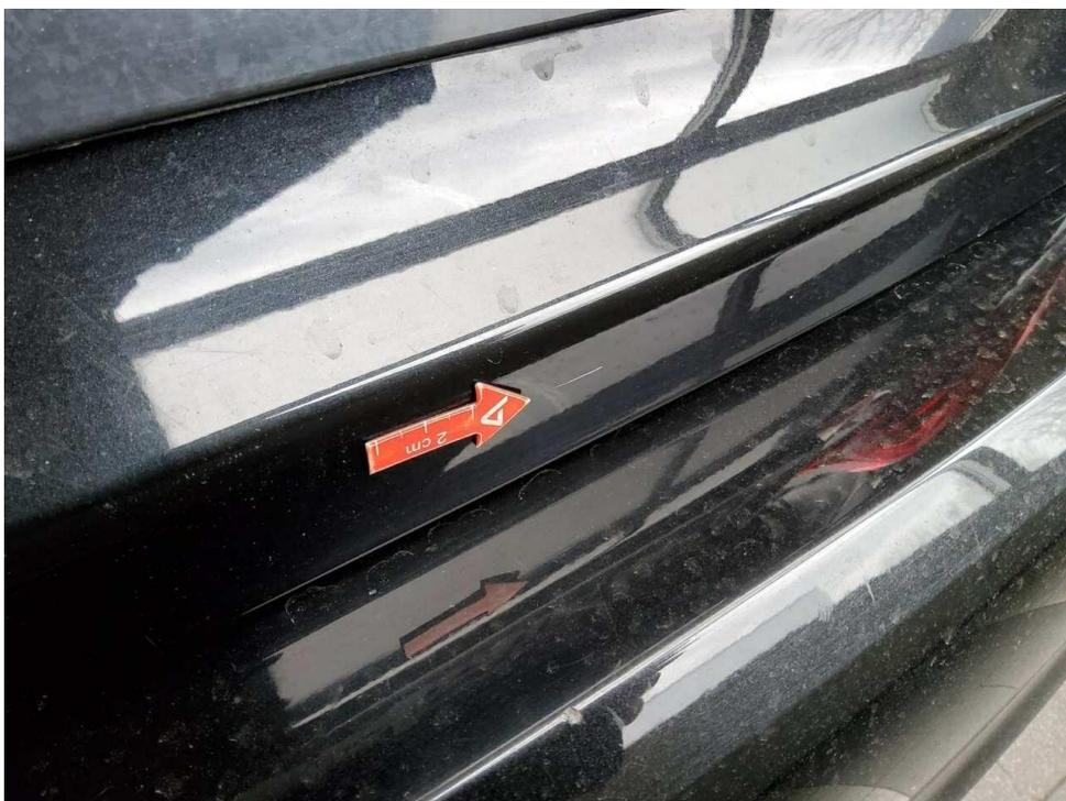
Bild 16 : Heckklappe Lackierung, zerkratzt, Gebrauchsspur unten
