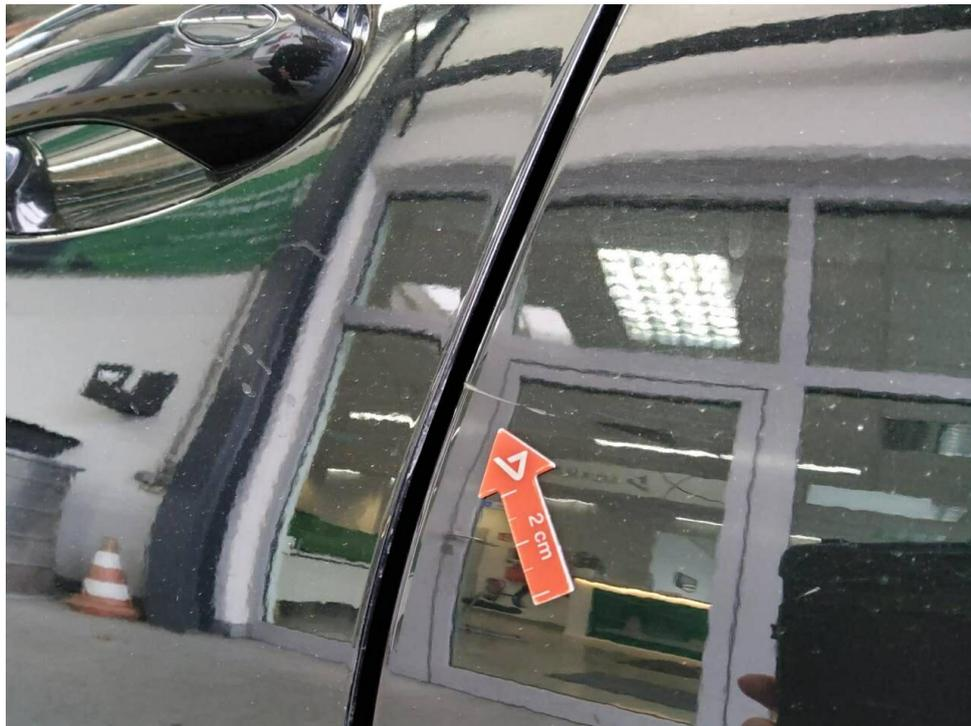
Bild 19 : Tür hinten links Lackierung, zerkratzt, lackieren
