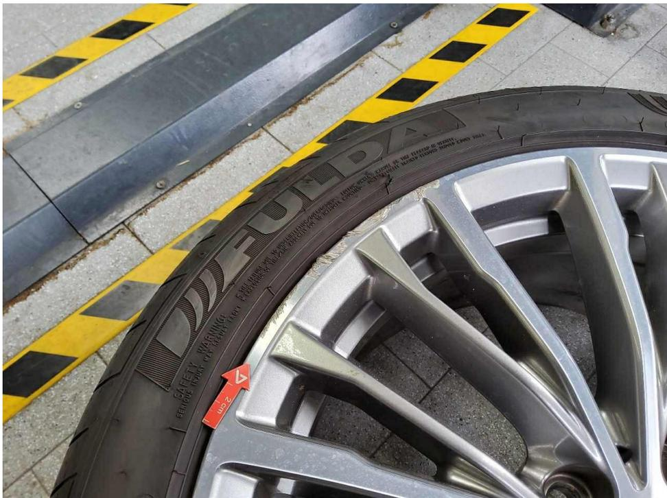
Bild 28 : Glanzgedrehte Felge hinten links, zerkratzt
