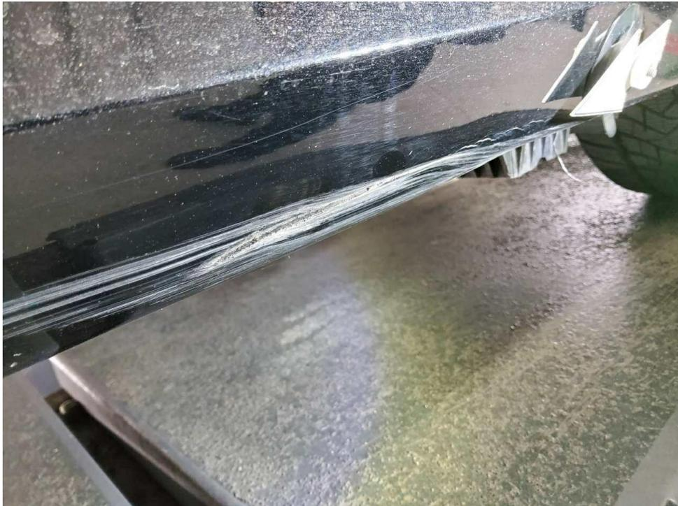
Bild 25 : Schwellerverkleidung links, gerissen
