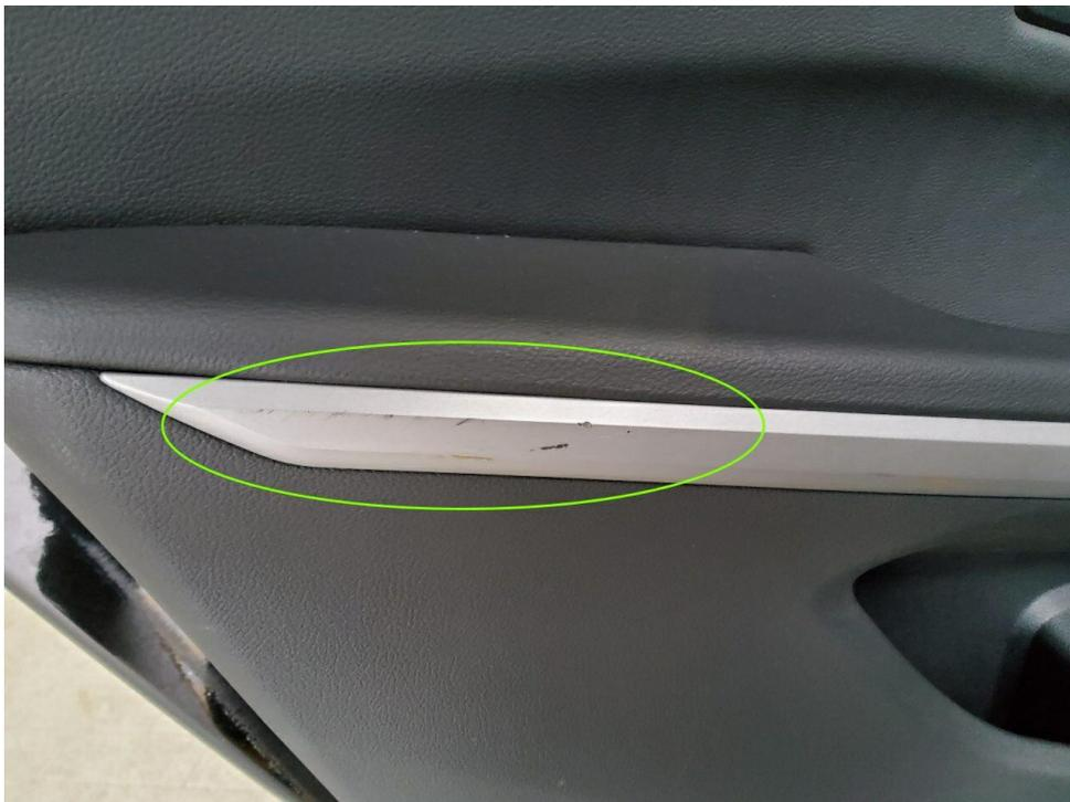
Bild 32 : Tür hinten links, Interieurleiste, zerkratzt
