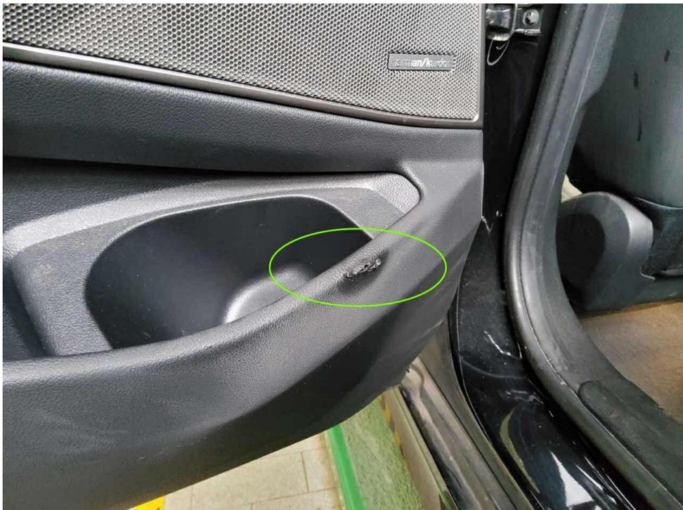
Bild 30 : Türverkleidung hinten links, eingerissen
