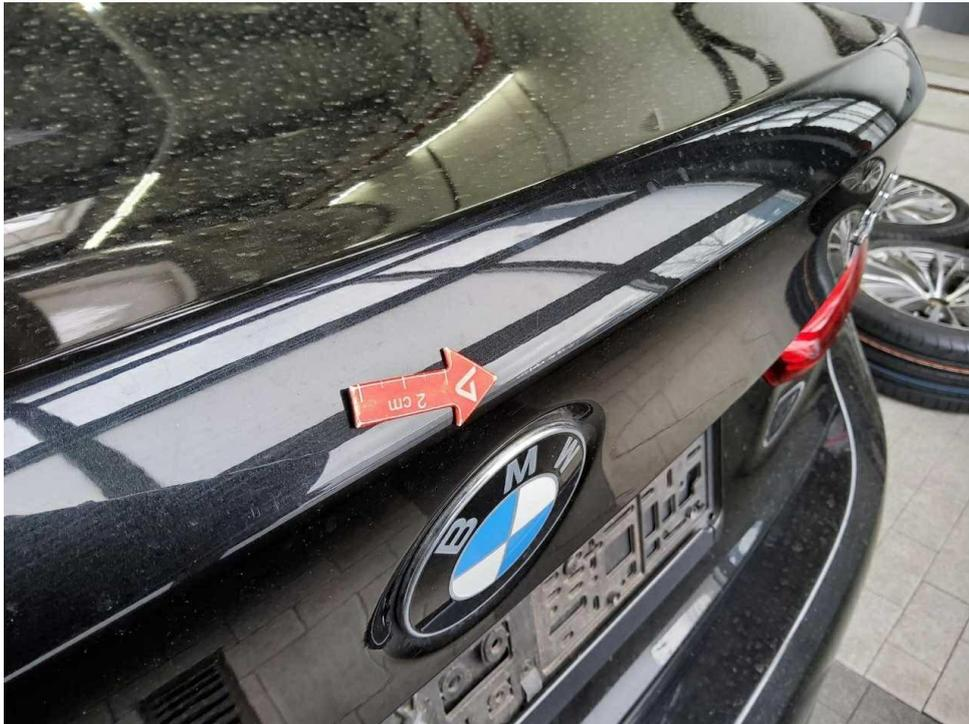
Bild 15 : Heckklappe Lackierung, zerkratzt, Gebrauchsspur oben
