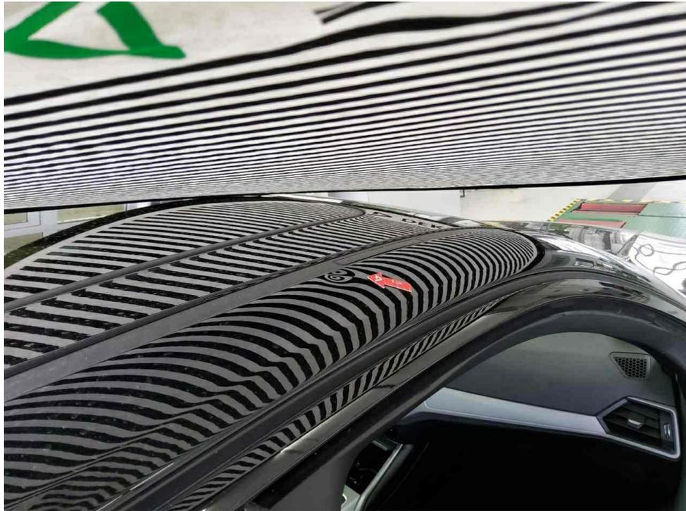
Bild 17 : Dachrahmen rechts, deformiert, instandsetzen und lackieren mit Lackaufbau
