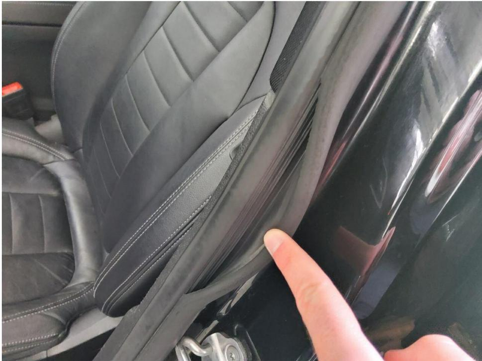
Bild 33 : Türdichtung vorne links, gerissen
