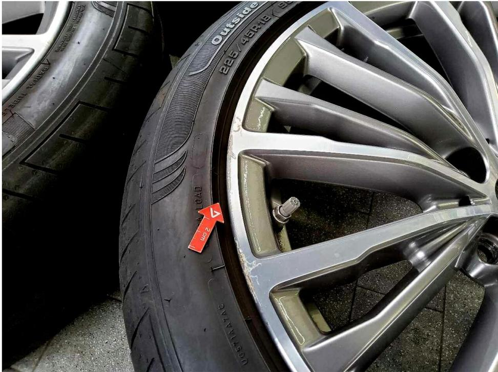
Bild 29 : Glanzgedrehte Felge hinten rechts, zerkratzt
