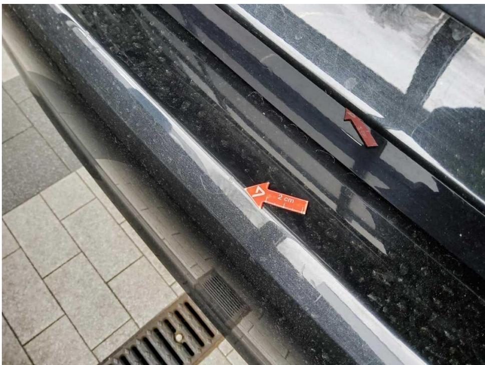
Bild 22 : Stoßfänger hinten Lackierung, zerkratzt, Gebrauchsspur
