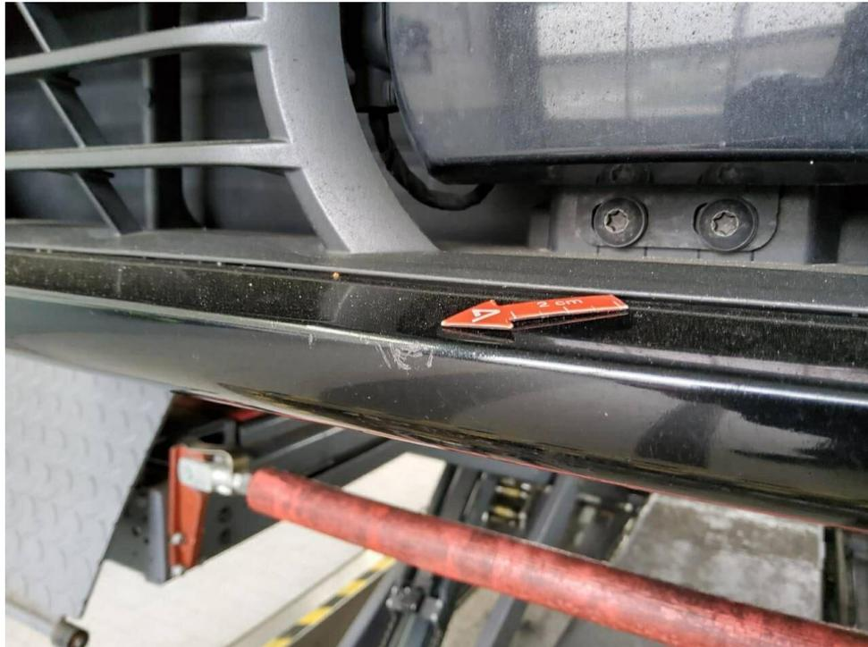
Bild 23 : Stoßfänger vorne Lackierung, zerkratzt, lackieren mit Lackaufbau unten, mittig
