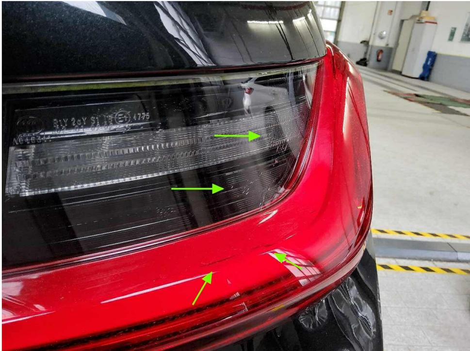
Bild 35 : T - Heckleuchte rechts (außen), rissig
