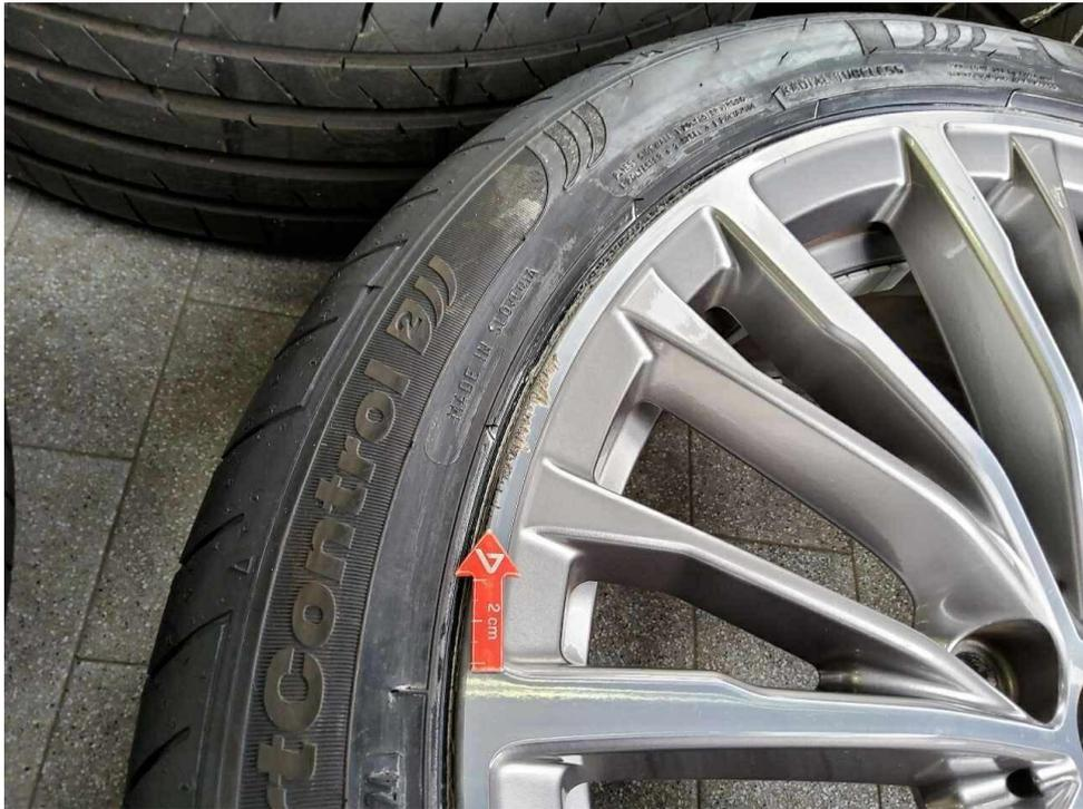
Bild 27 : Glanzgedrehte Felge vorne rechts, zerkratzt
