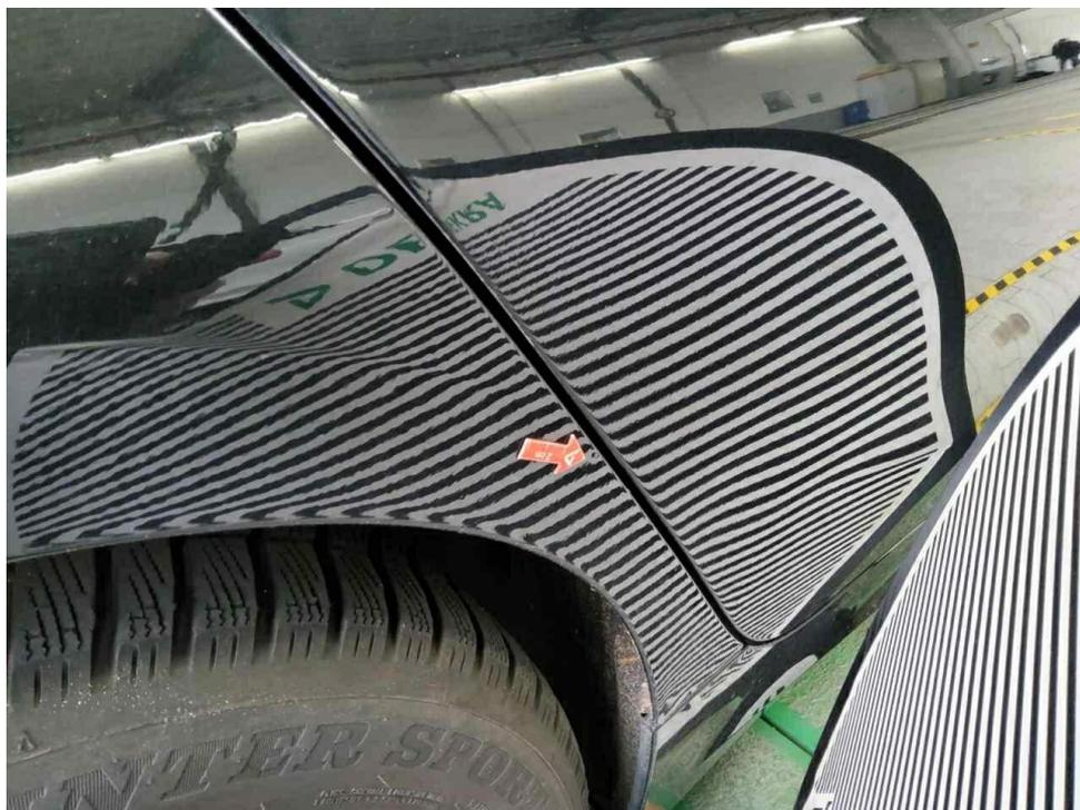
Bild 20 : Seitenteil hinten rechts, eingedellt, Gebrauchsspur
