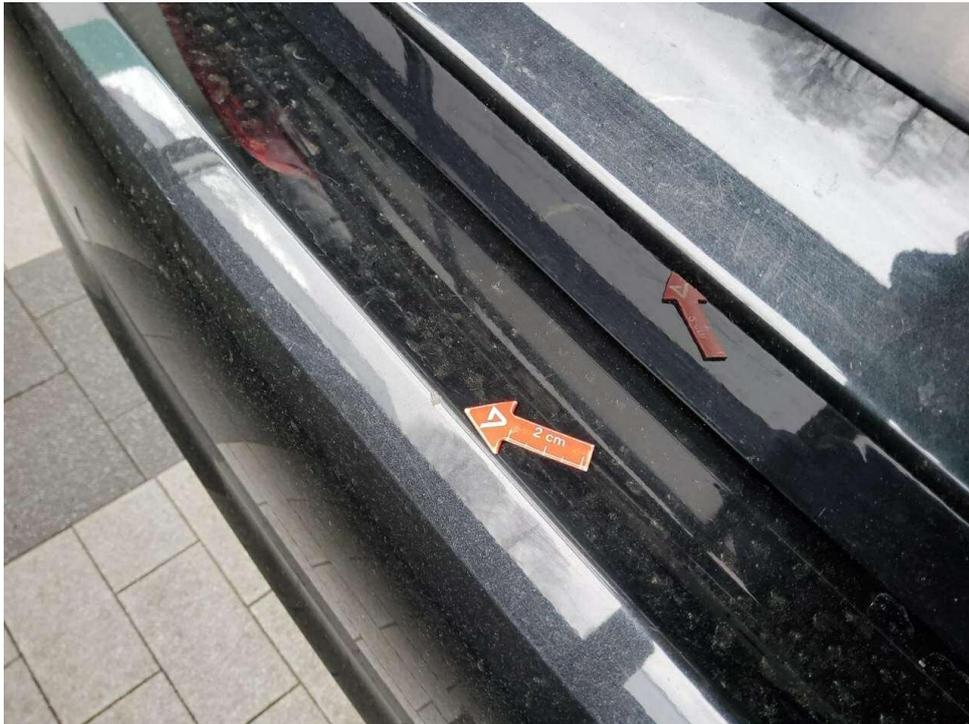
Bild 21 : Stoßfänger hinten Lackierung, zerkratzt, Gebrauchsspur
