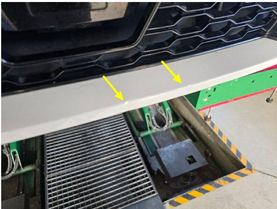
Bild 18 : Stoßfänger vorne, mehrfach eingedellt, instandsetzen und lackieren mit Lackaufbau
