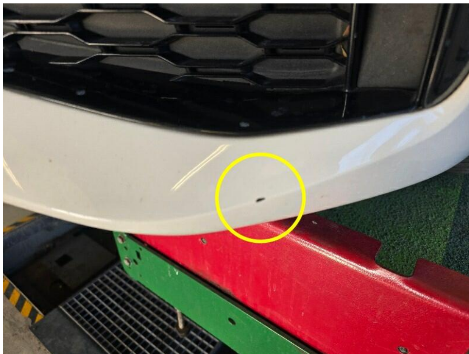
Bild 19 : Stoßfänger vorne, mehrfach eingedellt, instandsetzen und lackieren mit Lackaufbau
