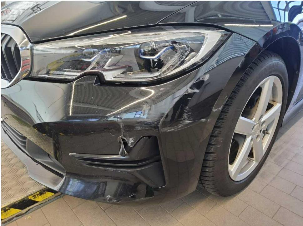
Bild 19 : Schaden vorne (Stoßfänger,Scheinwerfer)
