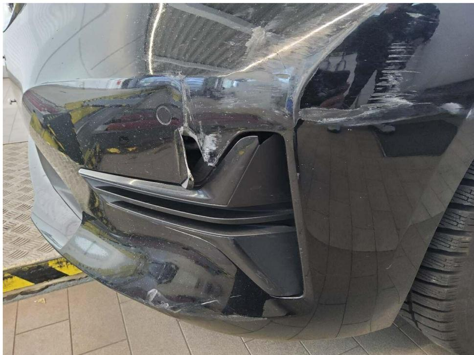
Bild 21 : Schaden vorne (Stoßfänger,Scheinwerfer)
