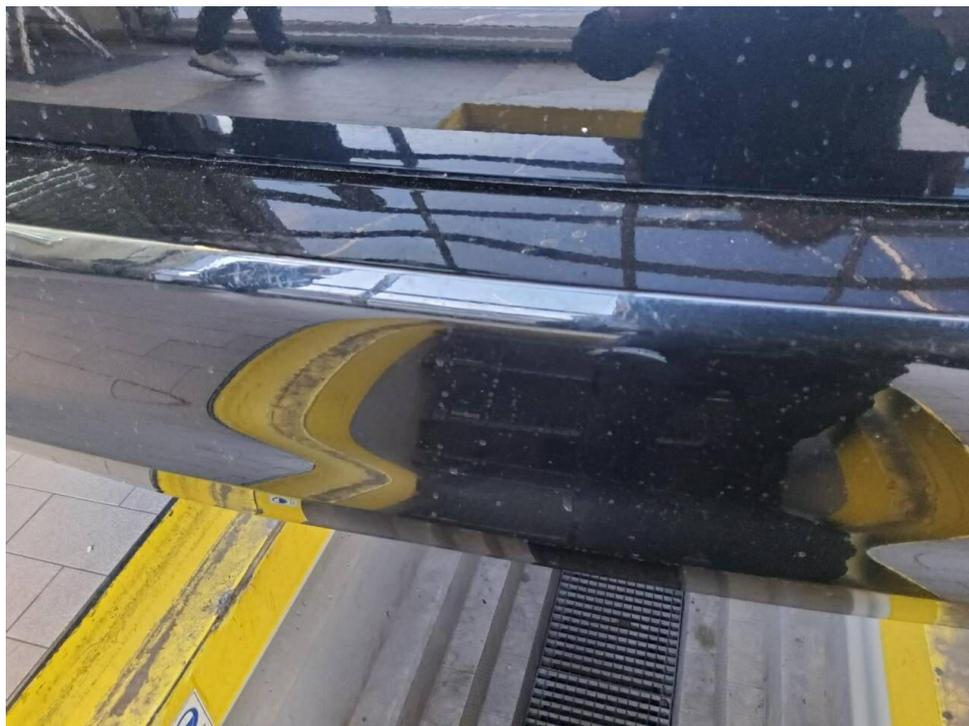
Bild 23 : Stoßfänger hinten Lackierung, verschrämmt, Gebrauchsspur
