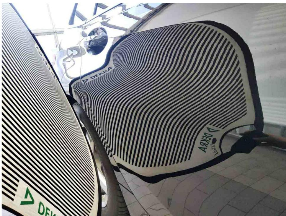
Bild 24 : Tür hinten rechts, mehrfach eingedellt, Gebrauchsspur
