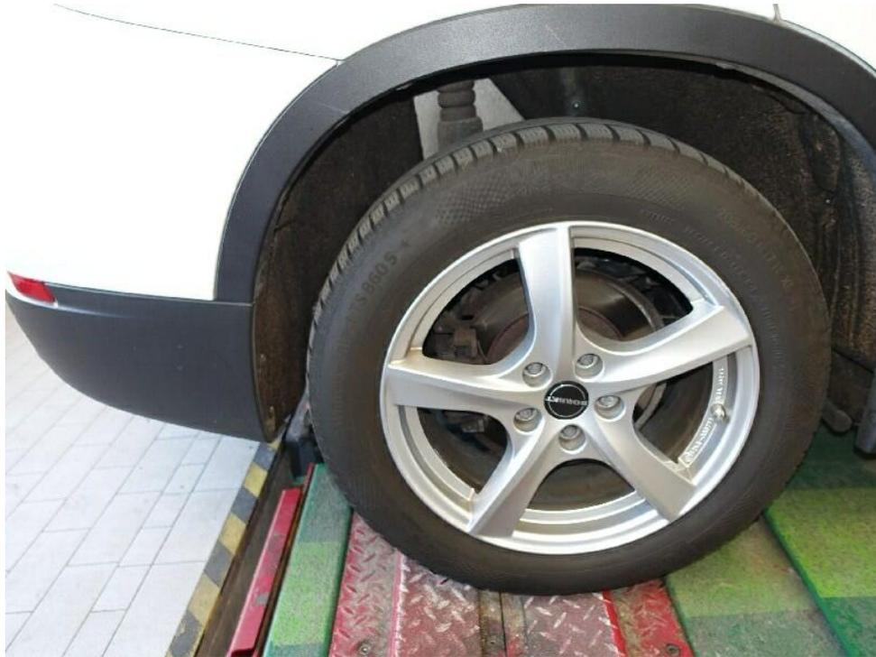
Bild 25 : Bereifung auf Achse 2. unterschiedliche Hersteller
