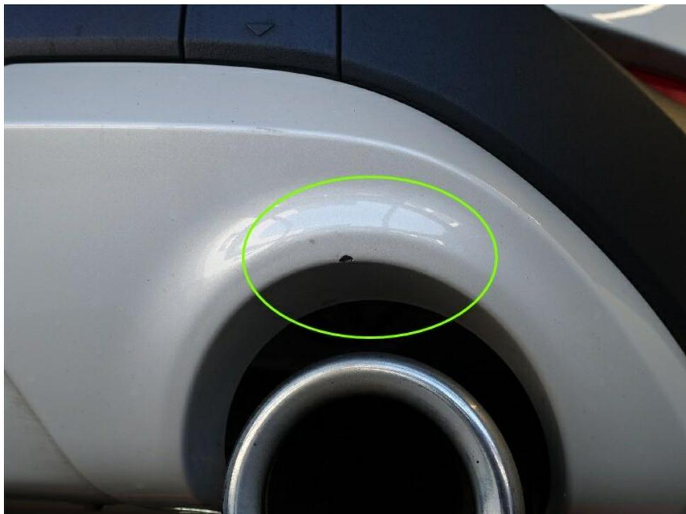
Bild 21 : Heckschürze hinten unten Lackierung, zerkratzt, lackieren
