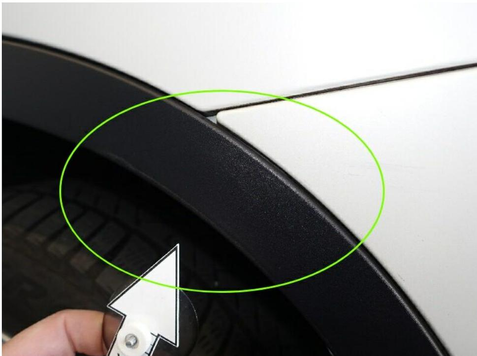
Bild 18 : Radlaufblende hinten links Schrammspur
