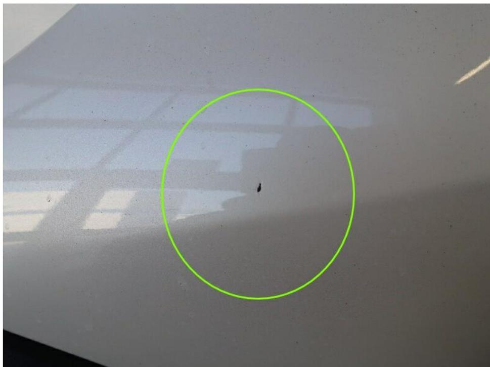
Bild 16 : Stoßfänger hinten Lackierung, verschrammt, lackieren
