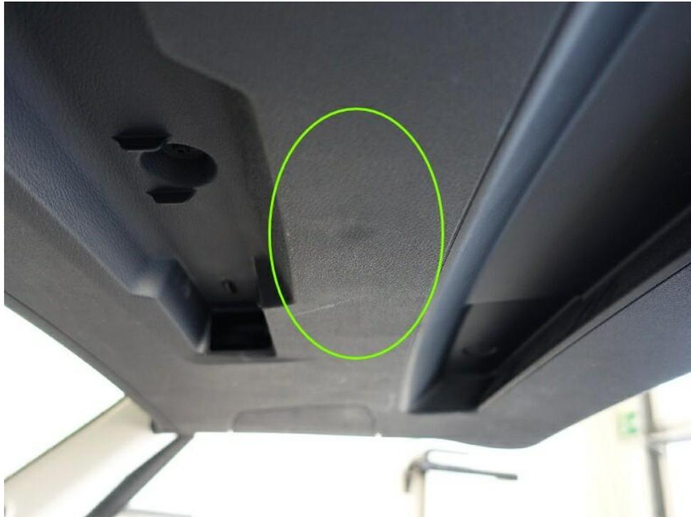
Bild 13 : Kofferraumverkleidung hinten verformt
