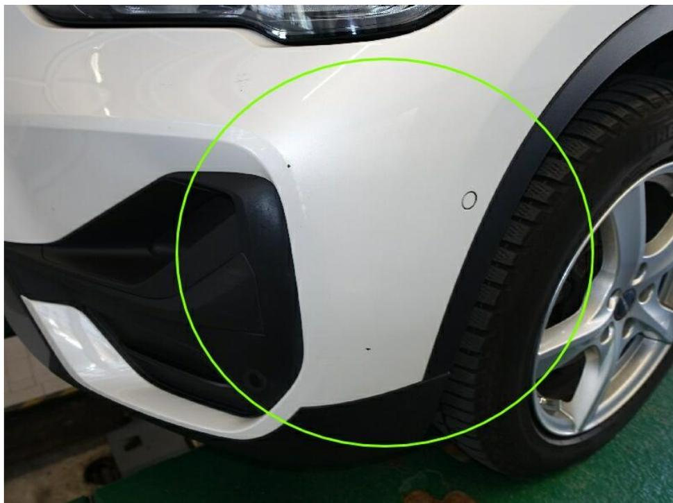
Bild 22 : Stoßfänger vorne Lackierung, zerkratzt, lackieren
