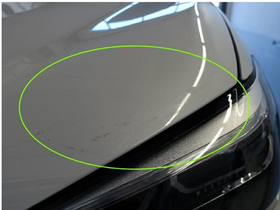
Bild 24 : Motorhaube Lackierung, Umweltschaden, polieren
