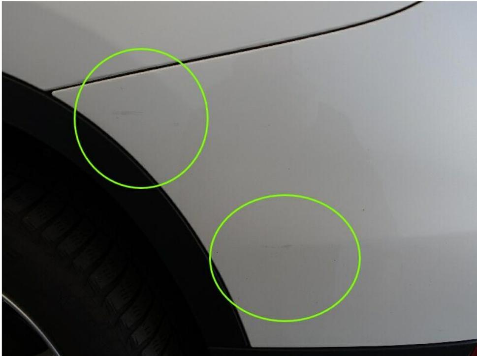
Bild 17 : Stoßfänger hinten Lackierung, verschrammt, lackieren
