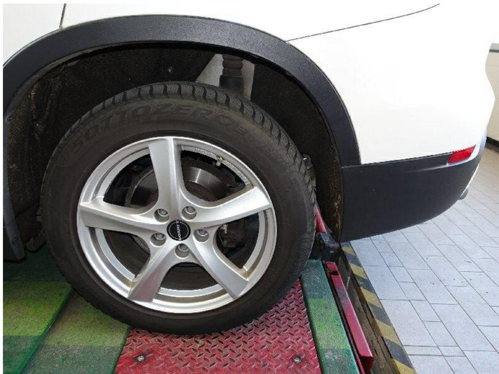
Bild 26 : Bereifung auf Achse 2. unterschiedliche Hersteller
