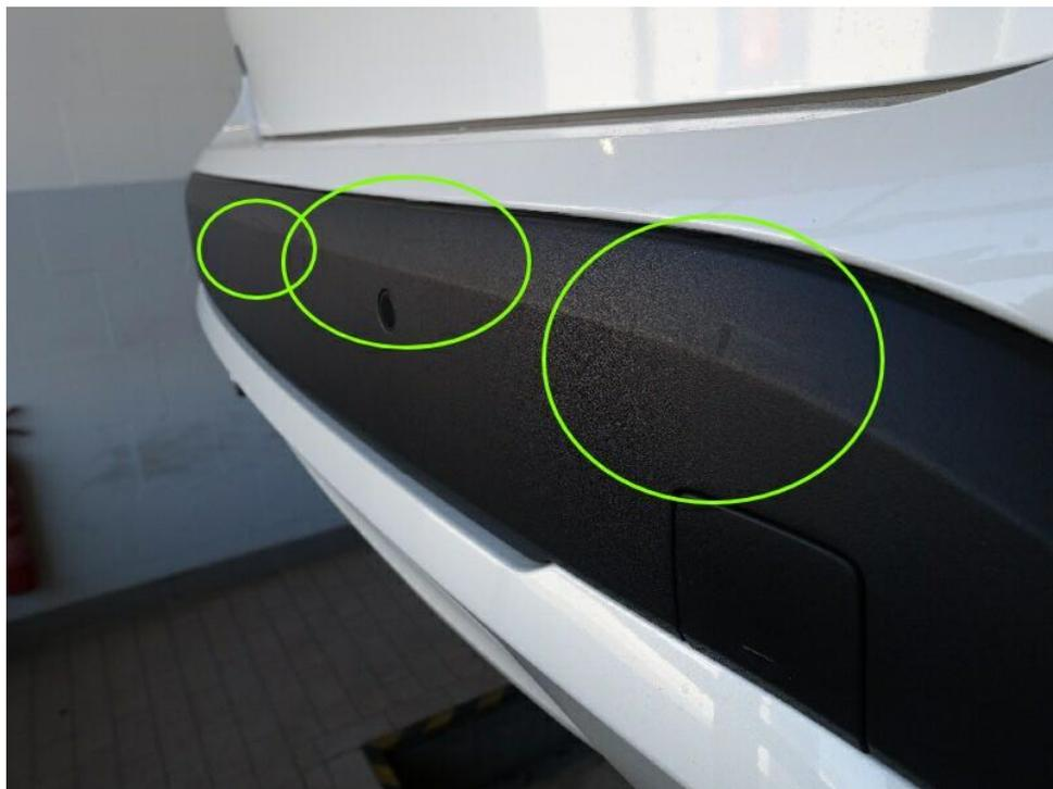
Bild 19 : Stoßfängermittelstück hinten Schrammspuren
