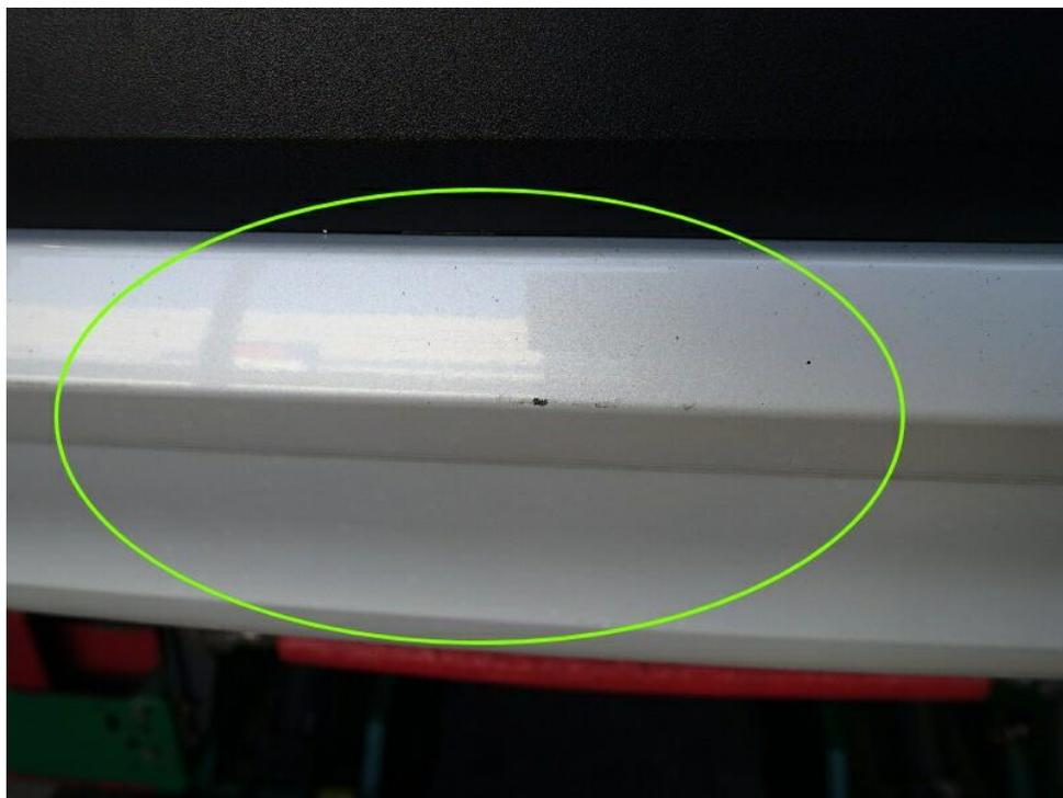
Bild 20 : Heckschürze hinten unten Lackierung, zerkratzt, lackieren
