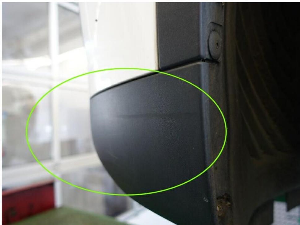
Bild 23 : Stoßfängerspoiler vorn unten links Schrammspur
