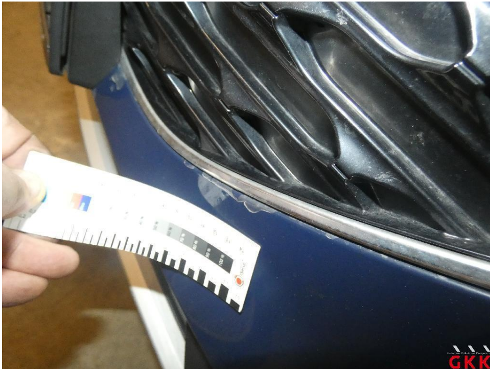
Bild 25 Stoßfänger vorne, Verkleidung -lackiert-, Lackierung abgeplatzt, lackieren
