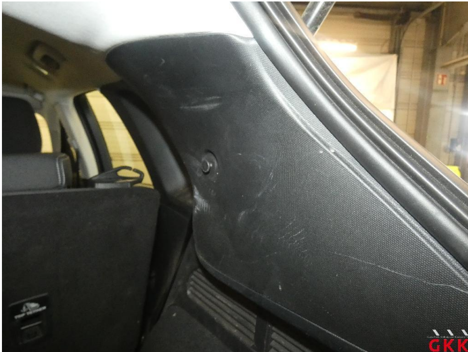
Bild 17 Laderaum, Abdeckung, fehlt, ersetzen
