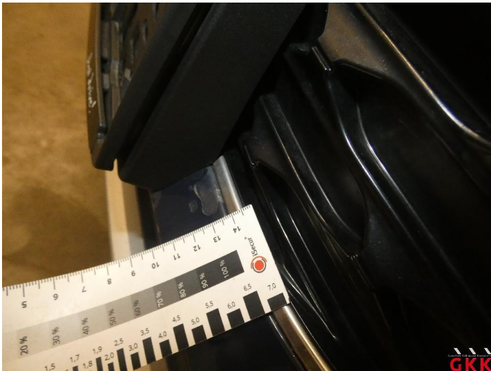
Bild 26 Stoßfänger vorne, Verkleidung -lackiert-, Lackierung abgeplatzt, lackieren
