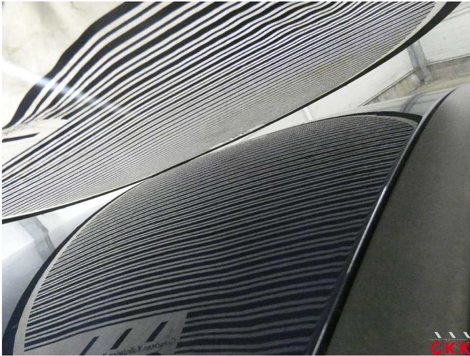
Bild 41 Fahrzeug, Hagelschaden, kalt drücken
