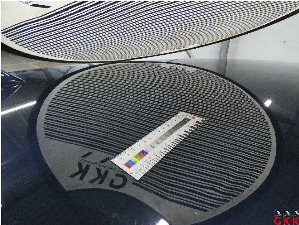
Bild 39 Fahrzeug, Hagelschaden, kalt drücken
