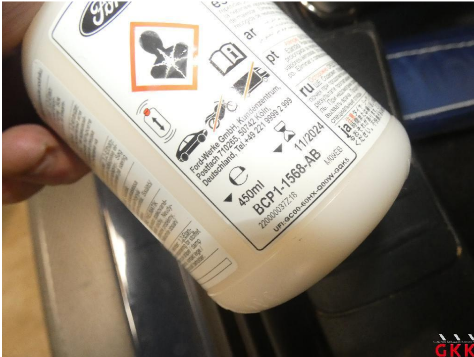
Bild 23 Reifenreparaturset, Füllflasche, MHD überschritten, ersetzen
