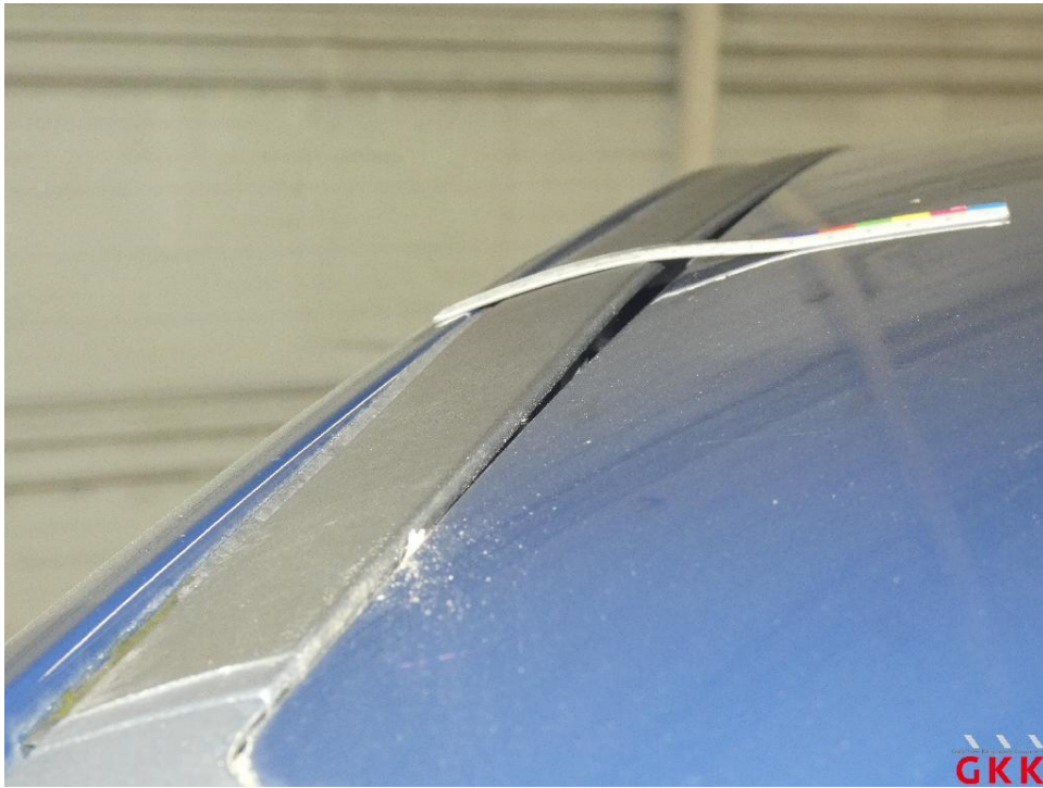
Bild 37 Fahrzeug, Hagelschaden, kalt drücken
