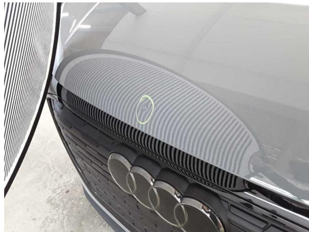
**Beschädigung #3:** Motorhaube: Motorhaube - Delle /
