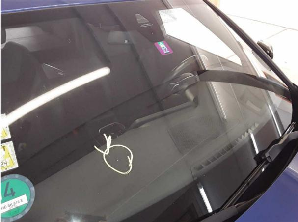
**Domage #1:** Vitrage: Pare-brise (Rissbildung) - Dommage causé par des cailloux - Remplacer
