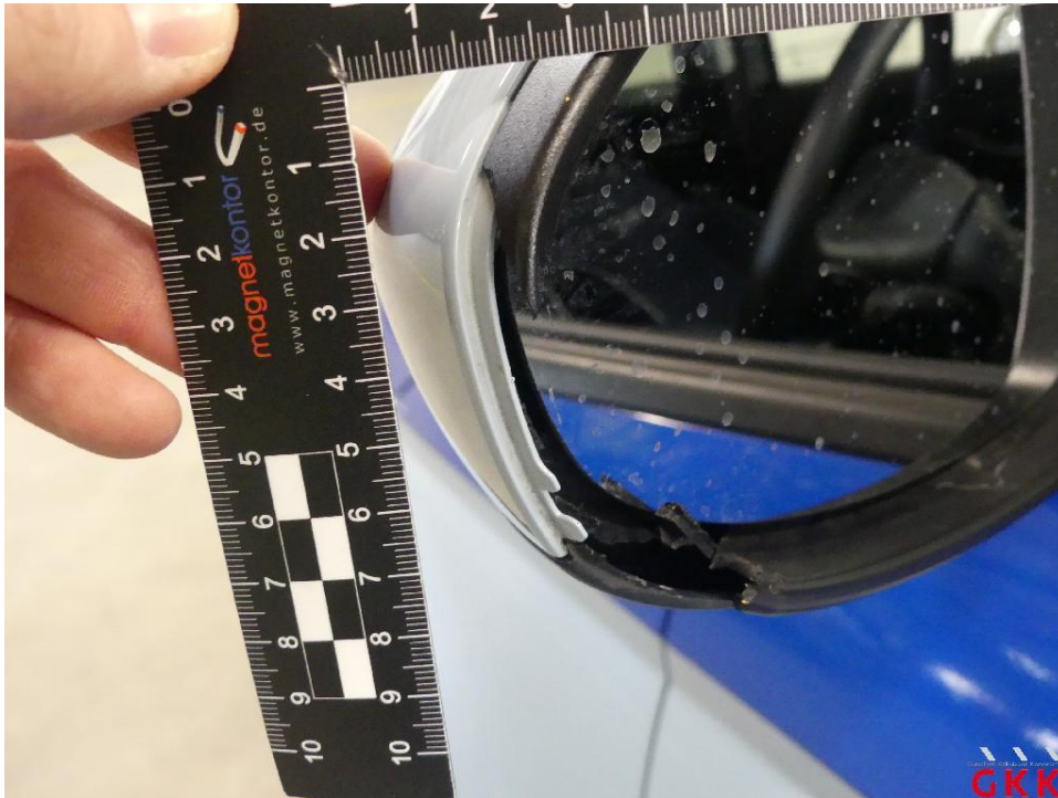
Bild 17 Spiegelgehäuse links, Rahmen, gerissen, ersetzen
