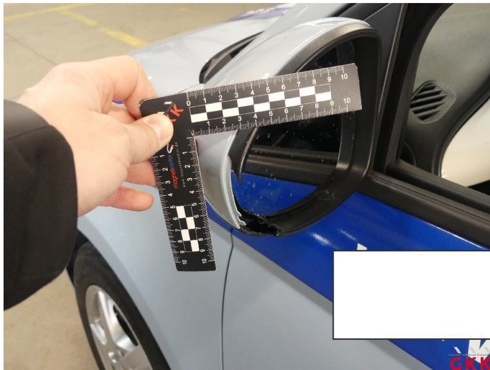
Bild 16 Spiegelgehäuse links, Rahmen, gerissen, ersetzen
