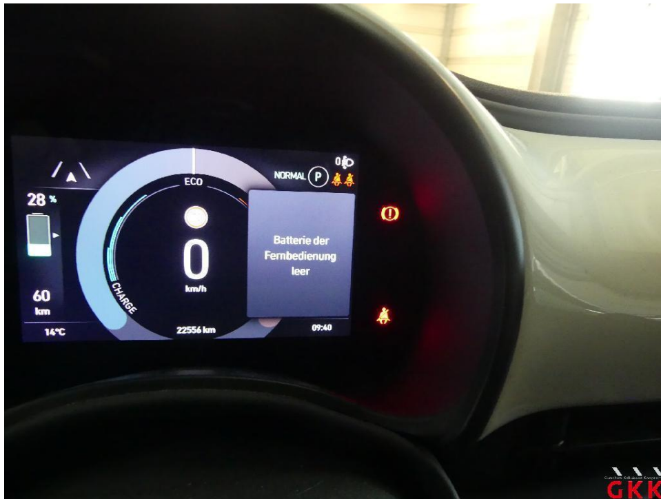
Bild 15 Hauptschlüssel, Batterie, entladen, ersetzen
