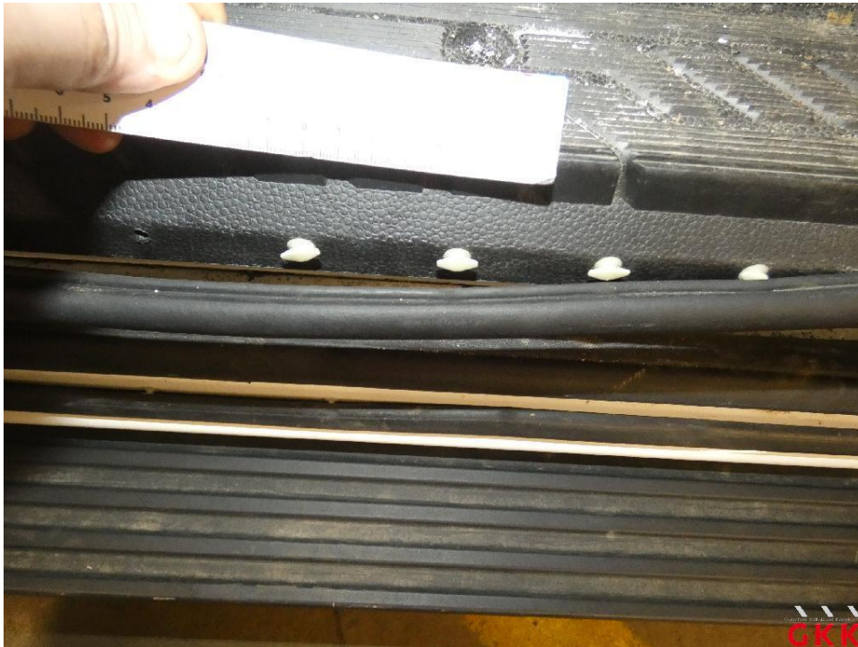
Bild 21 Schiebetür rechts, Dichtung -Einstieg-, beschädigt, ersetzen
