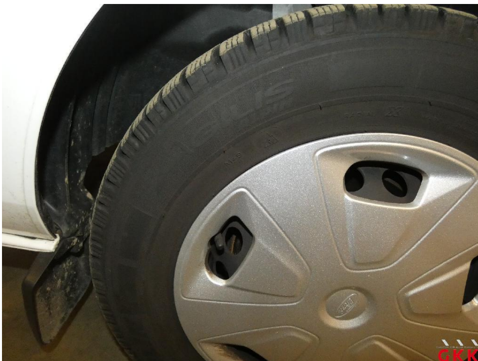
Bild 14 Reifen, vorn links und rechts, falsche Reifenart, ersetzen
