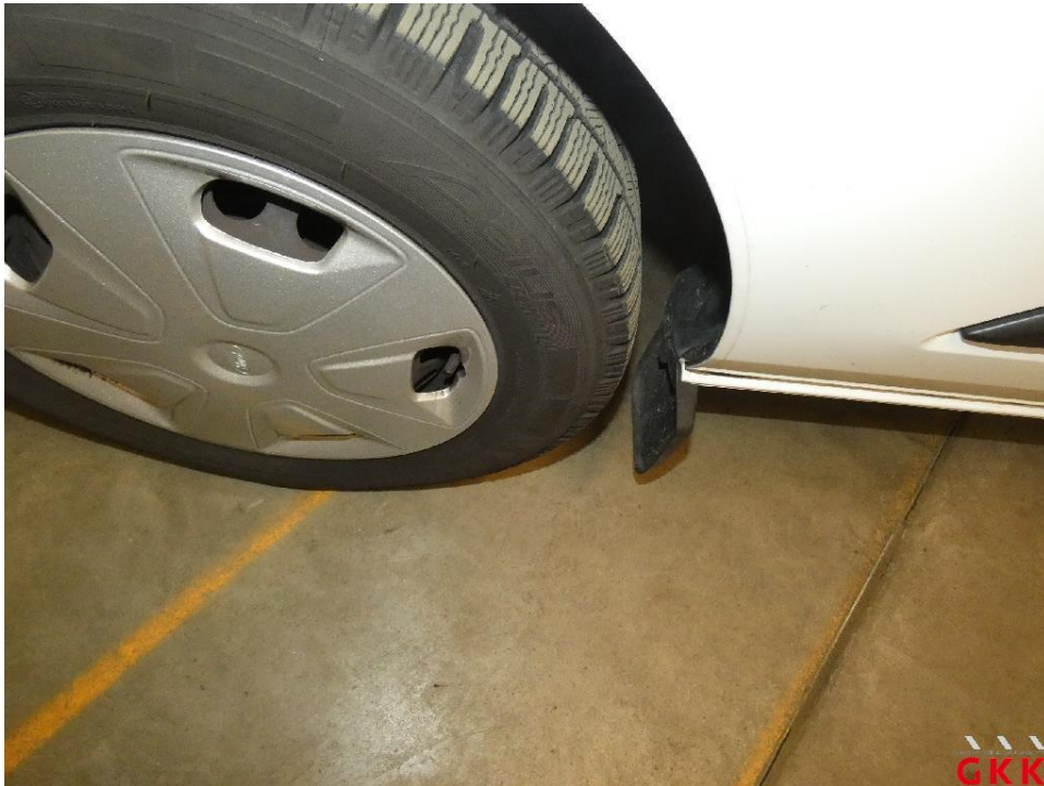
Bild 15 Reifen, vorn links und rechts, falsche Reifenart, ersetzen
