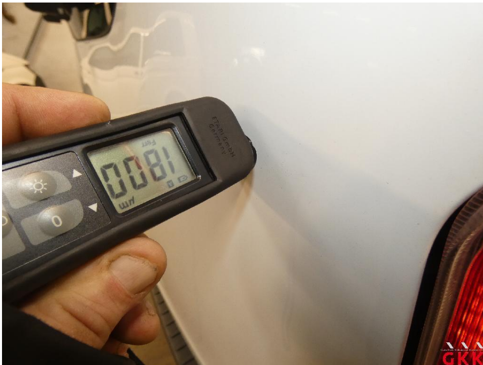
Bild 16 Hecktür rechts, Reparaturmangel, instand setzen - lackieren
