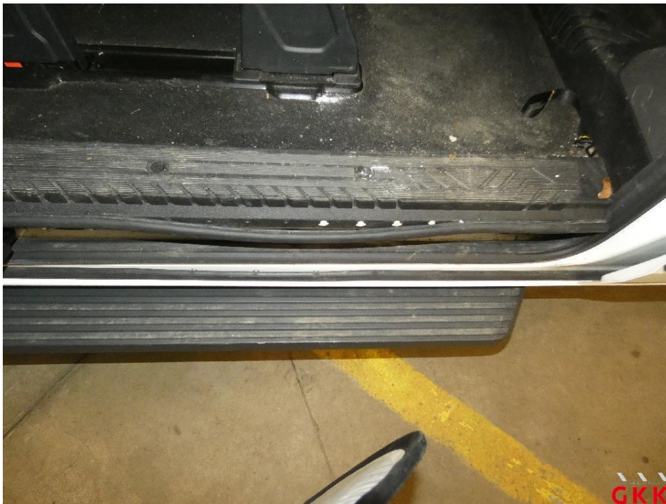
Bild 20 Schiebetür rechts, Dichtung -Einstieg-, beschädigt, ersetzen
