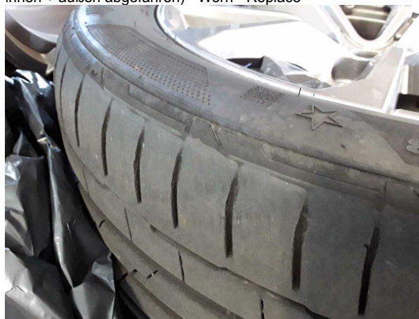
Damage #5: 2nd wheel set: Tyres - complete set (Sommer /innen + außen abgefahren) - Worn - Replace
