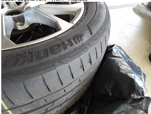
Damage #5: 2nd wheel set: Tyres - complete set (Sommer /innen + außen abgefahren) - Worn - Replace
