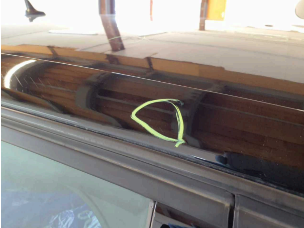
Damage #2: Toit: Rail de toit droit - Bosse, dommage peinture - Bon travail de réparation
