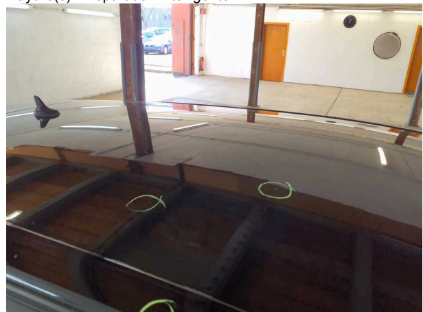
Damage #4: Toit: Toit - bosse(s) - Bon travail de réparation
