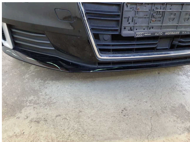
Domage #9: Pare-chocs avant: Pare-chocs avant - Eraflé - Réparer et repeindre
