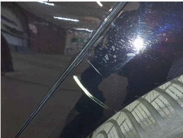
Damage #3: Panneau latéral arrière gauche: Paroi latérale - Rayure(s) - Réparation intelligente
