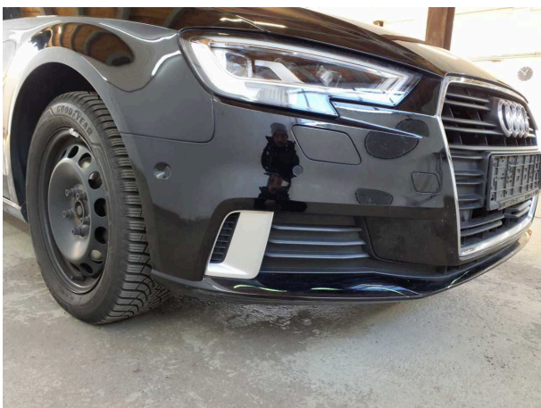
Domage #9: Pare-chocs avant: Pare-chocs avant - Erafilé - Réparer et repeindre
