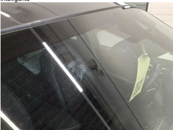
Domage #3: Vitrage: Pare-brise - Dommage causé par des cailloux - Remplacer
