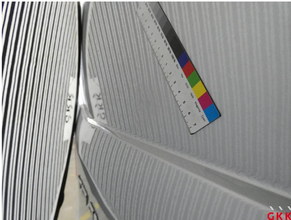
Bild 16 Hecktür links, beschädigt, instand setzen - lackieren
