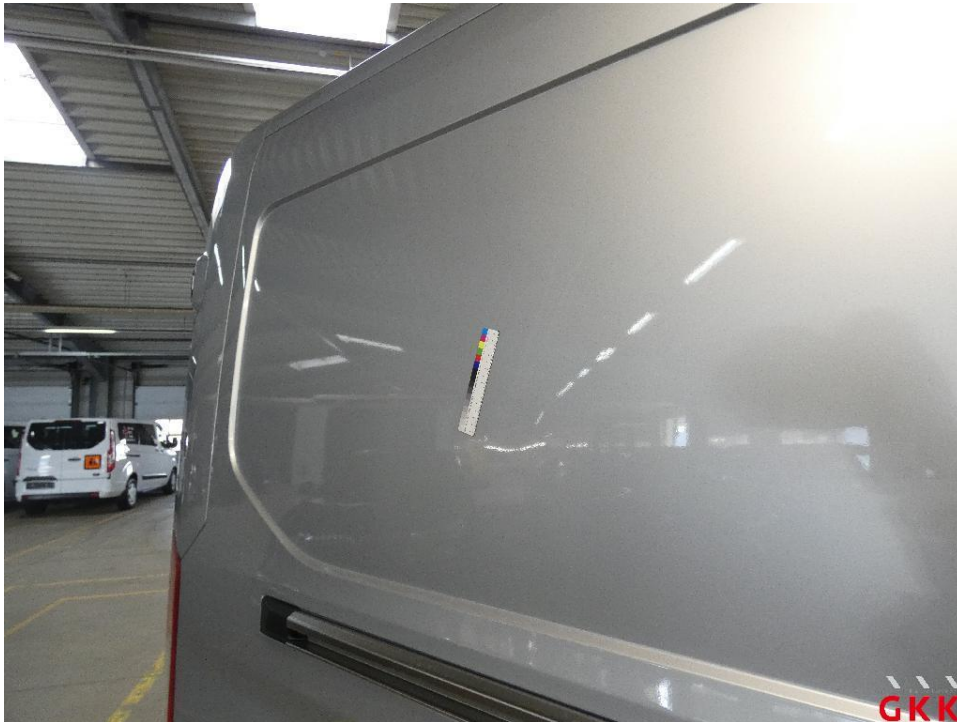
Bild 17 Seitenwand rechts, hinten -oberhalb-, beschädigt, instand setzen - lackieren
