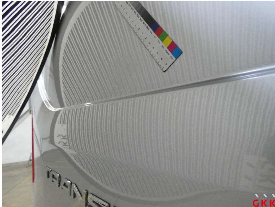
Bild 15 Hecktür links, beschädigt, instand setzen - lackieren
