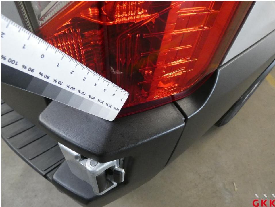
Bild 21 Rückleuchte rechts, außen, verkratzt, ersetzen
