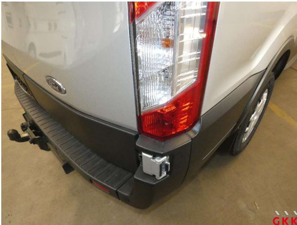
Bild 20 Rückleuchte rechts, außen, verkratzt, ersetzen
