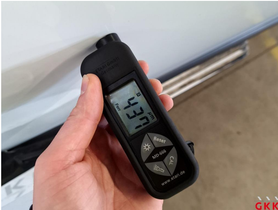
Bild 17 Schiebetür rechts, Reparaturmangel, instand setzen - lackieren
