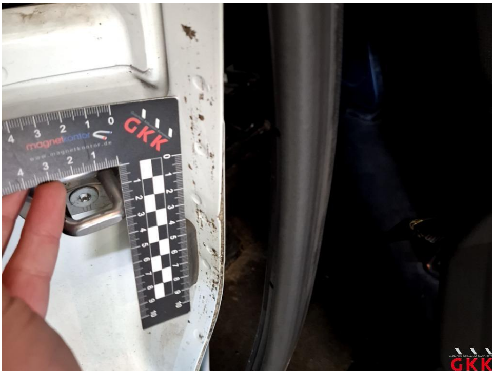
Bild 30 Schiebetür rechts, Dichtung, lose, ersetzen
