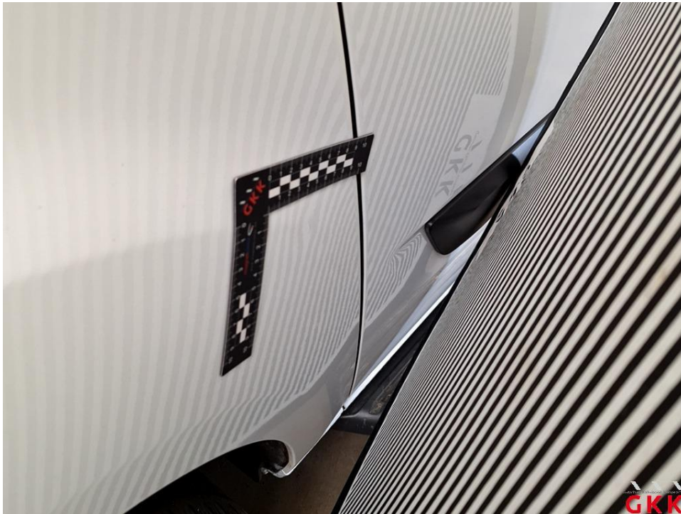
Bild 21 Seitenwand rechts, Reparaturmangel, instand setzen - lackieren
