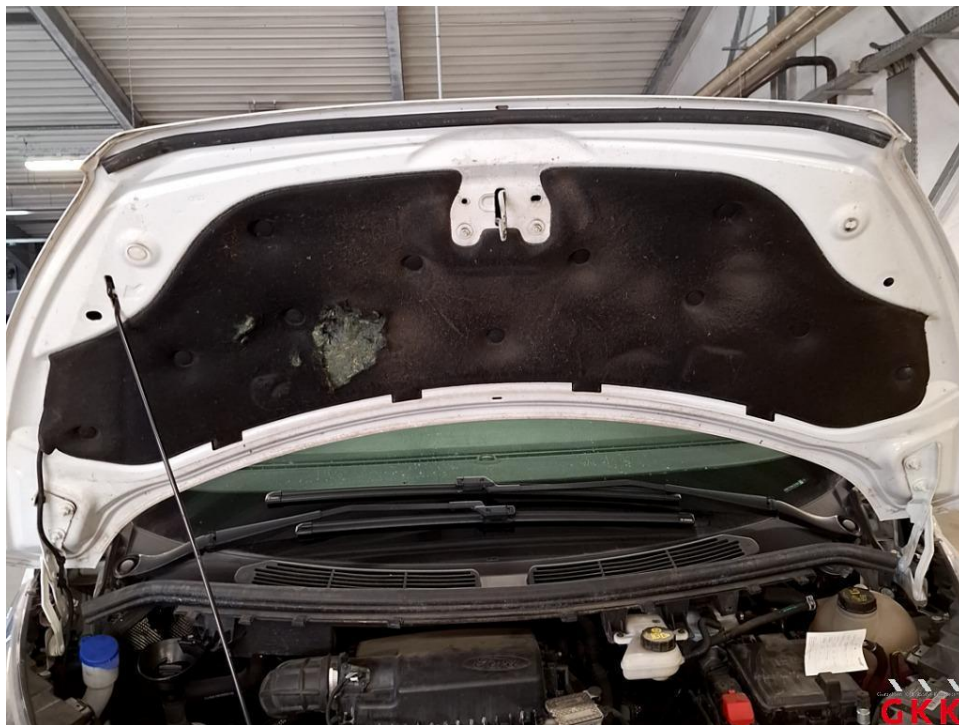
Bild 14 Motorhaube, Dämmmatte, beschädigt, ersetzen
