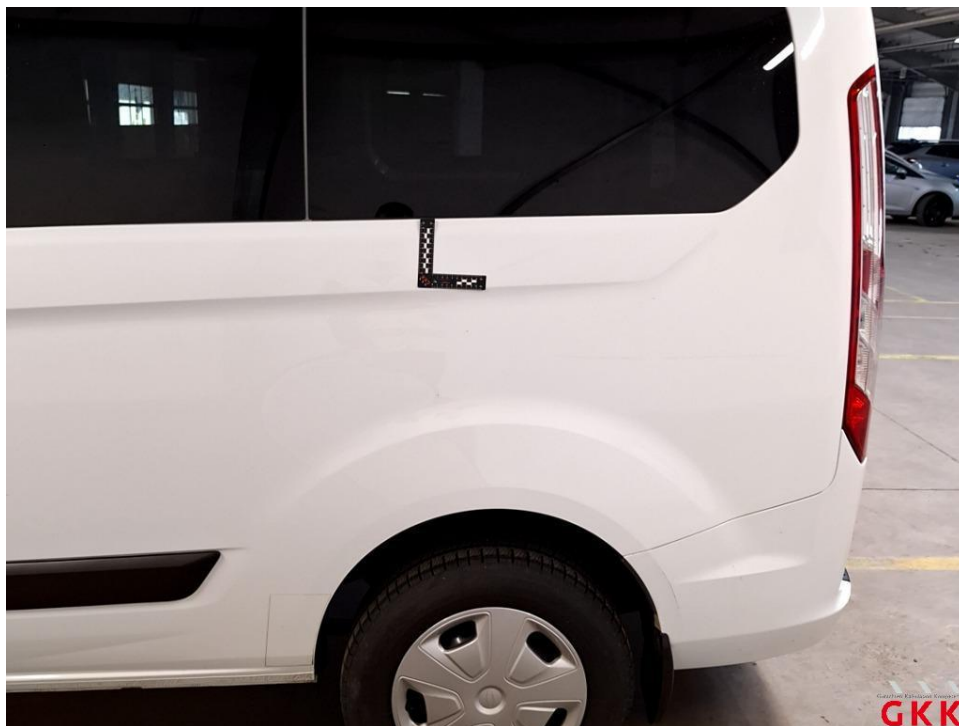
Bild 36 Seitenwand links, beschädigt, kalt drücken
