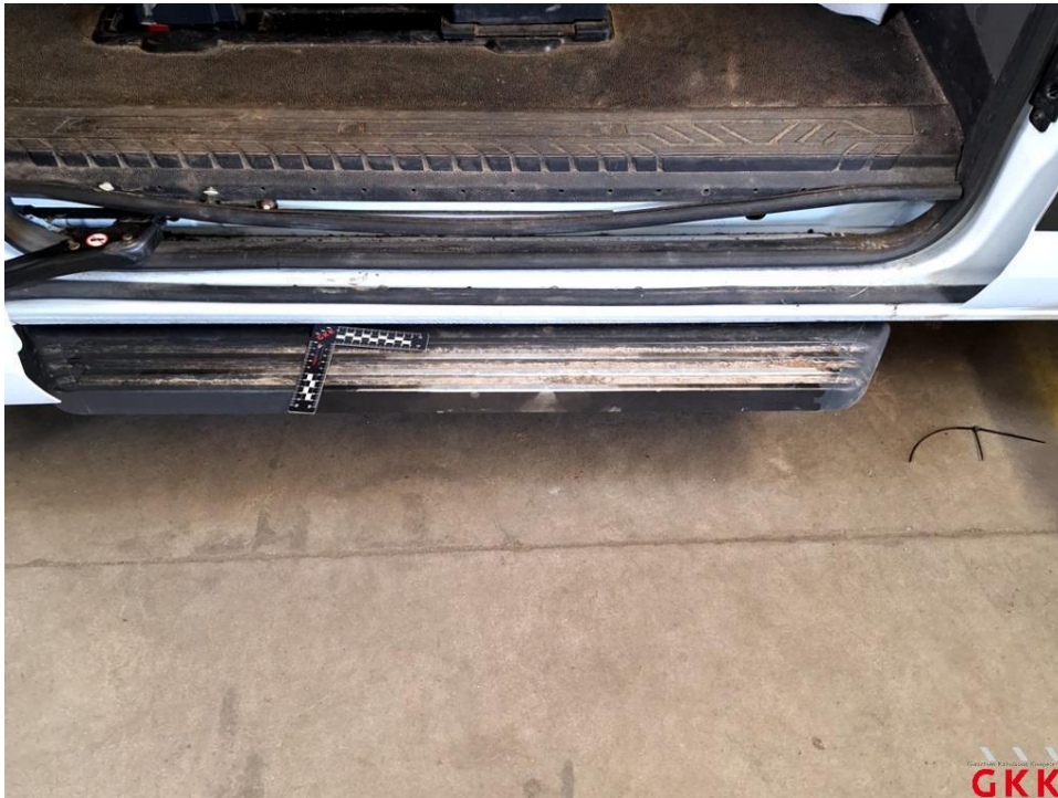
Bild 27 Trittstufe rechts, Lackierung abgeplatzt, lackieren
