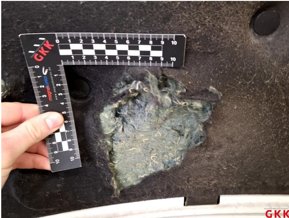
Bild 15 Motorhaube, Dämmmatte, beschädigt, ersetzen
