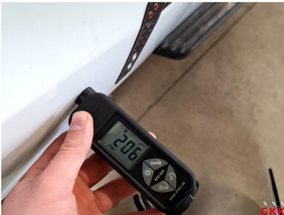
Bild 20 Seitenwand rechts, Reparaturmangel, instand setzen - lackieren
