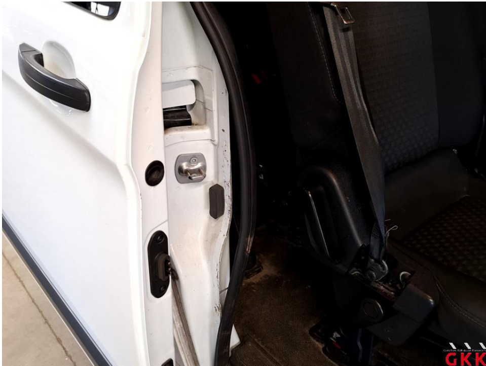
Bild 29 Schiebetür rechts, Dichtung, lose, ersetzen
