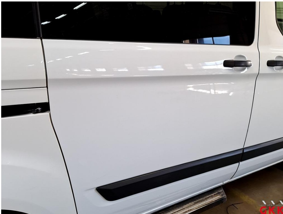
Bild 16 Schiebetür rechts, Reparaturmangel, instand setzen - lackieren
