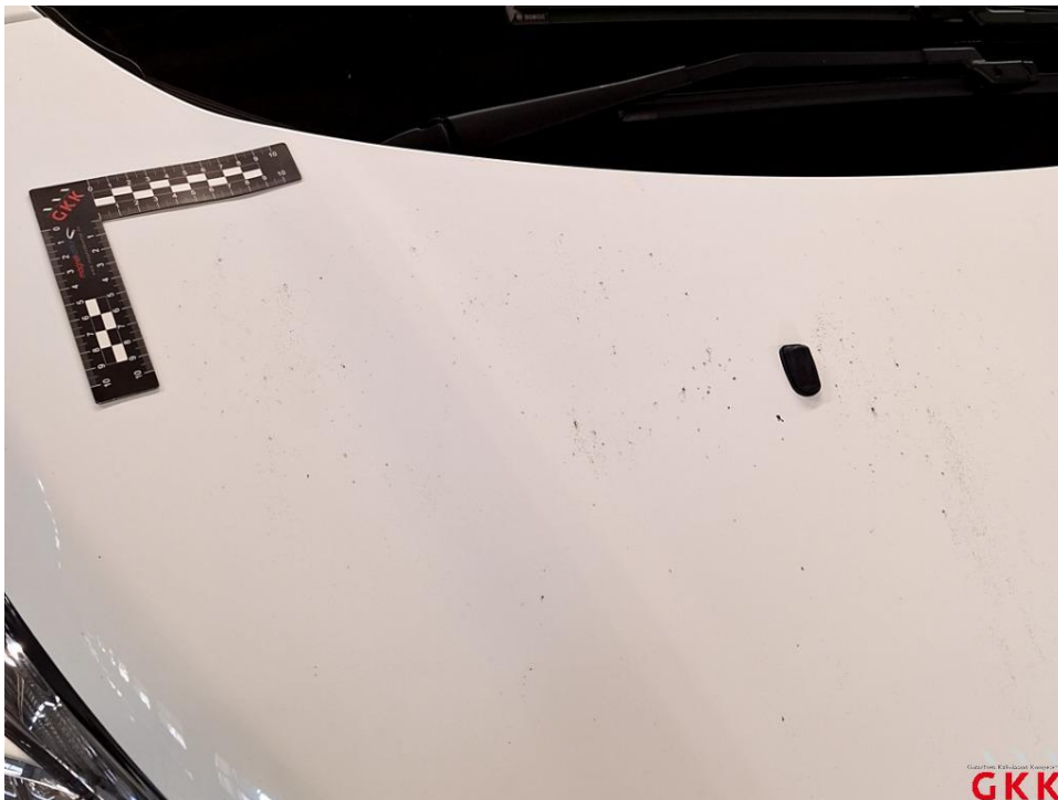
Bild 22 Fahrzeug, außen, Anhaftungsspuren, aufbereiten
