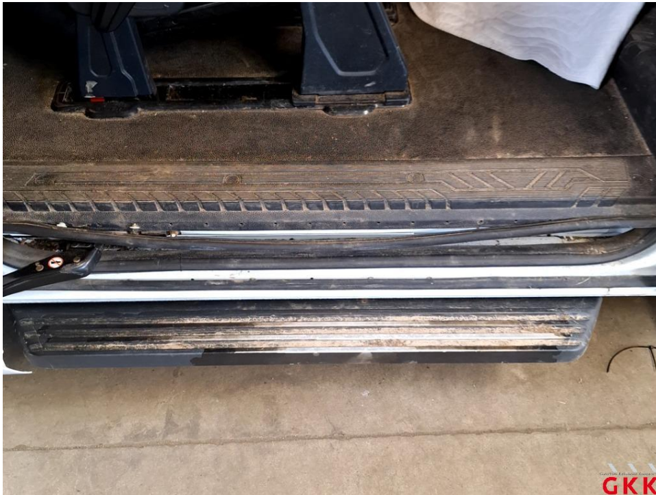
Bild 31 Schiebetür rechts, Dichtung -Einstieg-, lose, ersetzen
