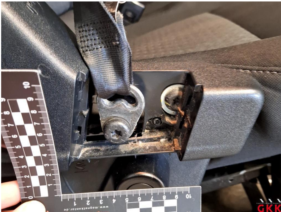
Bild 26 Sitz hinten rechts, Verkleidung, beschädigt, ersetzen
