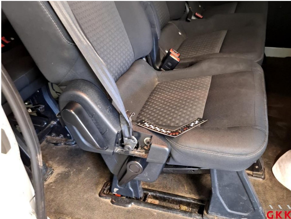
Bild 25 Sitz hinten rechts, Verkleidung, beschädigt, ersetzen
