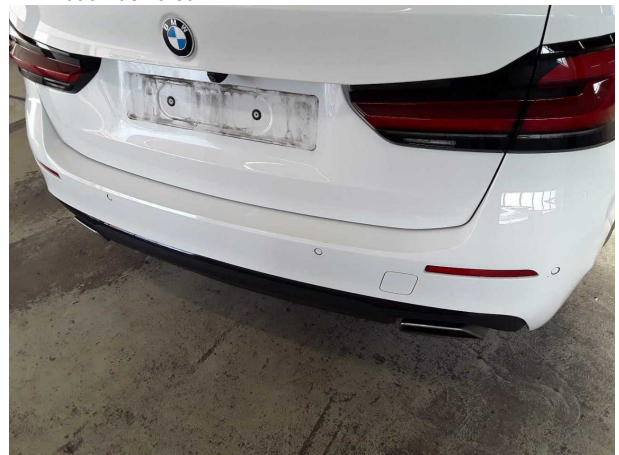
Domage #4: Pare-chocs arrière: Pare-chocs arrière - Rayure(s) - Réparation intelligente
