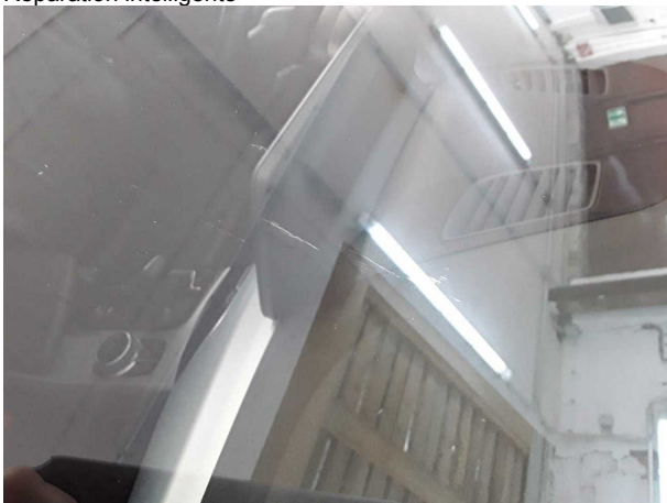
Domage #5: Vitrage: Pare-brise - Rayure(s) - Remplacer
