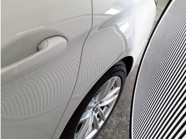
Domage #1: Panneau latéral arrière gauche: Paroi latérale - bosse(s) - Bon travail de réparation
