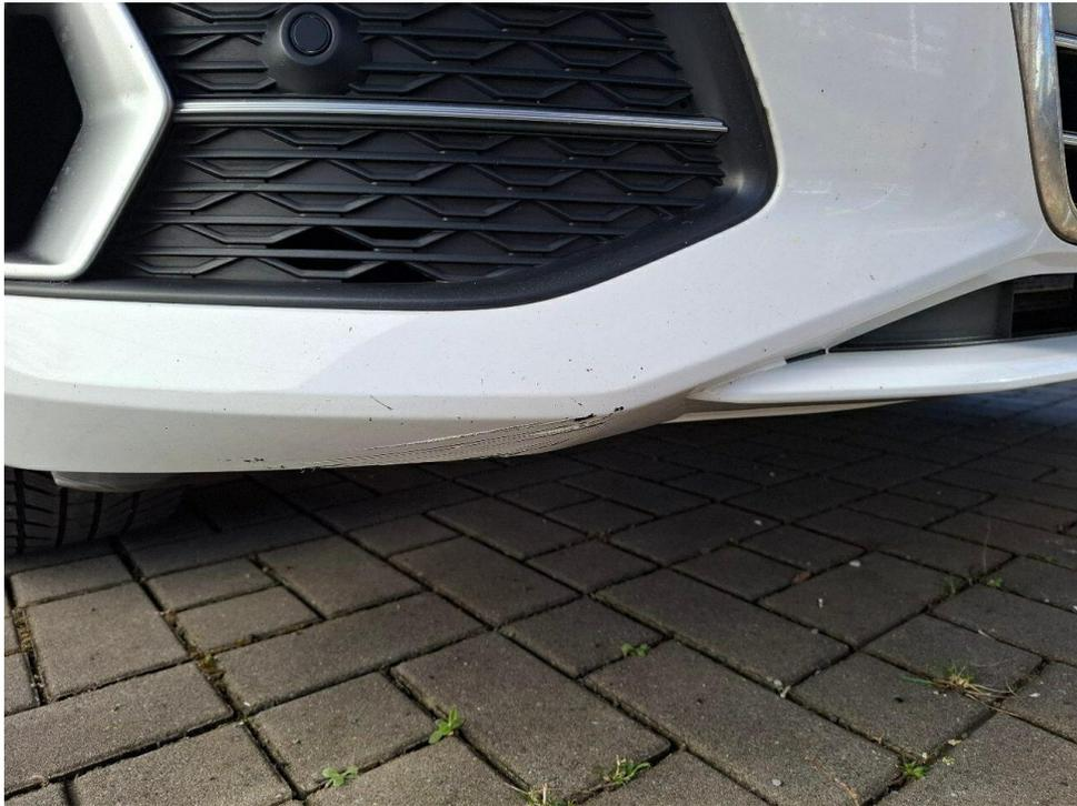
Bild 11 : Stoßfänger vorne Lackierung, viele Steinschläge, lackieren mit Lackaufbau
