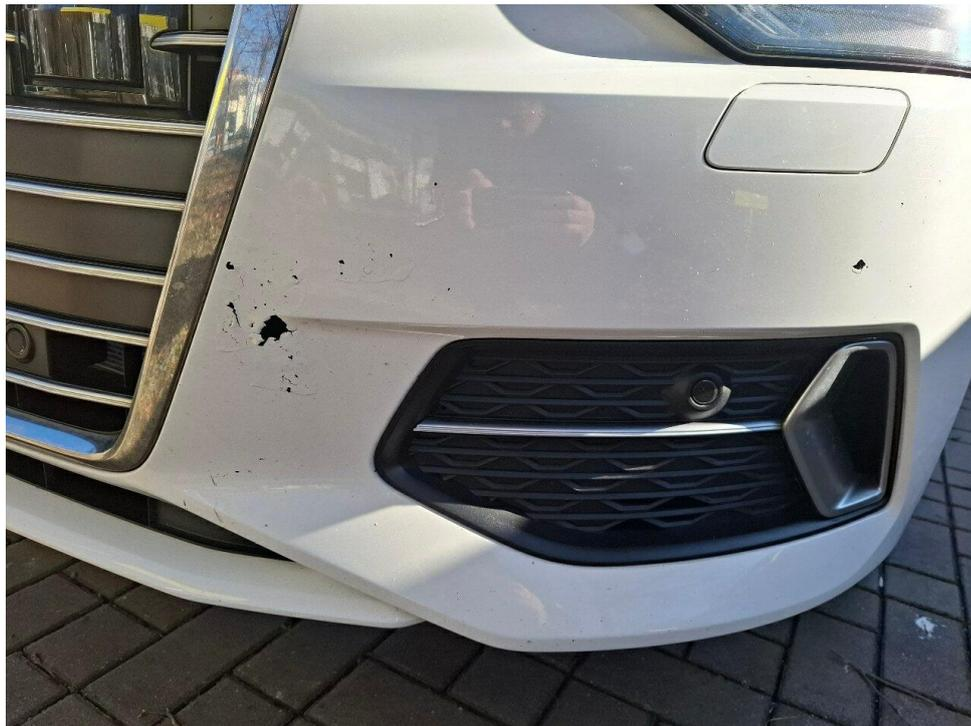
Bild 9 : Stoßfänger vorne Lackierung, viele Steinschläge, lackieren mit Lackaufbau
