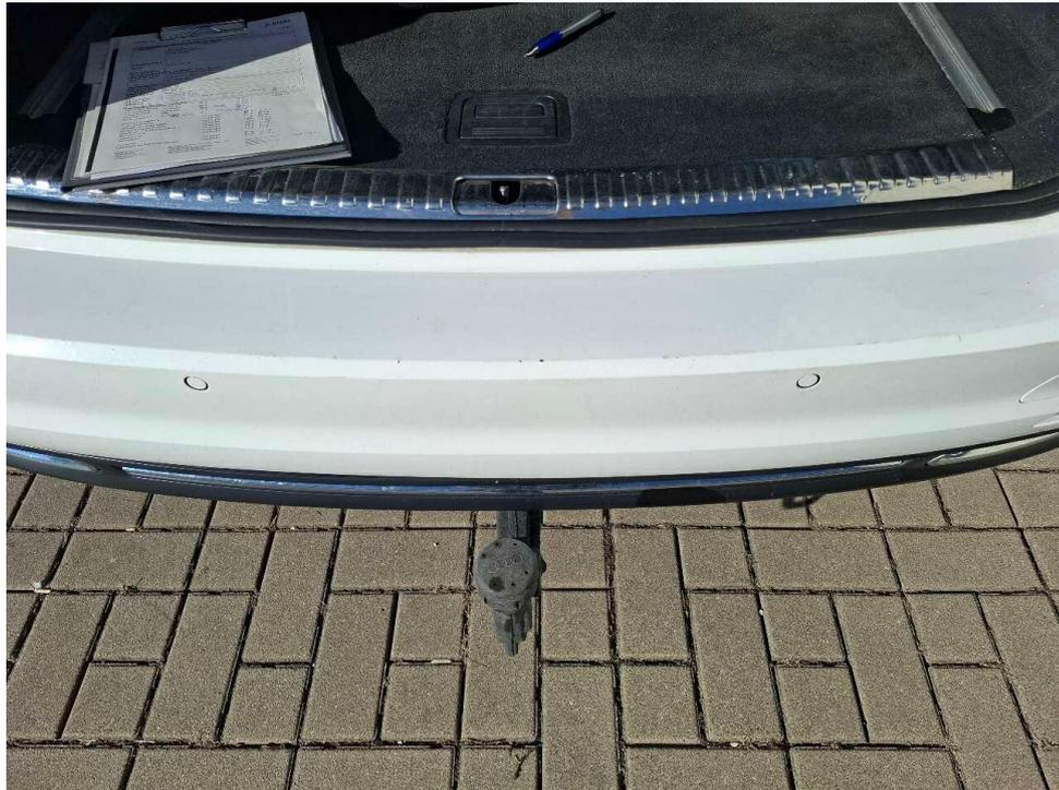
Bild 7 : Stoßfänger hinten Lackierung, verschrammt, Gebrauchsspur
