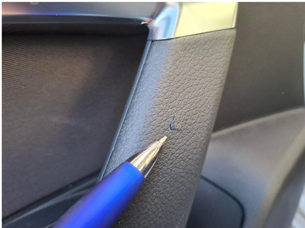
Bild 19 : Verkleidung Tür hinten Griff links, verschrämmt, Gebrauchsspur
