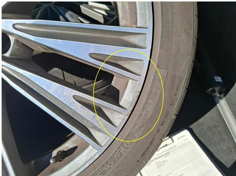
Bild 17 : Glanzgedrehte Felge hinten links Sommerrad verschrammt
