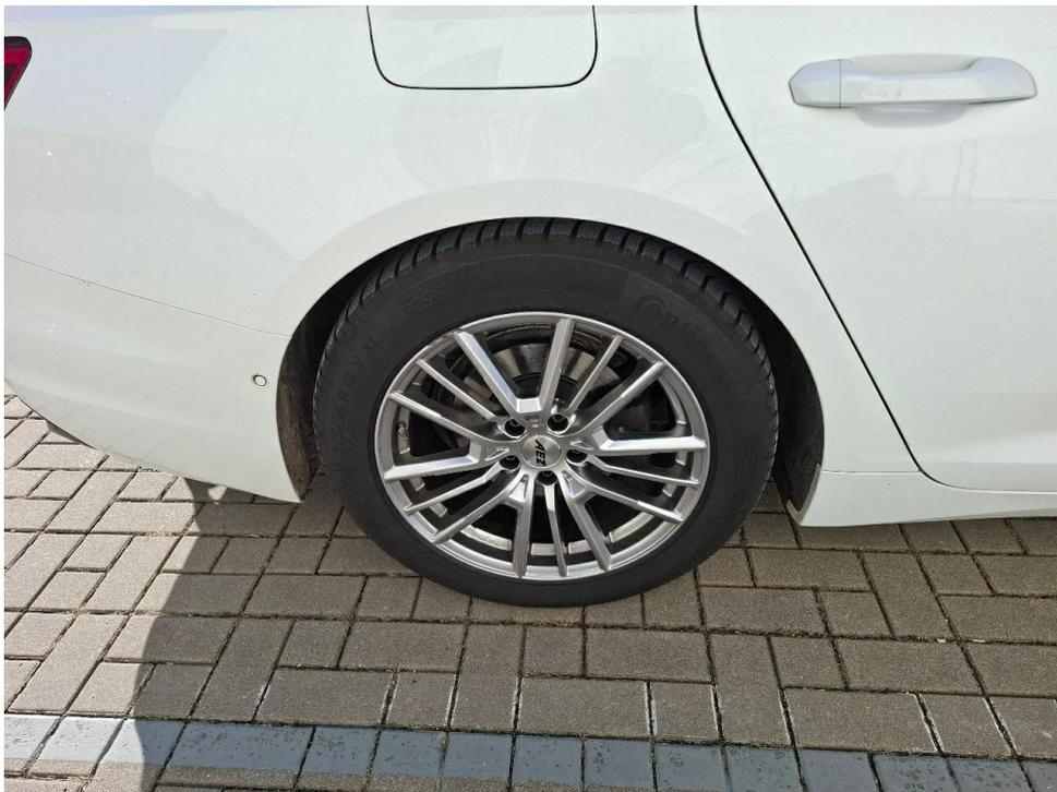
Bild 14 : Felge hinten rechts, verschrammt, Gebrauchsspur
