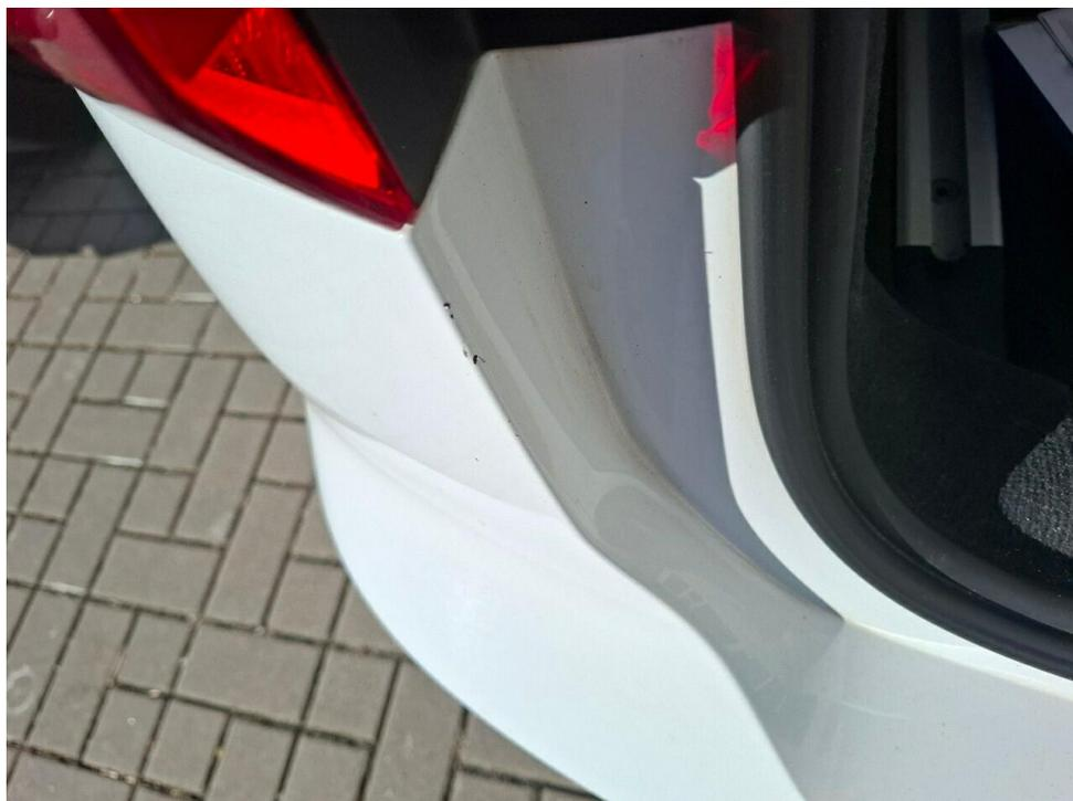
Bild 8 : Stoßfänger hinten Lackierung, verschrammt, Gebrauchsspur
