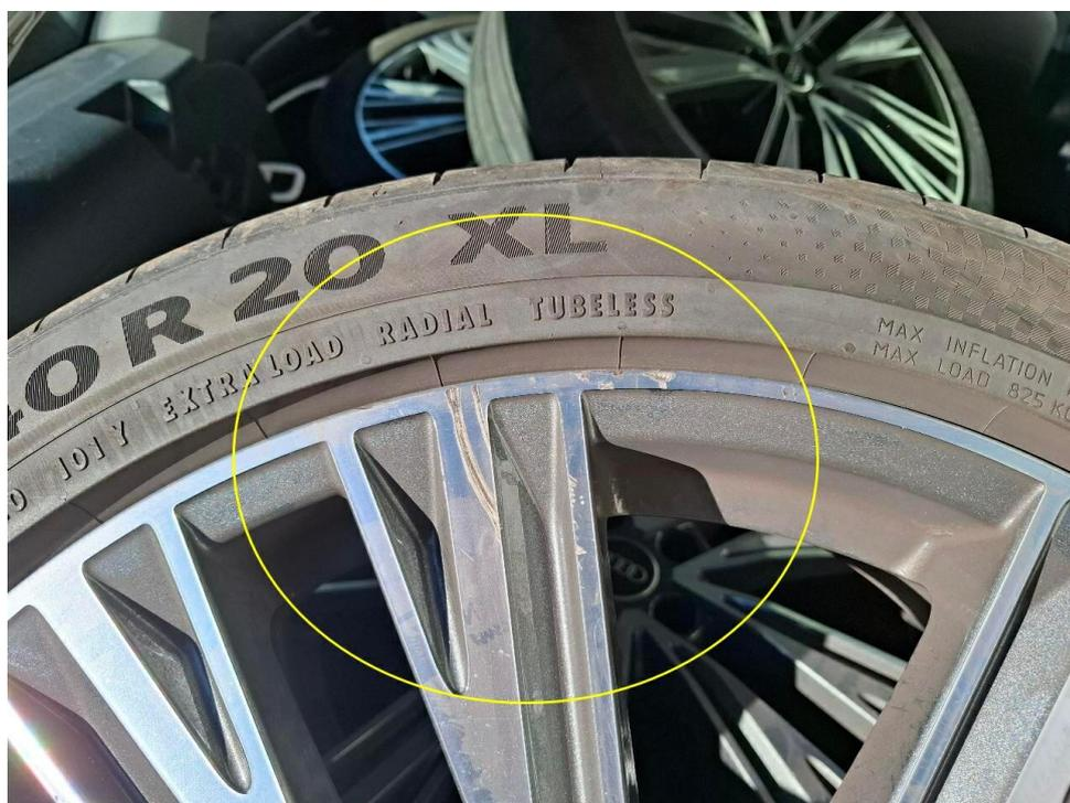
Bild 18 : Glanzgedrehte Felge hinten links Sommerrad verschrammt
