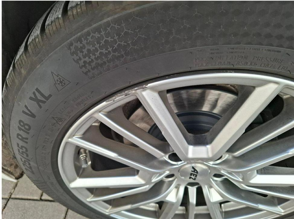
Bild 15 : Felge hinten rechts, verschrammt, Gebrauchsspur
