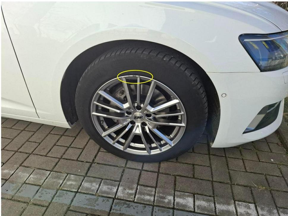
Bild 12 : Felge vorne rechts, verschrammt, Gebrauchsspur
