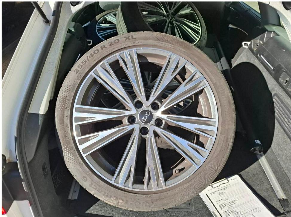
Bild 16 : Glanzgedrehte Felge hinten links Sommerrad verschrammt
