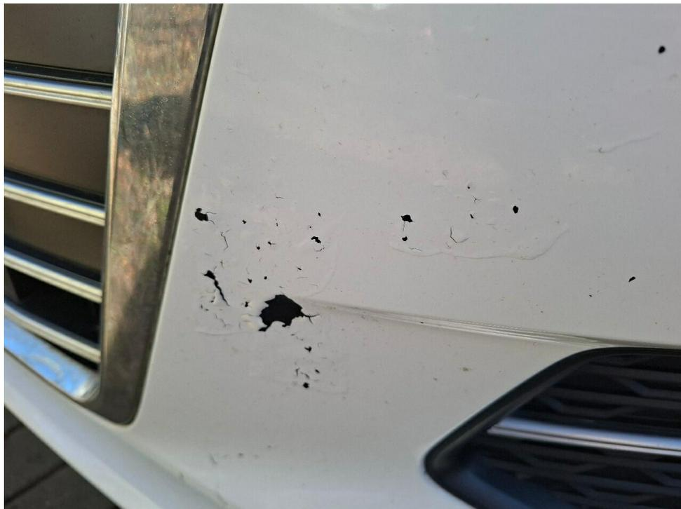
Bild 10 : Stoßfänger vorne Lackierung, viele Steinschläge, lackieren mit Lackaufbau
