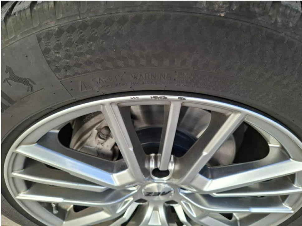
Bild 13 : Felge vorne rechts, verschrammt, Gebrauchsspur
