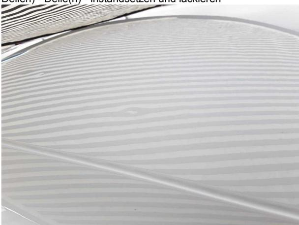
**Beschädigung #6:** Fahrzeugdach: Dach (Hagelschaden, ca. 80
