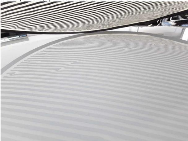
**Beschädigung #6:** Fahrzeugdach: Dach (Hagelschaden, ca. 80 Dellen) - Delle(n) - instandsetzen und lackieren
