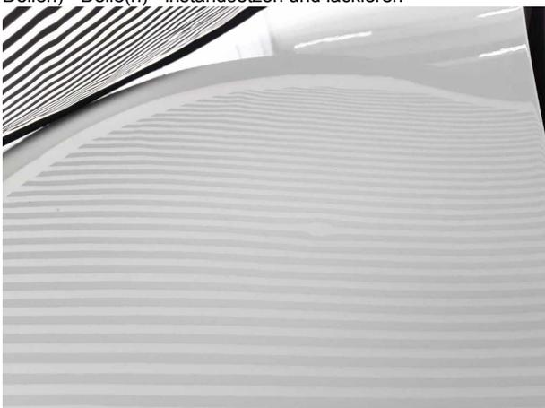
**Beschädigung #5:** Motorhaube: Motorhaube (Hagelschaden ca. ...
