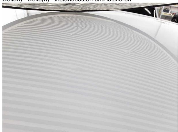
**Beschädigung #6:** Fahrzeugdach: Dach (Hagelschaden, ca. ...
