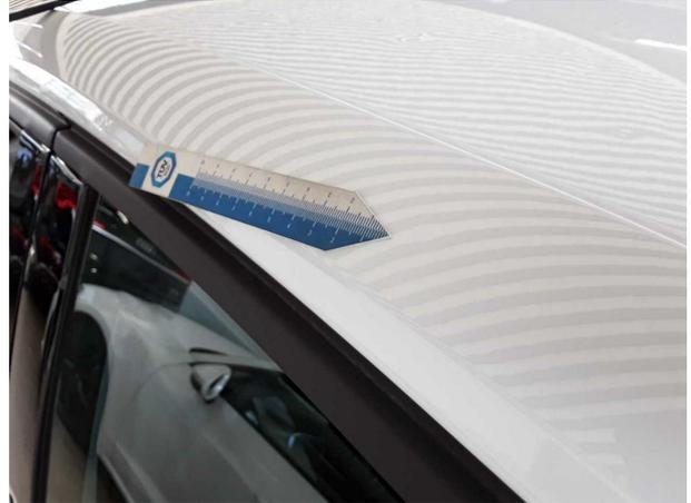
**Beschädigung #1:** Fahrzeugdach: Dachholm links - Delle(n) - sanft instandsetzen
