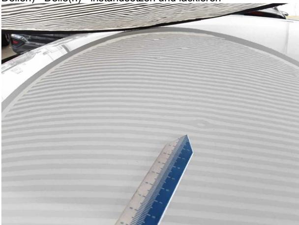
**Beschädigung #6:** Fahrzeugdach: Dach (Hagelschaden, ca. 80
