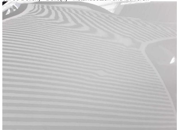
**Beschädigung #5:** Motorhaube: Motorhaube (Hagelschaden
