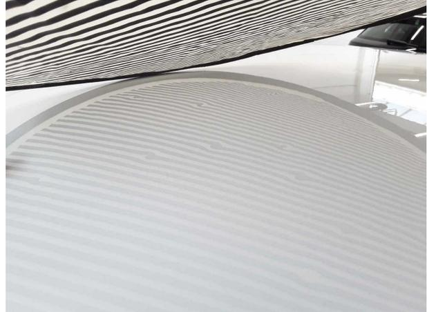
**Beschädigung #6:** Fahrzeugdach: Dach (Hagelschaden, ca. ... Dellen) - Delle(n) - instandsetzen und lackieren
