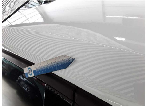
**Beschädigung #2:** Fahrzeugdach: Dachholm rechts - Delle(n) - sanft instandsetzen
