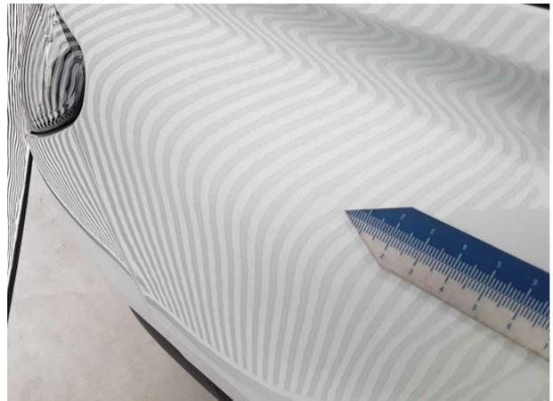
**Beschädigung #3:** Kotflügel links: Kotflügel links - Delle(n) - sanft instandsetzen
