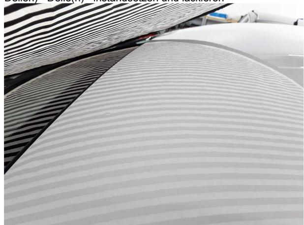
**Beschädigung #6:** Fahrzeugdach: Dach (Hagelschaden, ca. ...
