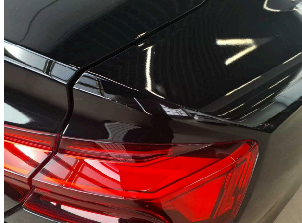
Domage #6: Panneau latéral arrière droit: Paroi latérale - Eraflé - Réparer et repeindre
