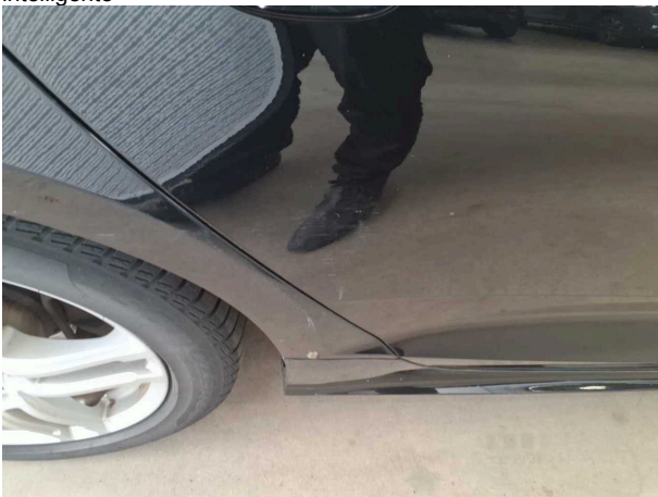
Domage #5: Porte ArD: Porte - Erafilé - Réparer et repeindre
