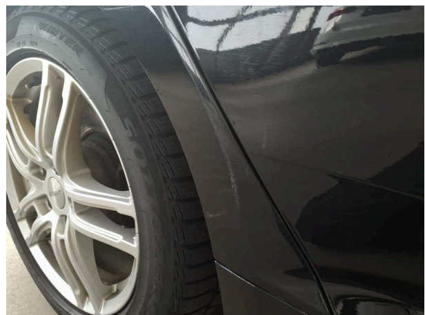
Domage #6: Panneau latéral arrière droit: Paroi latérale - Erafilé - Réparer et repeindre
