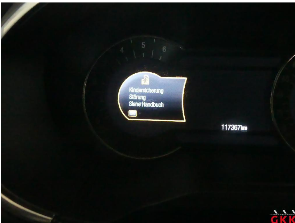
Bild 14 Kombiinstrument, Fehlerspeicher, aktiv, auslesen / prüfen
