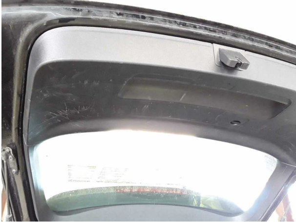
Domage #9: Habillages/Protections: Couvercle de coffre - garniture intérieure - Erafilé - Remplacer
