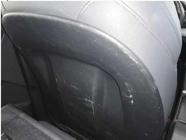
Domage #7: Siège avant: Habillage coffret siège gauche - Erafilé - Diminution de valeur
