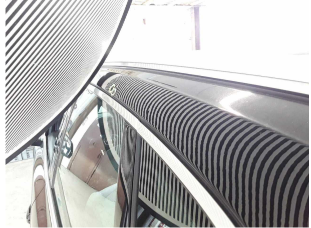
Domage #6: Toit: Rail de toit gauche - bosse(s) - Bon travail de réparation
