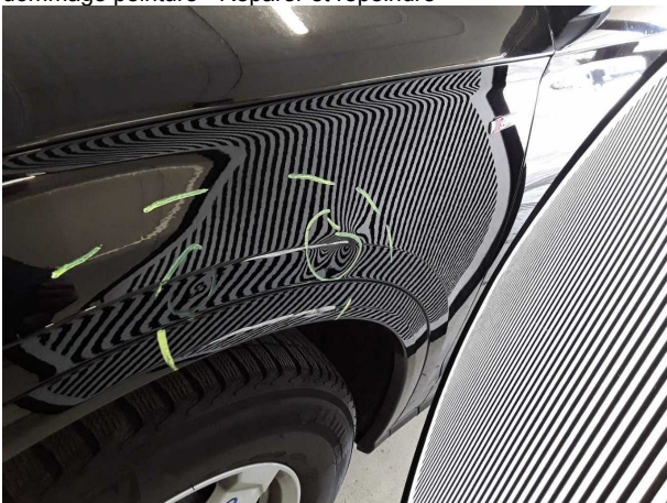
Domage #13: Garde-boue gauche: Garde-boue gauche - Bosse, dommage peinture - Réparer et repeindre
