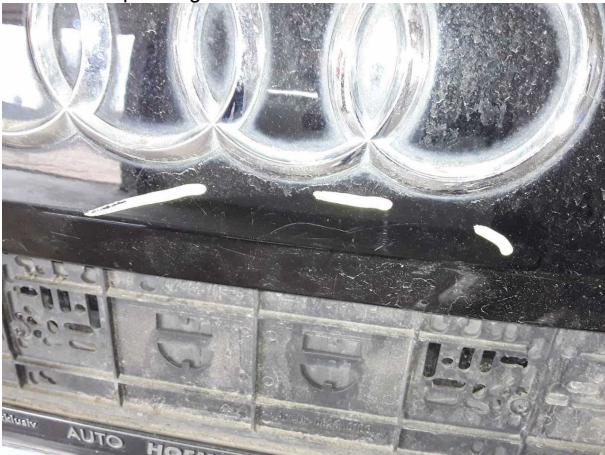
Domage #3: Hayon/Porte arrière: Couvercle de coffre - Rayure... - Revêtement/polissage
