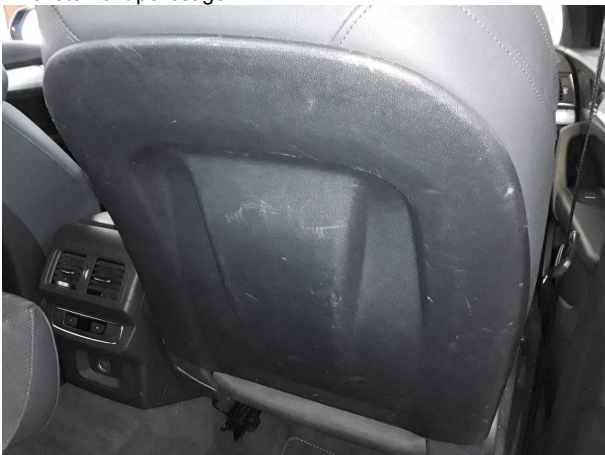
Domage #5: Siège avant: Habillage coffret siège droite - Erafé... - Diminution de valeur
