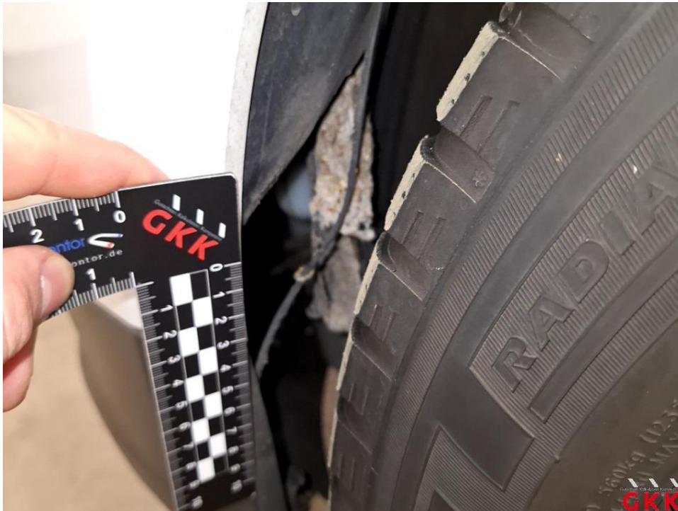
Bild 17 Radhausschale vorne links, beschädigt, ersetzen
