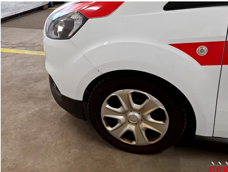
Bild 16 Radhausschale vorne links, beschädigt, ersetzen
