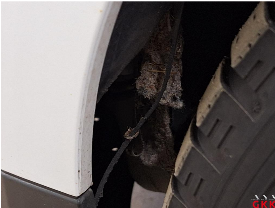
Bild 18 Radhausschale vorne links, beschädigt, ersetzen
