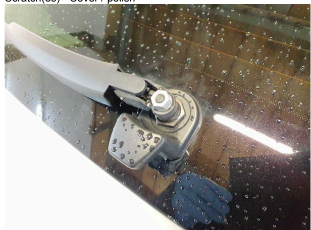
Damage #4: Screen cleaning: Wiper arm - rear (Abdeckung fehlt) - Replace
