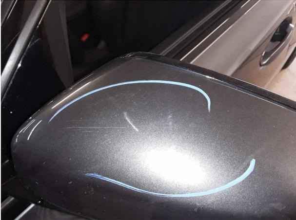
**Dommage #2:** Rétroviseur gauche: Capuchon - Rayure(s) - Réparation intelligente
