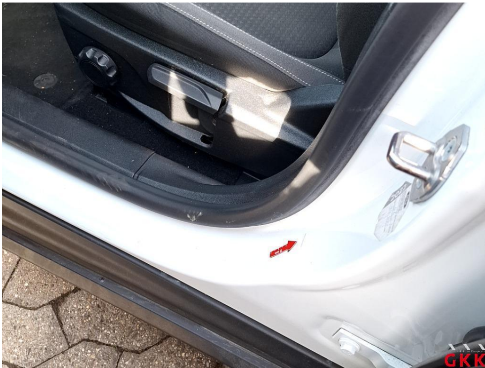
Bild 42 Tür vorne links, Einstieg, verkratzt, Smartrepair
