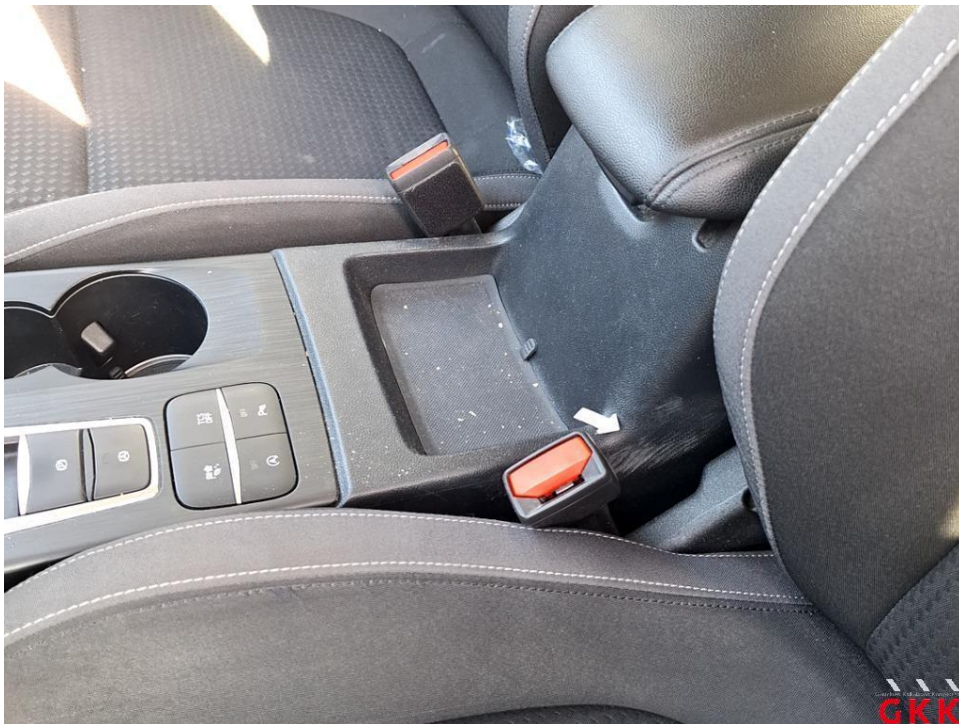
Bild 30 Mittelkonsole, verkratzt, ersetzen
