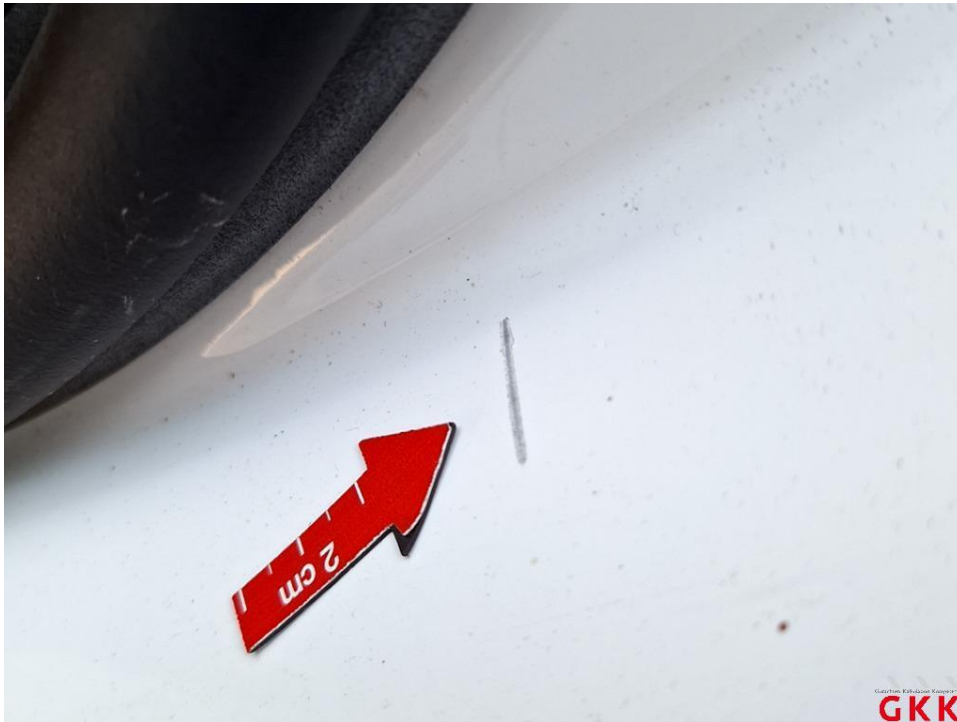
Bild 43 Tür vorne links, Einstieg, verkratzt, Smartrepair
