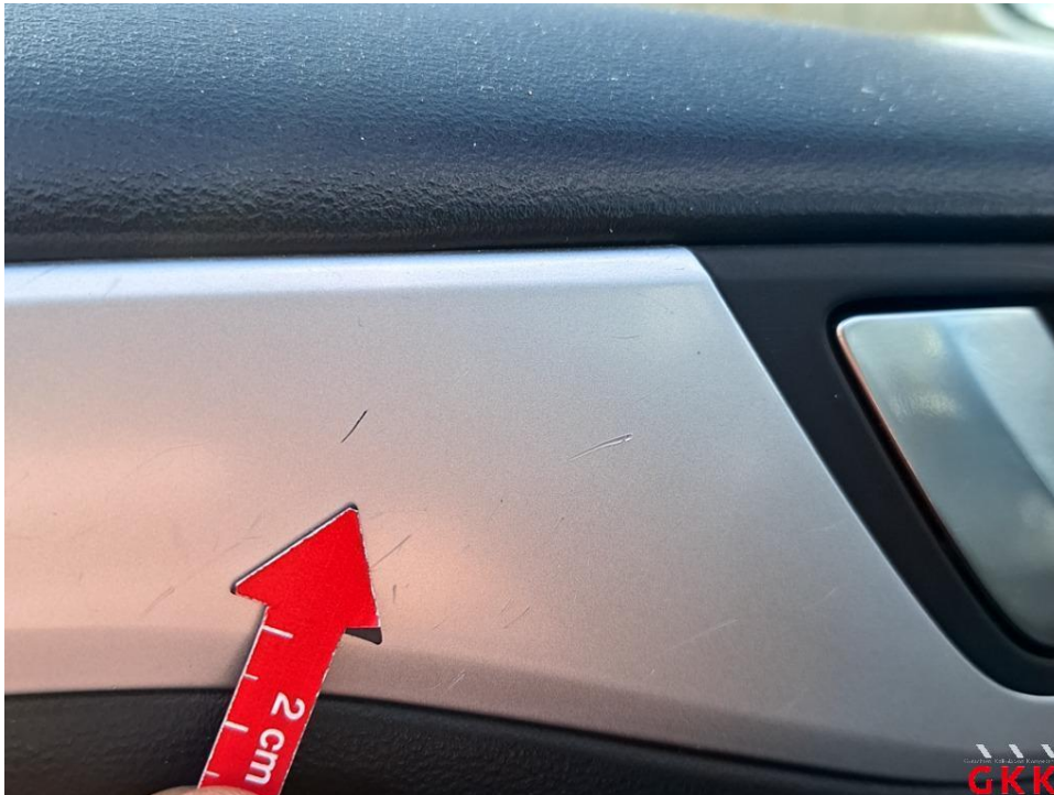
Bild 23 Tür vorne links, Innenverkleidung -Zierleiste-, verkratzt, ersetzen
