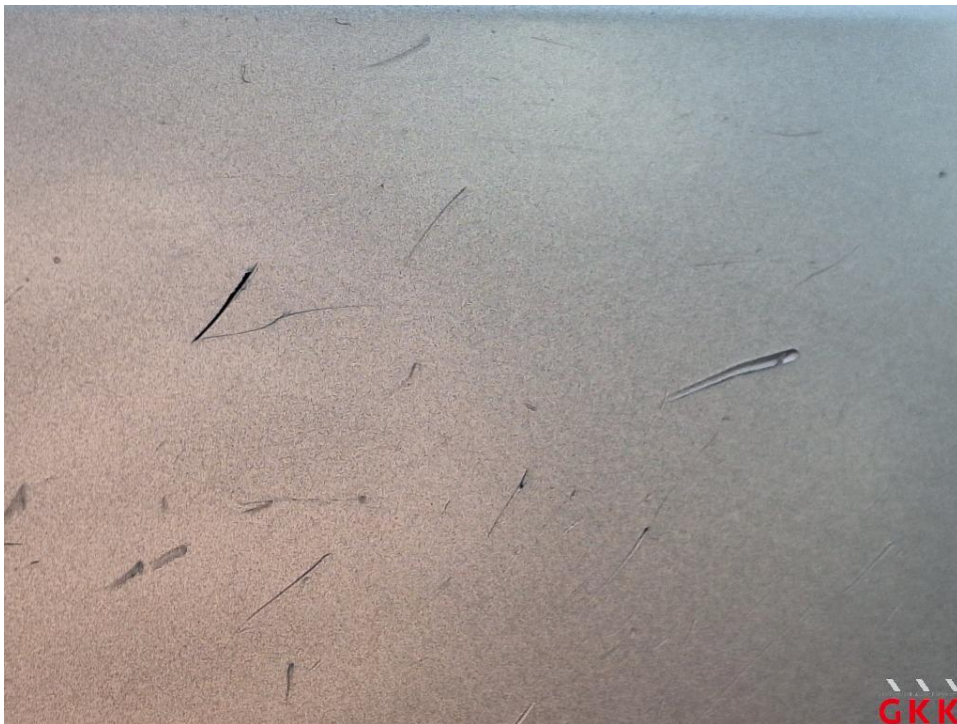
Bild 24 Tür vorne links, Innenverkleidung -Zierleiste-, verkratzt, ersetzen
