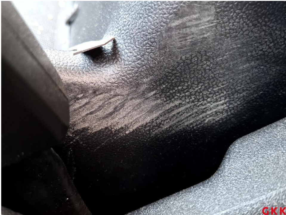
Bild 31 Mittelkonsole, verkratzt, ersetzen
