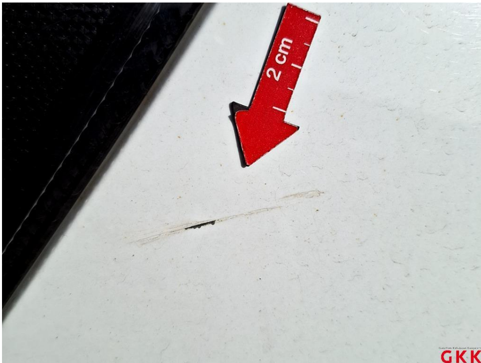
Bild 38 Kotflügel vorne links, verkratzt, lackieren
