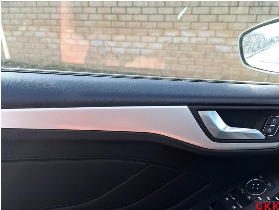
Bild 25 Tür vorne links, Innenverkleidung -Zierleiste-, verkratzt, ersetzen
