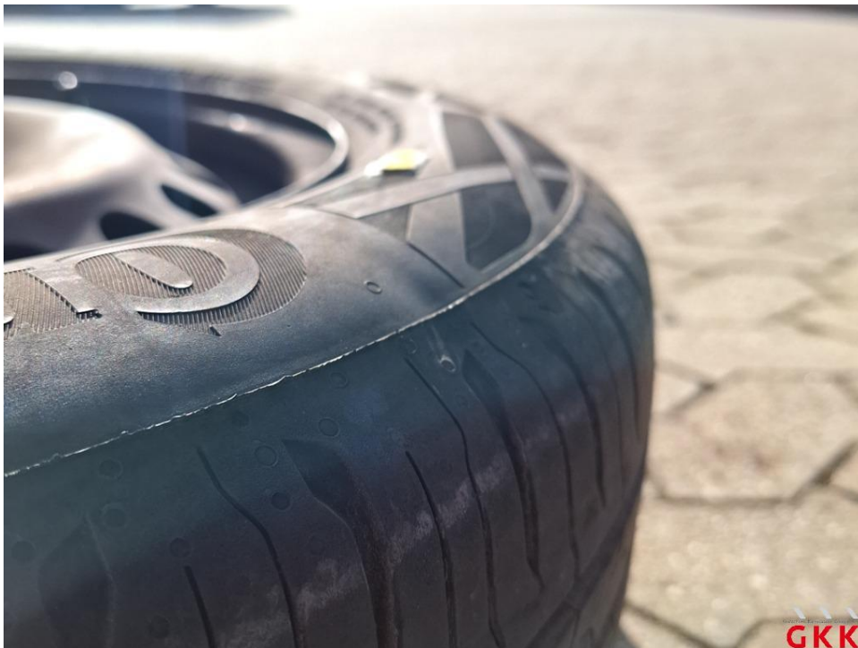
Bild 18 Reifen, 3 x beiliegend, beschädigt, ersetzen
