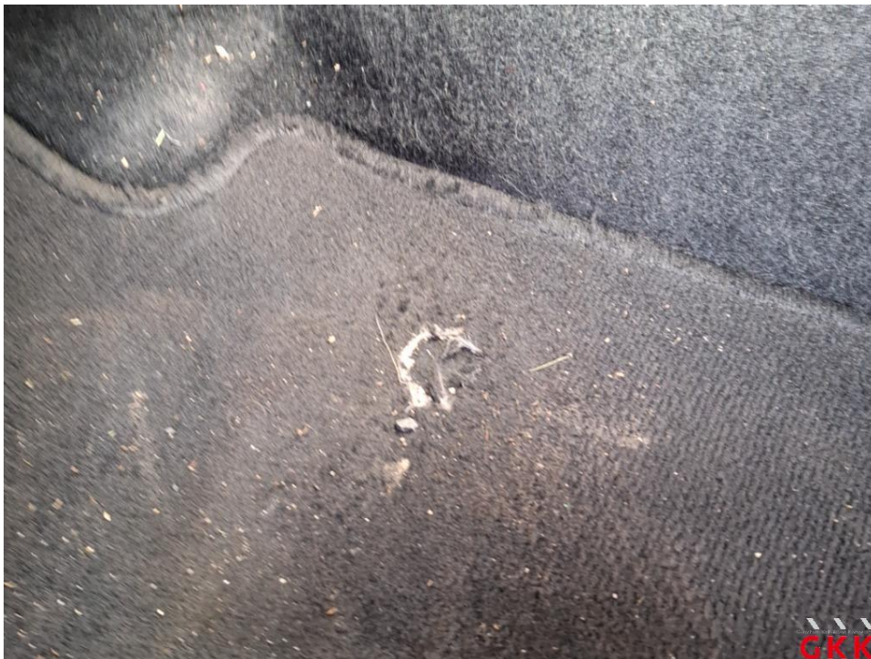
Bild 34 Fußmatte(n), vorne links, beschädigt, ersetzen
