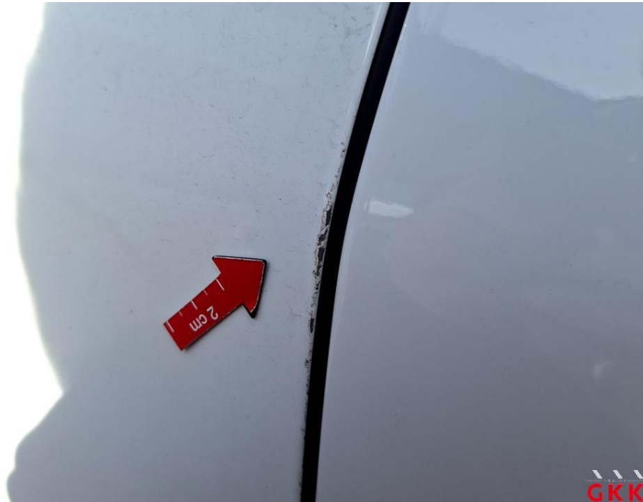
Bild 41 Tür vorne links, Kante, verkratzt, auslegen, schleifen, polieren
