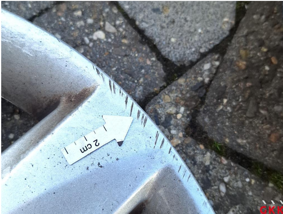
Bild 21 Radkappe(n), Satz, beschädigt, ersetzen
