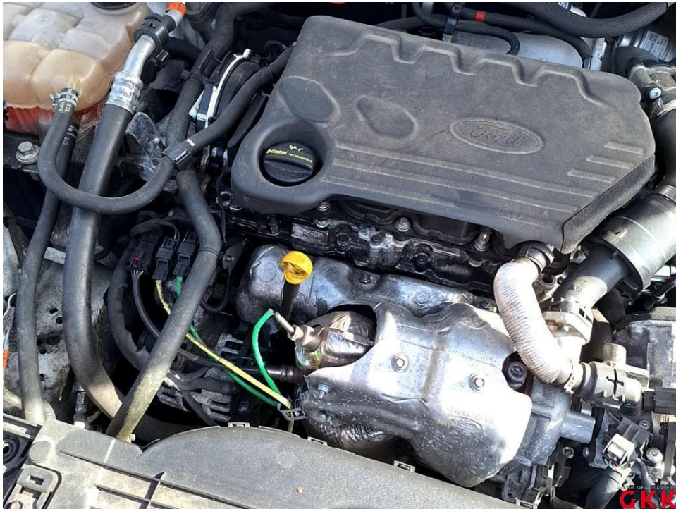
Bild 49 Motor, Öl undicht, prüfen
