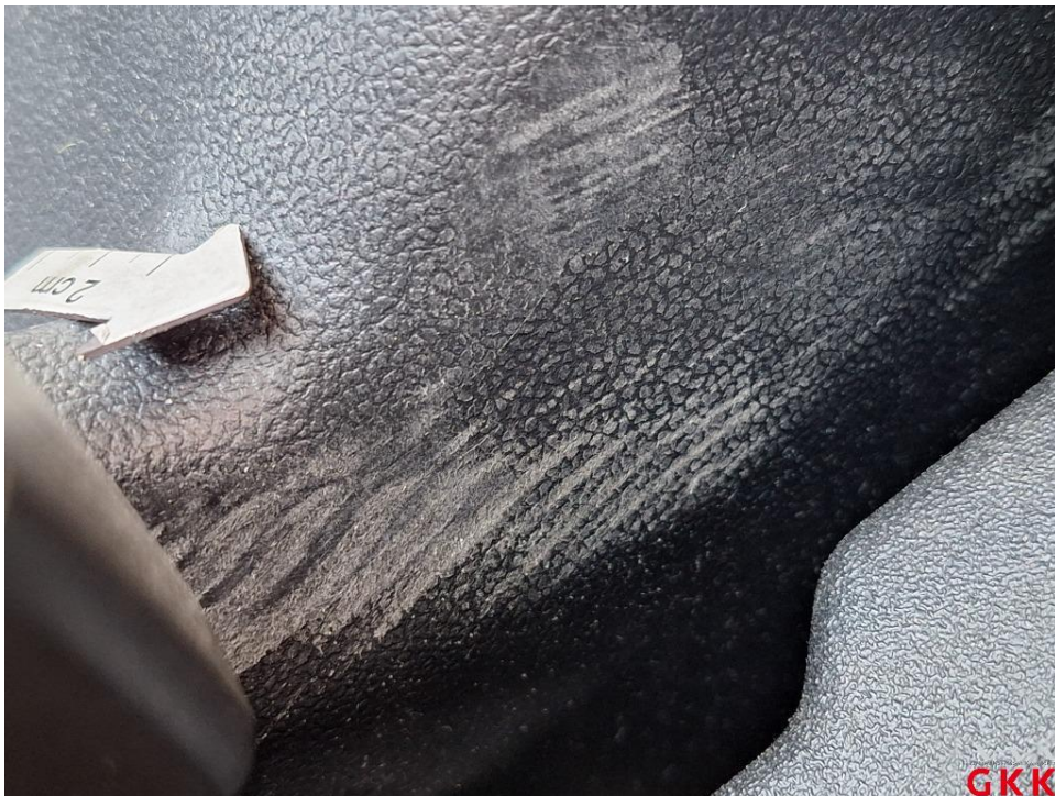
Bild 32 Mittelkonsole, verkratzt, ersetzen
