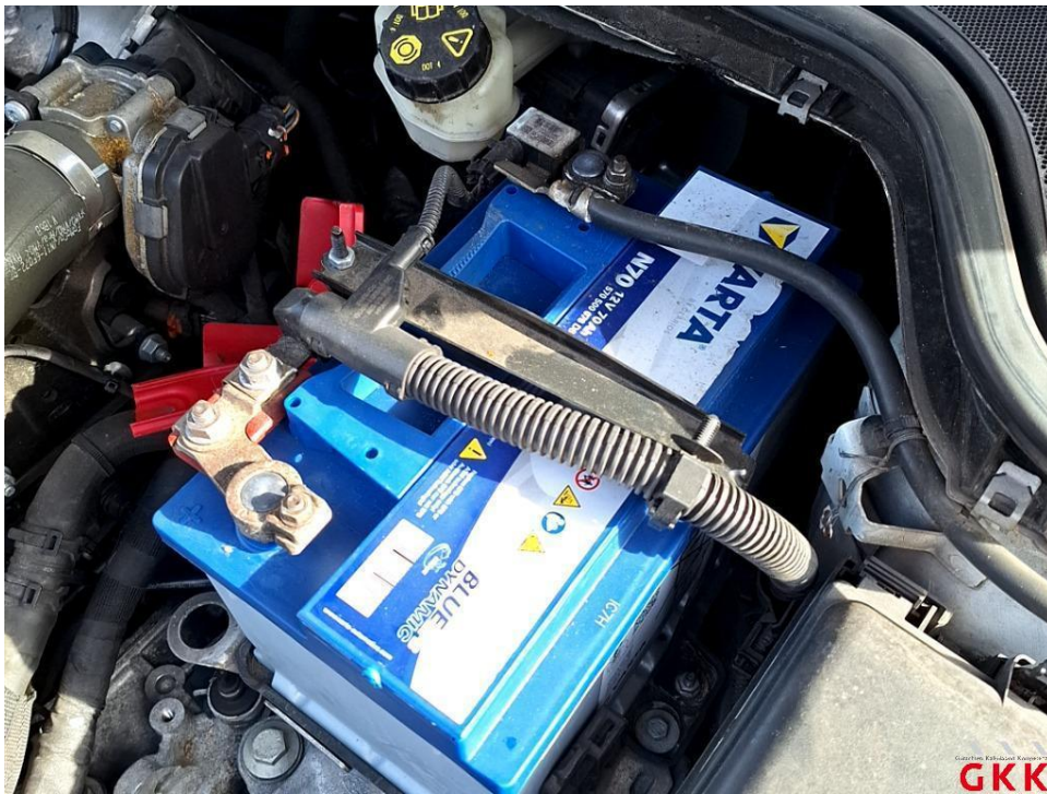
Bild 48 Fahrzeug, Batterie, entladen, ersetzen
