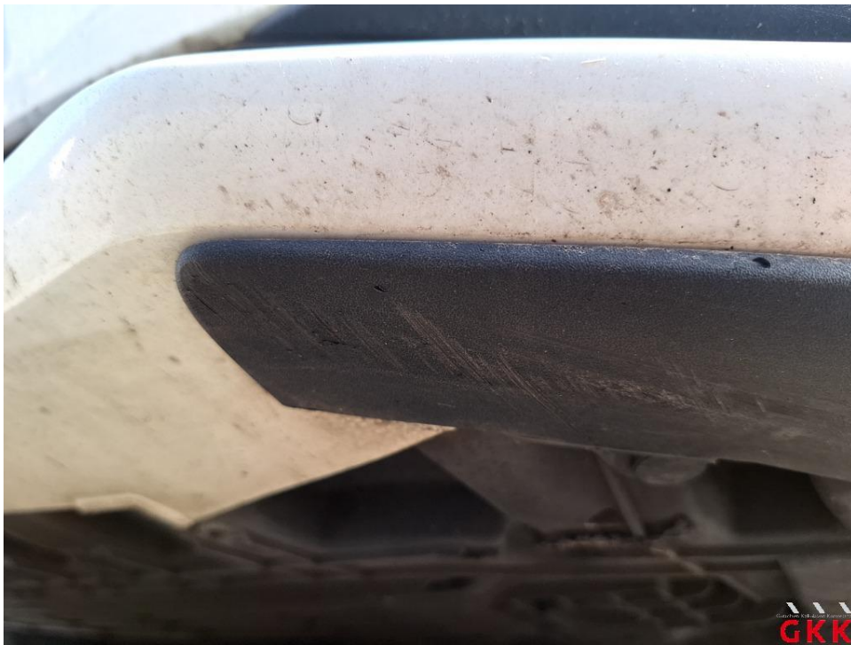
Bild 46 Stoßfänger vorne, Verkleidung unterhalb -unlackiert-, verkratzt, ersetzen
