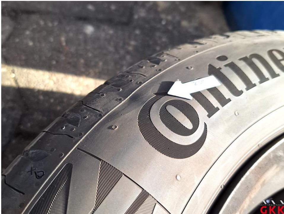
Bild 19 Reifen, 3 x beiliegend, beschädigt, ersetzen
