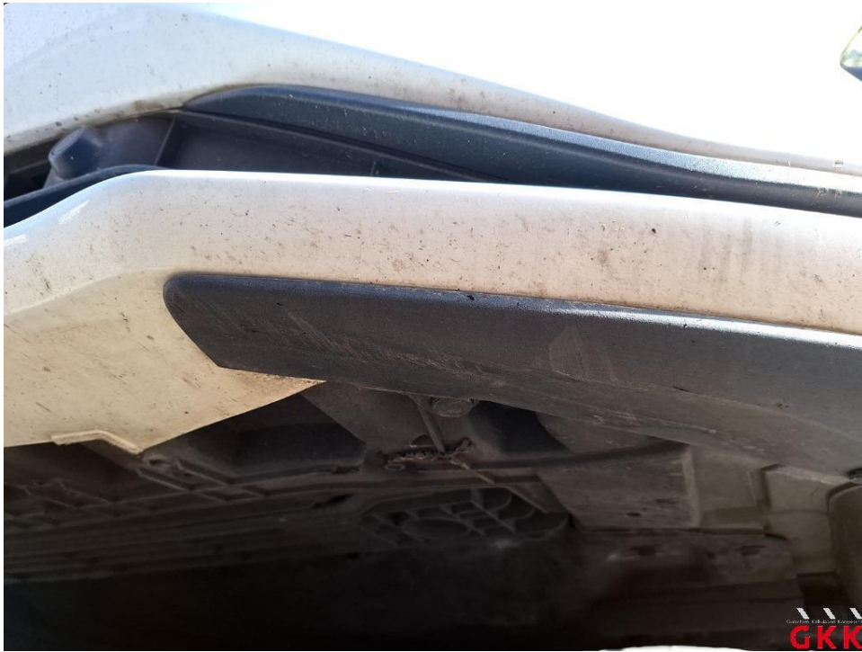
Bild 45 Stoßfänger vorne, Verkleidung unterhalb -unlackiert-, verkratzt, ersetzen
