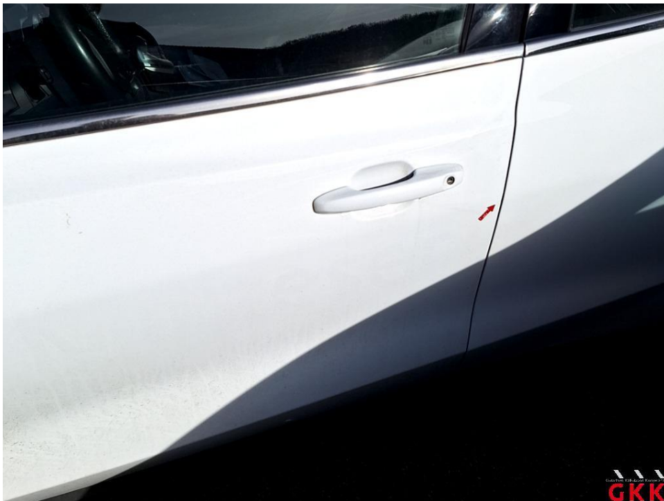
Bild 40 Tür vorne links, Kante, verkratzt, auslegen, schleifen, polieren
