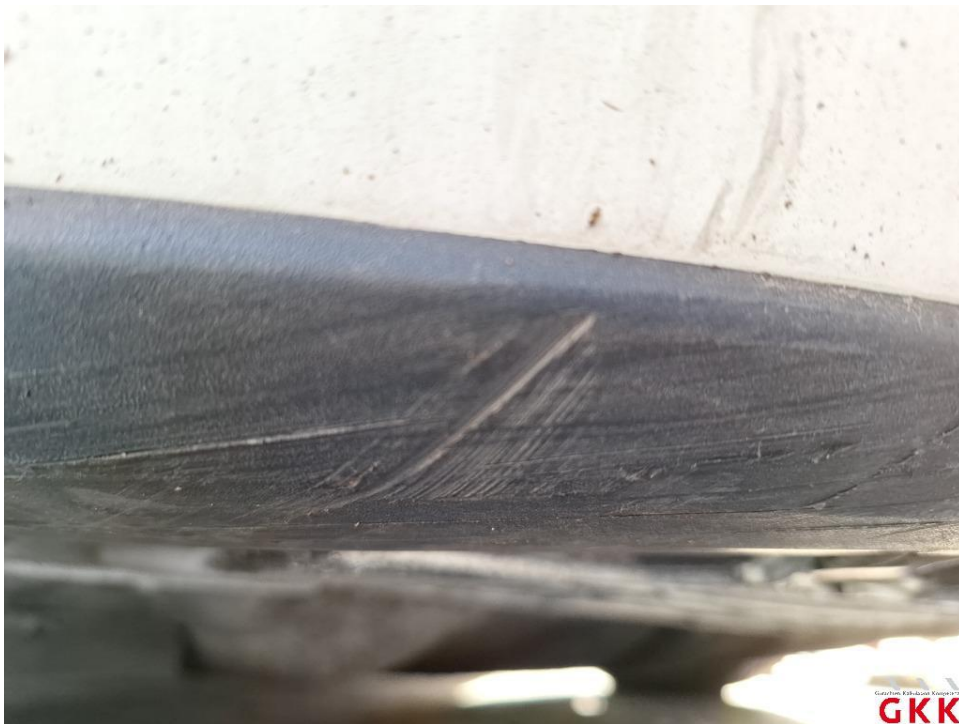
Bild 47 Stoßfänger vorne, Verkleidung unterhalb -unlackiert-, verkratzt, ersetzen
