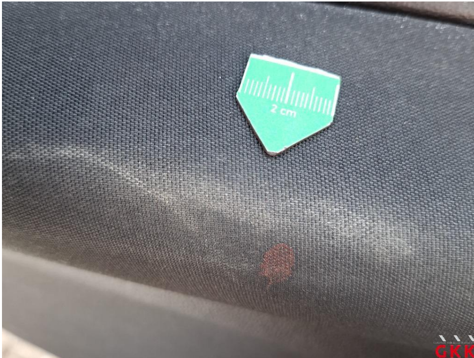
Bild 27 Tür vorne links, Innenverkleidung -Standard-, verschmutzt, reinigen
