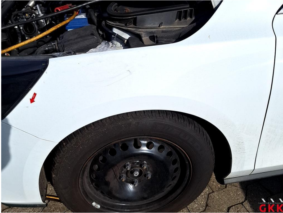
Bild 37 Kotflügel vorne links, verkratzt, lackieren
