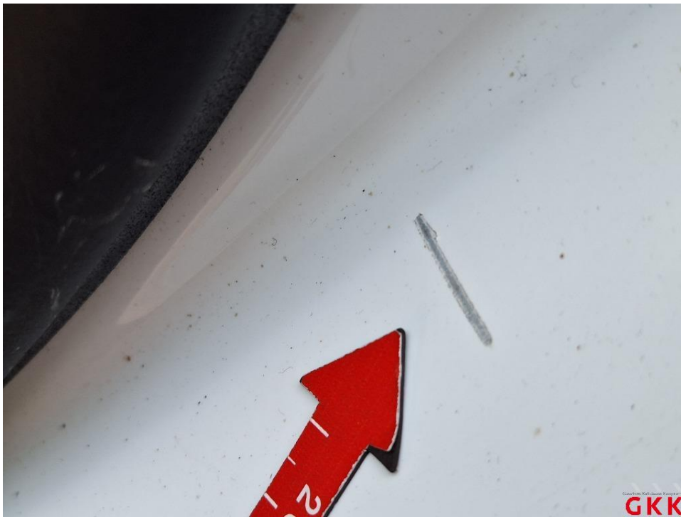
Bild 44 Tür vorne links, Einstieg, verkratzt, Smartrepair
