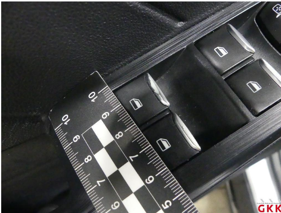
Bild 28 Tür vorne links, Fensterkurbel, beschädigt, ersetzen
