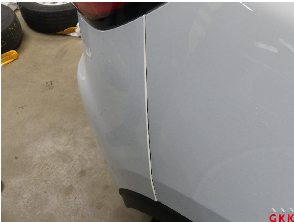
Bild 20 Stoßfänger hinten, Verkleidung -lackiert-, lose, instand setzen
