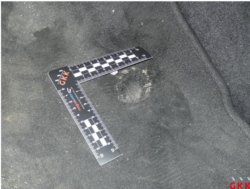
Bild 30 Fußmatte(n), vorne links, beschädigt, ersetzen
