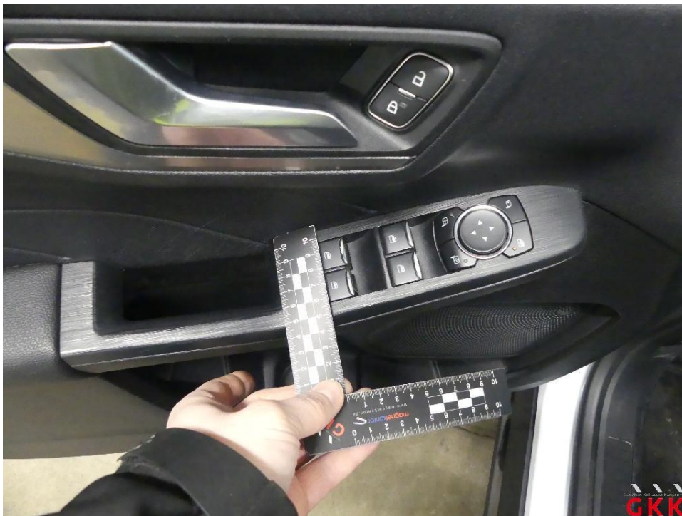
Bild 26 Tür vorne links, Fensterkurbel, beschädigt, ersetzen
