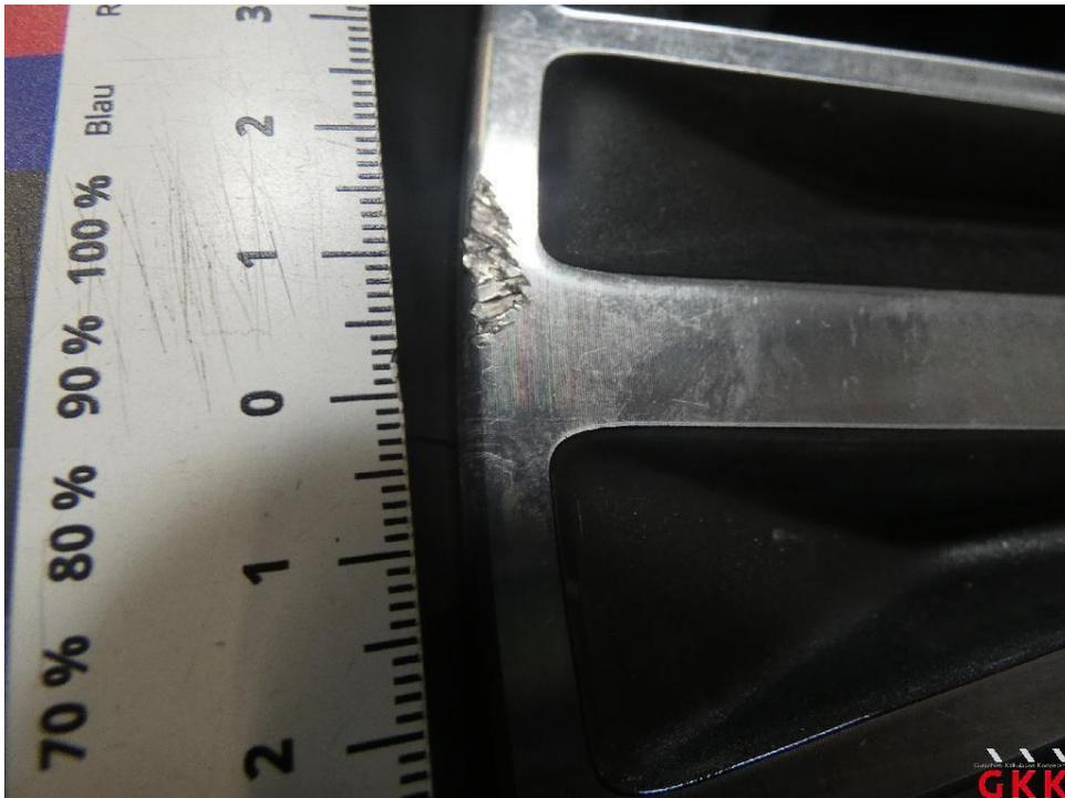
Bild 20 LM-Rad, 2 x beiliegend, beschädigt, ersetzen
