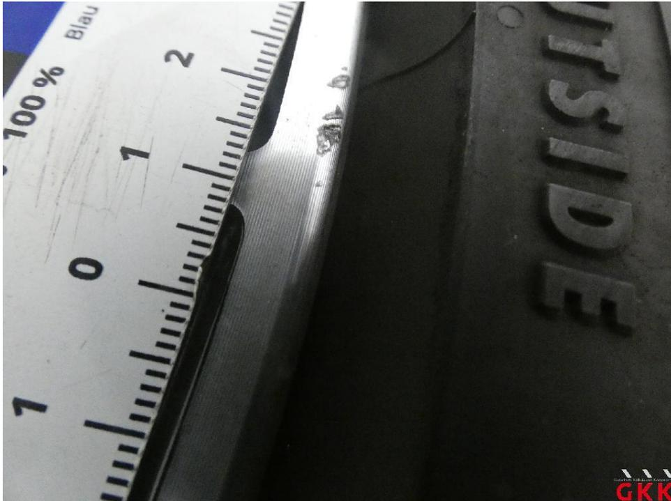
Bild 19 LM-Rad, 2 x beiliegend, beschädigt, ersetzen
