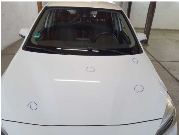
Damage #19: Body: Body (Mehr kosten möglich) - Damage by hail - Smooth repair work
