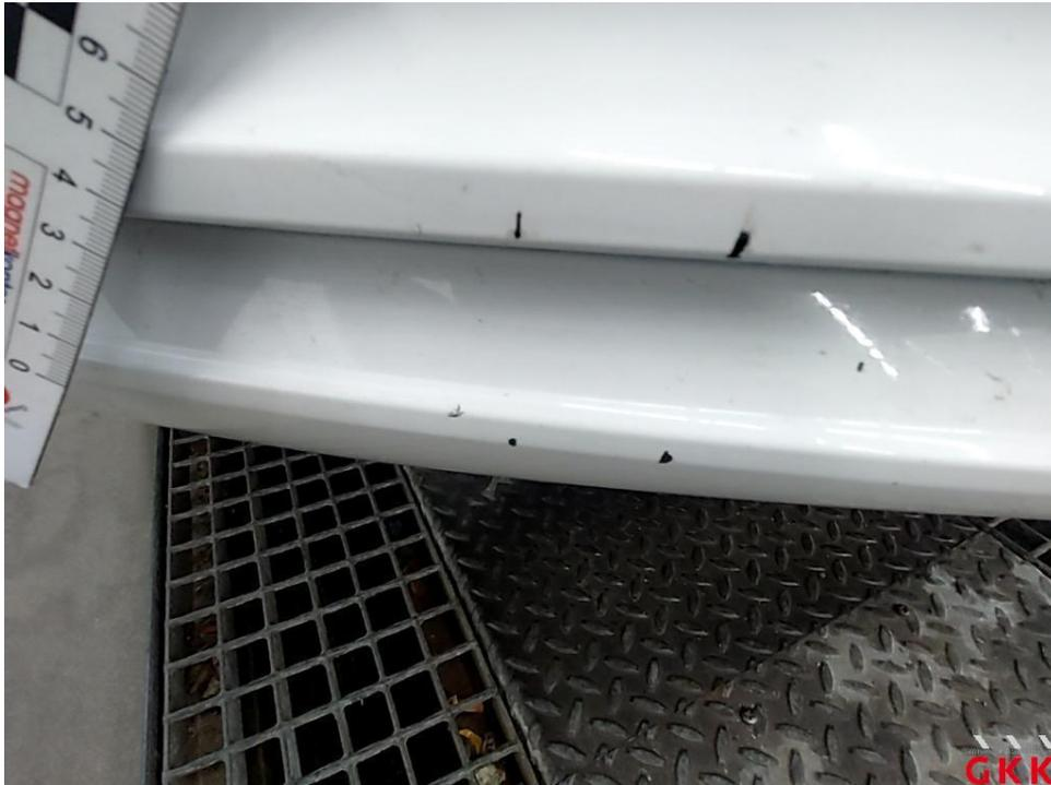
Bild 12. Stoßfänger vorne, Verkleidung -lackiert-, verkratzt, lackieren
