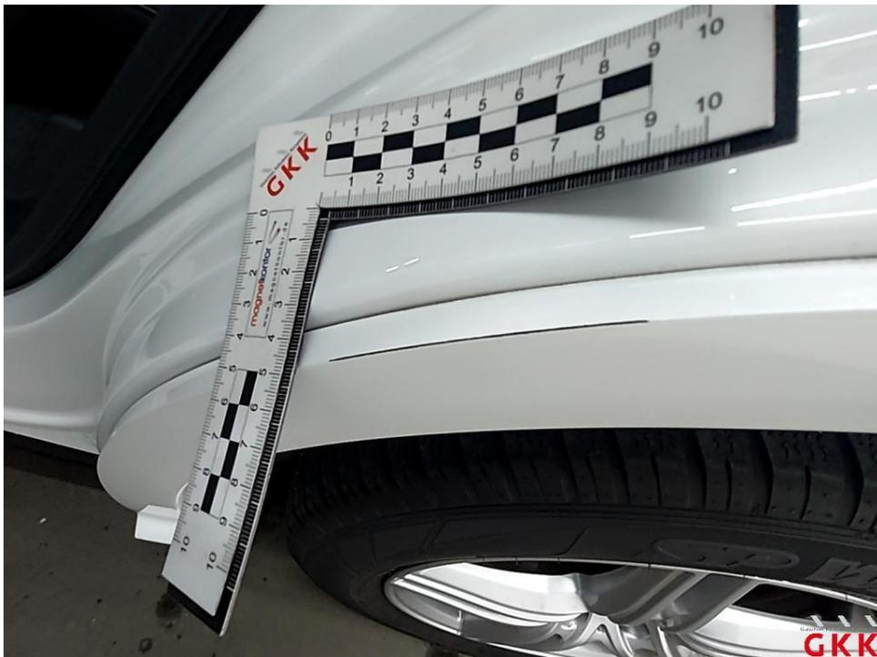
Bild 16. Seitenwand links, Leiste, Radlauf, verkratzt, lackieren
