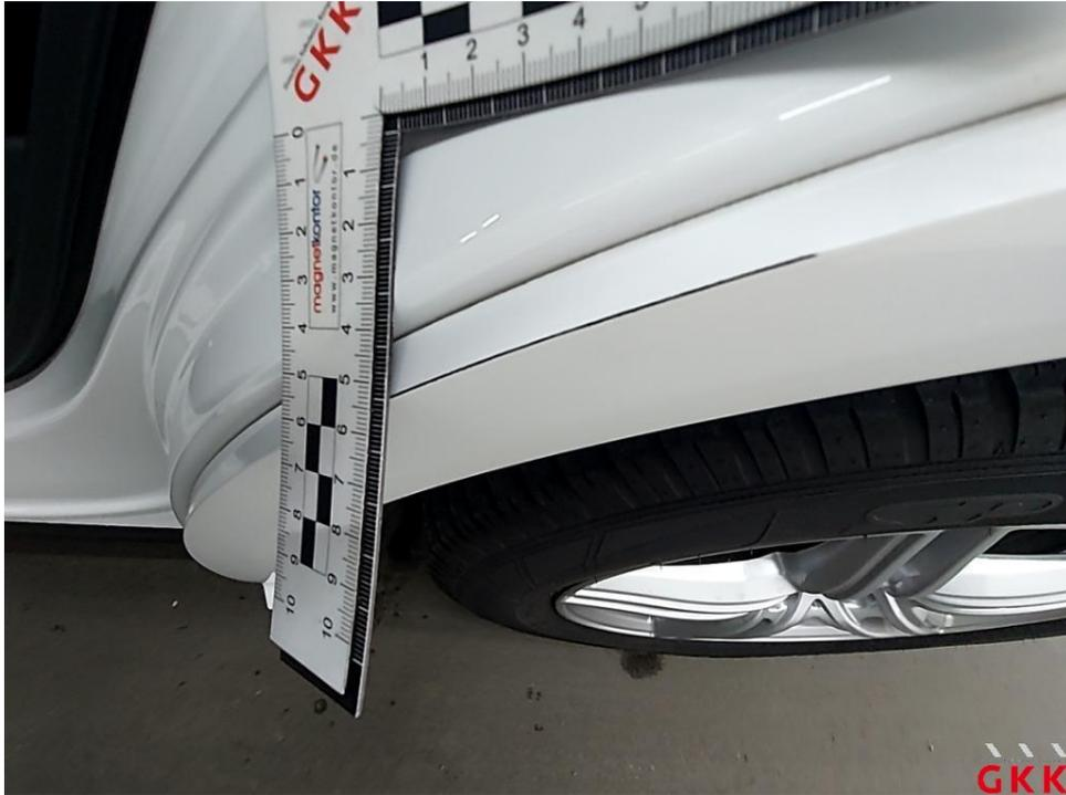
Bild 15. Seitenwand links, Leiste, Radlauf, verkratzt, lackieren
