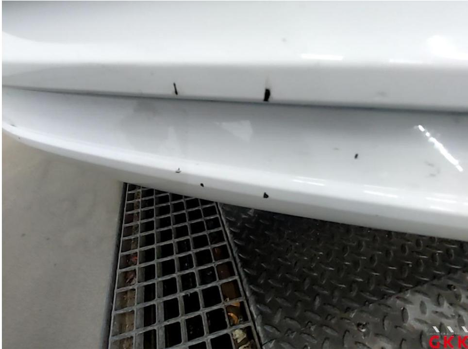
Bild 13. Stoßfänger vorne, Verkleidung -lackiert-, verkratzt, lackieren
