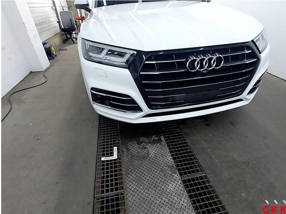
Bild 11. Stoßfänger vorne, Verkleidung -lackiert-, verkratzt, lackieren
