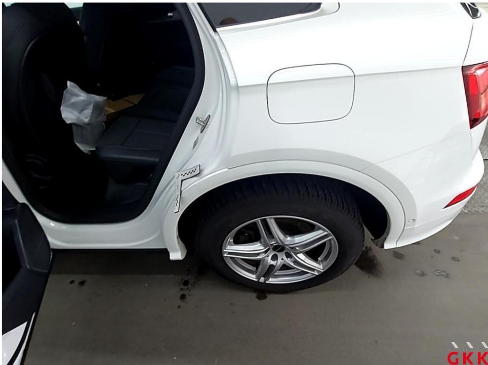
Bild 14. Seitenwand links, Leiste, Radlauf, verkratzt, lackieren
