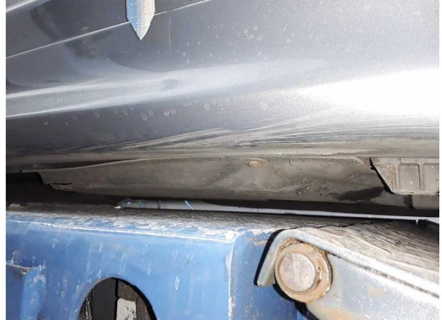
**Beschädigung #4:** Schweller rechts: Verkleidung - verkratzt / verschürft - instandsetzen und lackieren
