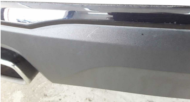
Beschädigung #2: Stossfänger hinten: Spoiler - Kratzer - Wertminderung
