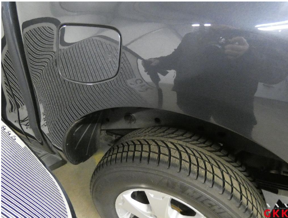
Bild 24 Seitenwand links, beschädigt, kalt drücken
