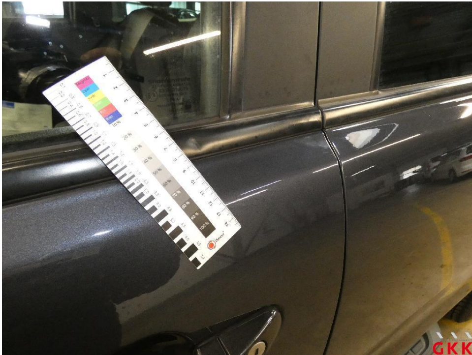
Bild 19 Tür vorne links, Schachtleiste -unlackiert-, beschädigt, ersetzen
