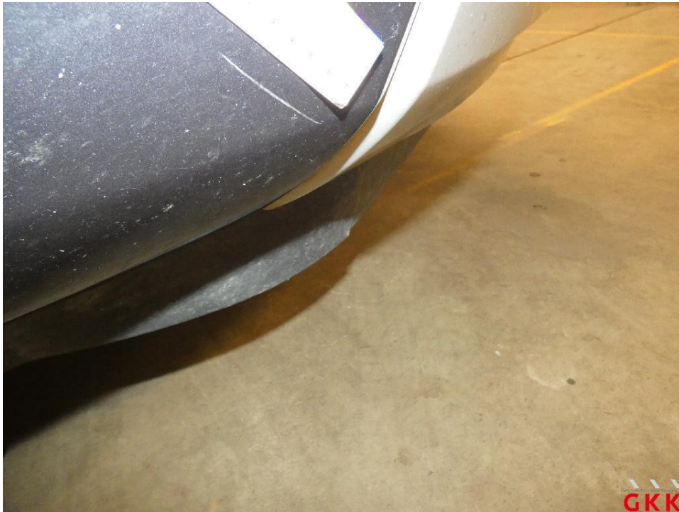
Bild 39 Stoßfänger vorne, Ecke rechts -lackiert-, verkratzt, Spotlackieren
