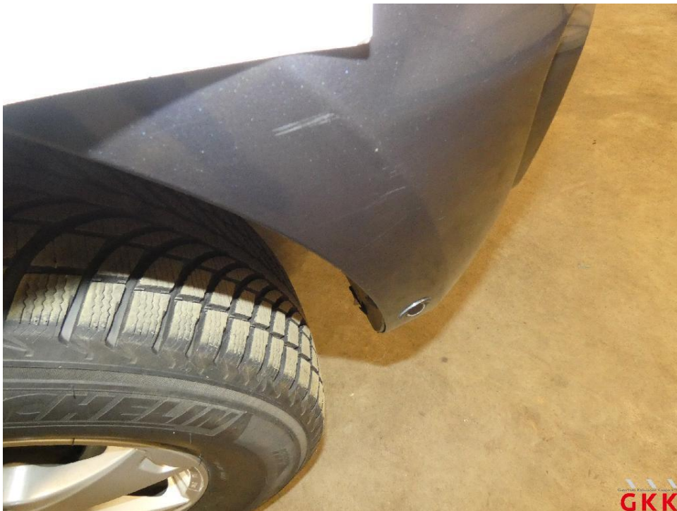
Bild 38 Stoßfänger vorne, Ecke rechts -lackiert-, verkratzt, Spotlackieren
