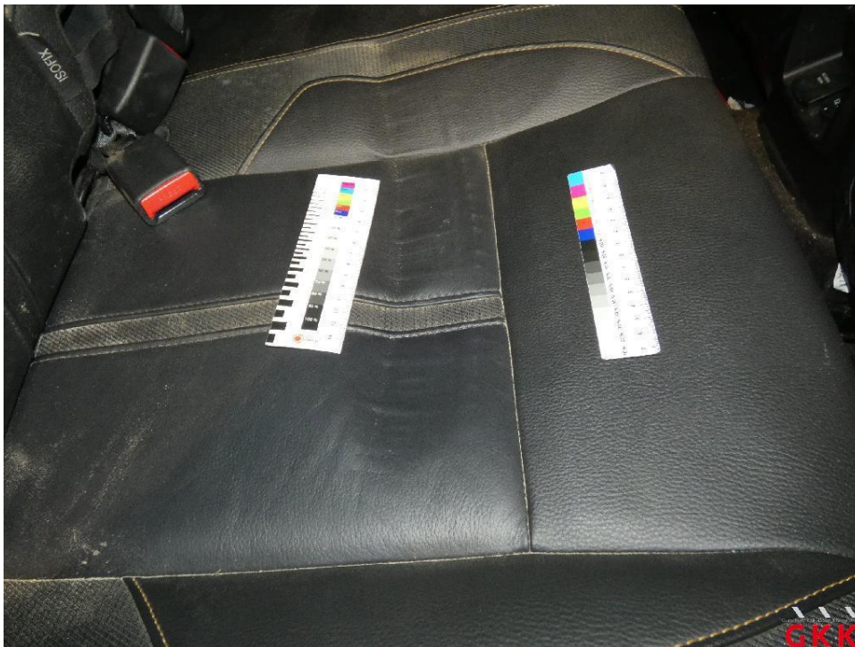
Bild 32 Sitzbank hinten, Bezug Sitzkissen -Teilleder-, Druckstellen, ersetzen
