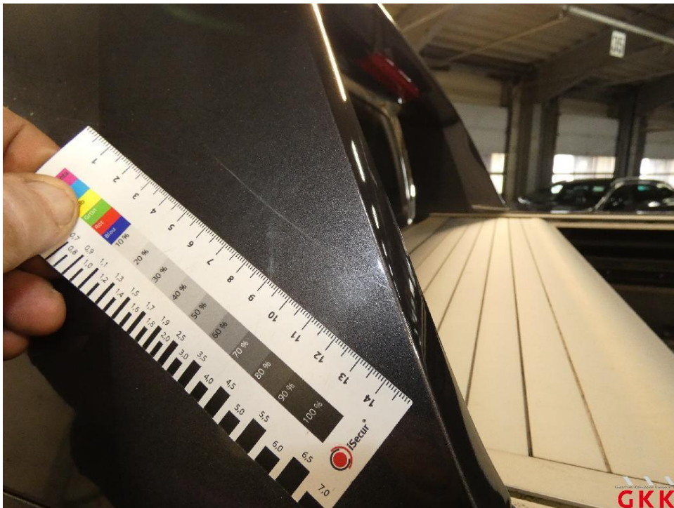
Bild 28 Blende/Spoiler hinten, verkratzt, Smartrepair
