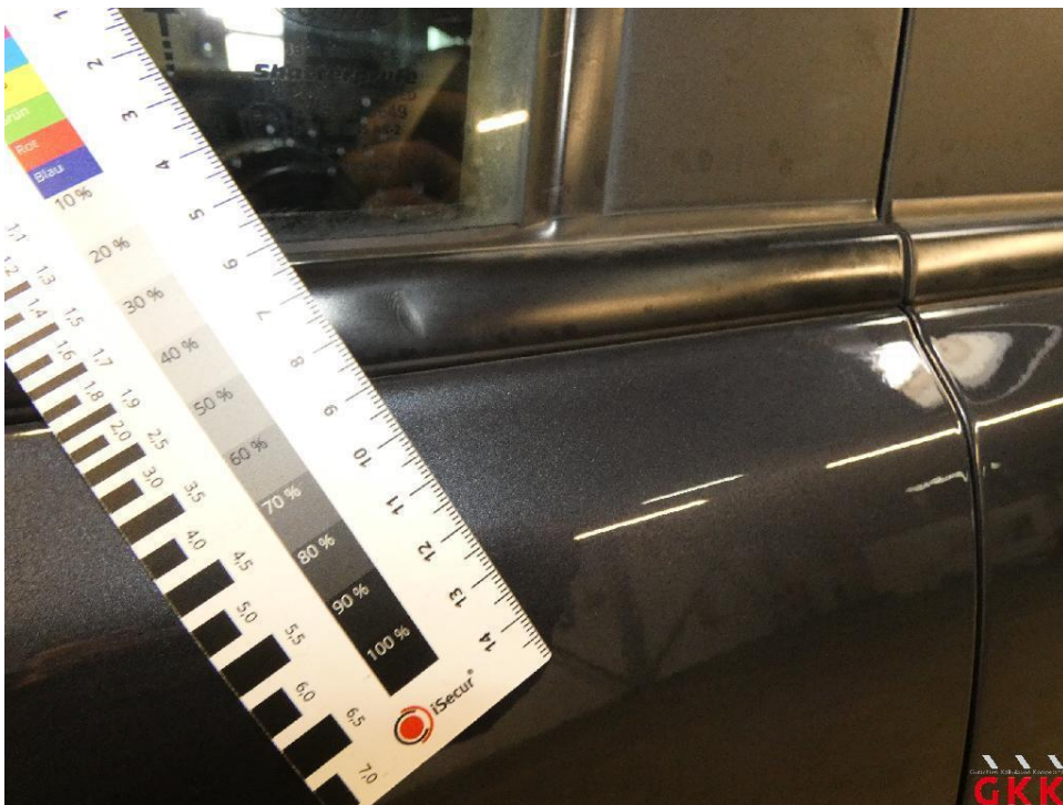
Bild 20 Tür vorne links, Schachtleiste -unlackiert-, beschädigt, ersetzen
