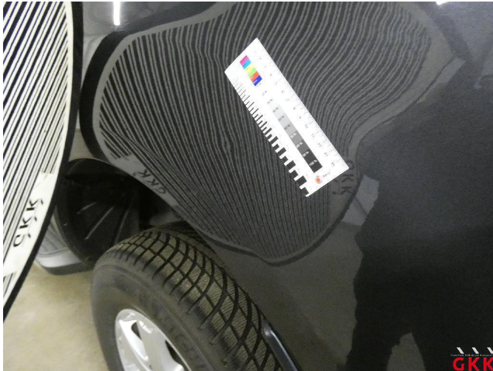
Bild 25 Seitenwand links, beschädigt, kalt drücken
