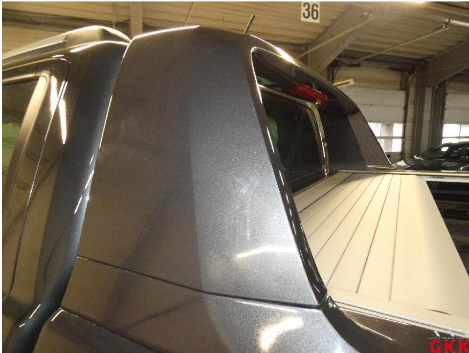
Bild 27 Blende/Spoiler hinten, verkratzt, Smartrepair
