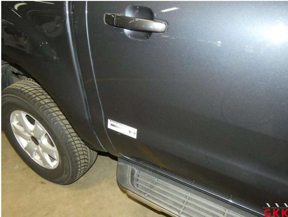
Bild 29 Tür hinten rechts, verkratzt, lackieren
