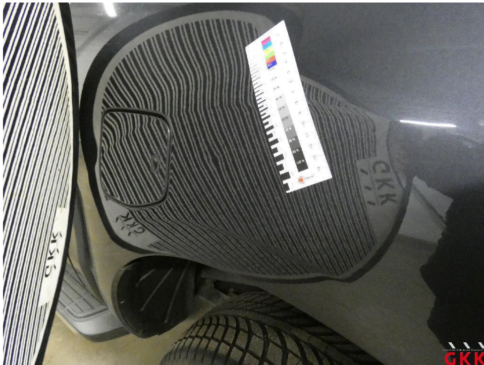
Bild 26 Seitenwand links, beschädigt, kalt drücken
