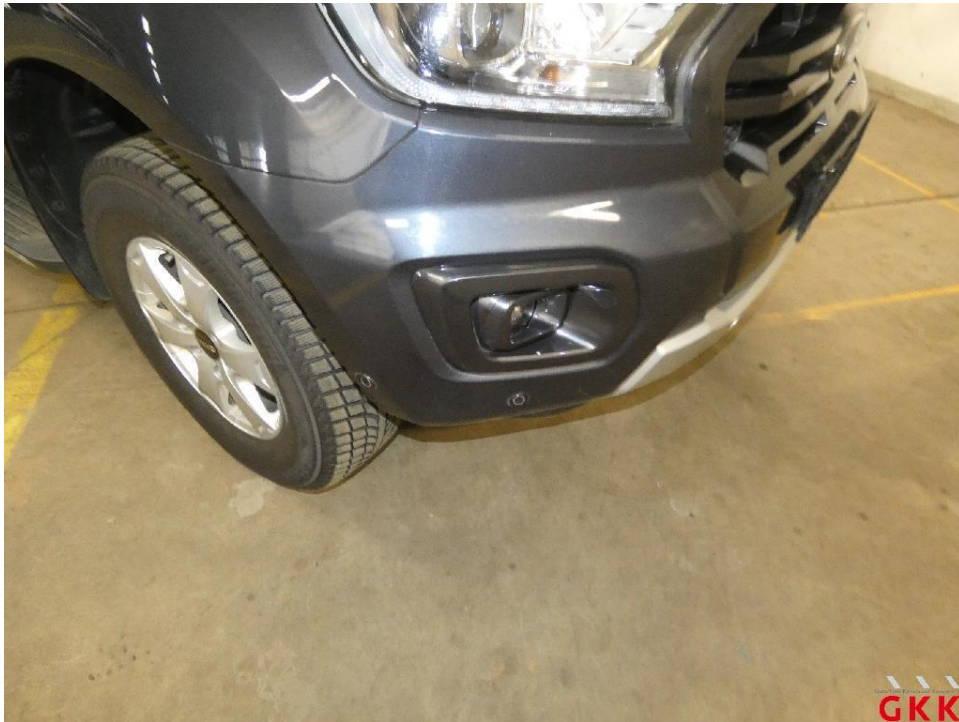
Bild 37 Stoßfänger vorne, Ecke rechts -lackiert-, verkratzt, Spotlackieren
