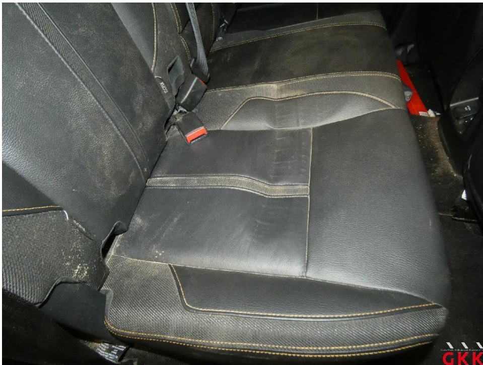
Bild 34 Sitzbank hinten, Bezug Sitzkissen -Teilleder-, Druckstellen, ersetzen
