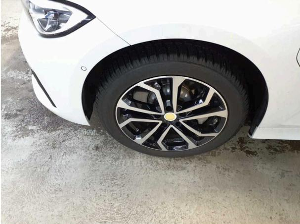
**Beschädigung #2:** Rad/Reifen: Reifen vorn - verschlissen - kein Abzug
