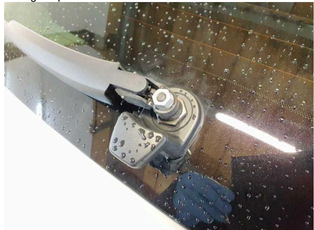
**Beschädigung #4:** Scheibenreinigung: Scheibenwischerarm hinten (Abdeckung fehlt) - erneuern
