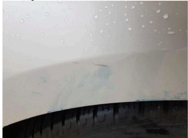
**Beschädigung #3:** Seitenwand rechts: Seitenwand - Kratzer - auslegen / polieren
