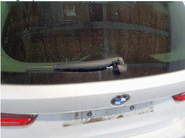
**Beschädigung #4:** Scheibenreinigung: Scheibenwischerarm hint... (Abdeckung fehlt) - erneuern
