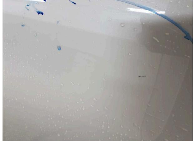
**Beschädigung #5:** Tür hinten rechts: Tür - Kratzer - instandsetzen und lackieren
