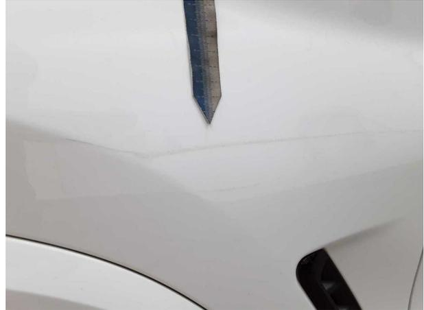
**Beschädigung #2:** Kotflügel links: Kotflügel links - Abrieb - auslegen / polieren
