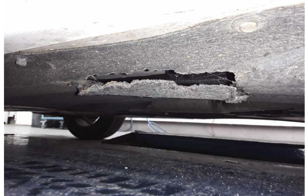
**Beschädigung #7:** Karosserie: Unterbodenverkleidung -
