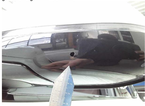
**Beschädigung #8:** Außenspiegel links: Spiegelgehäuse -
