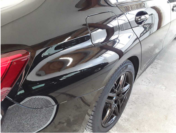
Domage #7: Panneau latéral arrière droit: Paroi latérale - bosse(s) - Réparer et repeindre
