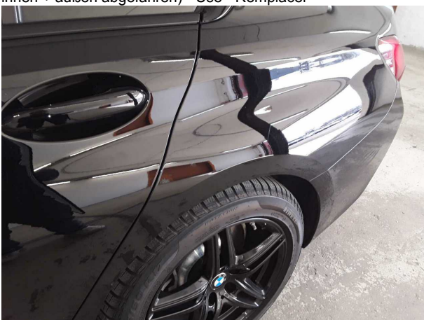
Domage #6: Panneau latéral arrière gauche: Paroi latérale - Rayure(s) - Peinture
