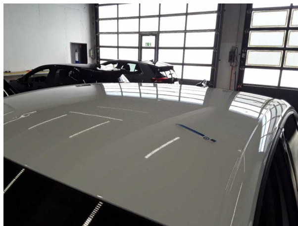
Domage #6: Toit: Toit (Hagelschaden, ca. 80 Dellen) - bosse(s) - Réparer et repeindre
