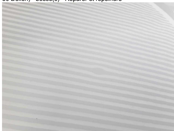
Dommage #5: Capot moteur: Capot moteur (Hagelschaden c... 50 Dellen) - bosse(s) - Réparer et repeindre
