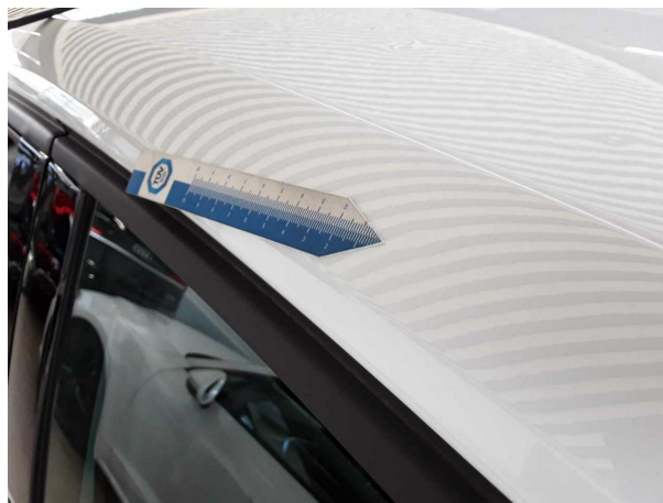
Domage #1: Toit: Rail de toit gauche - bosse(s) - Bon travail de réparation
