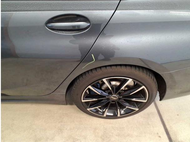
**Beschädigung #5:** Seitenwand links: Seitenwand - Kratzer - auslegen / polieren
