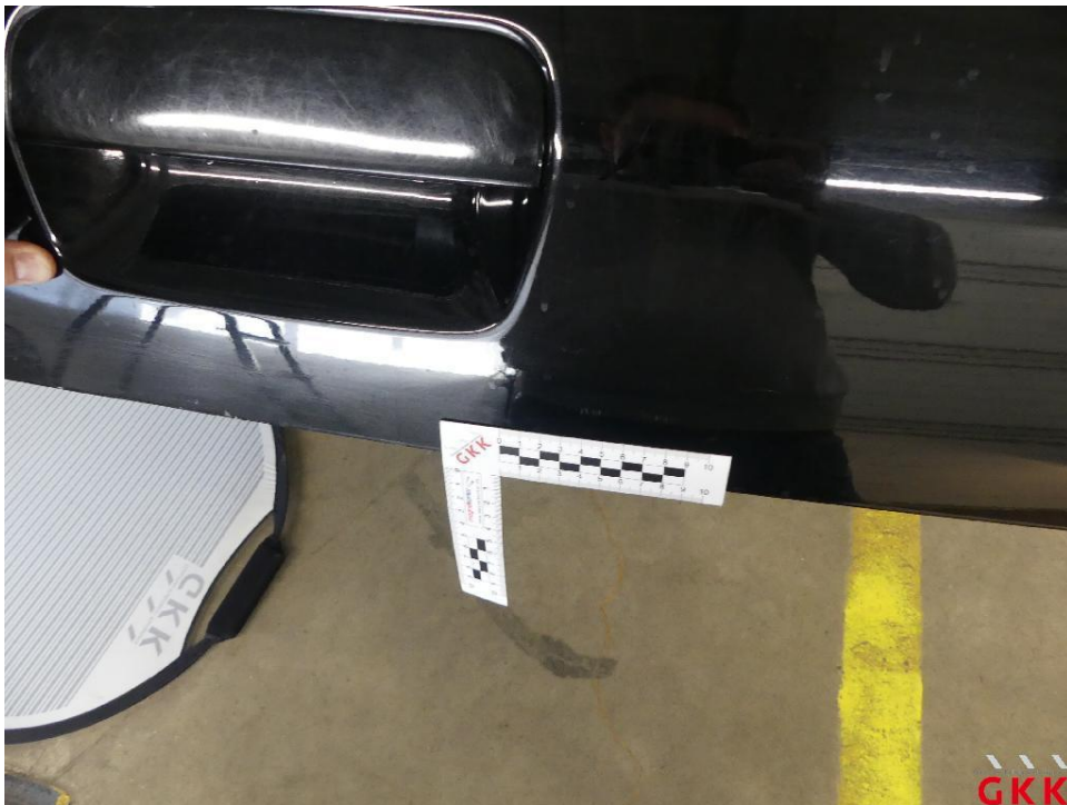
Bild 24 Heckklappe, verkratzt, lackieren
