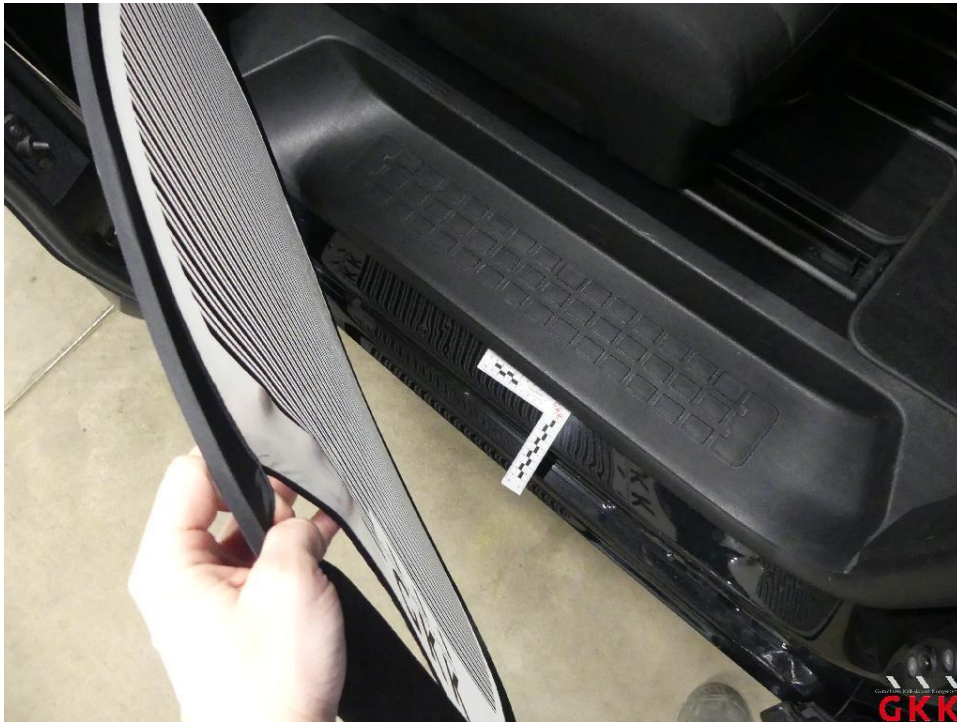
Bild 21 Schiebetür rechts, Einstieg, beschädigt, Smartrepair
