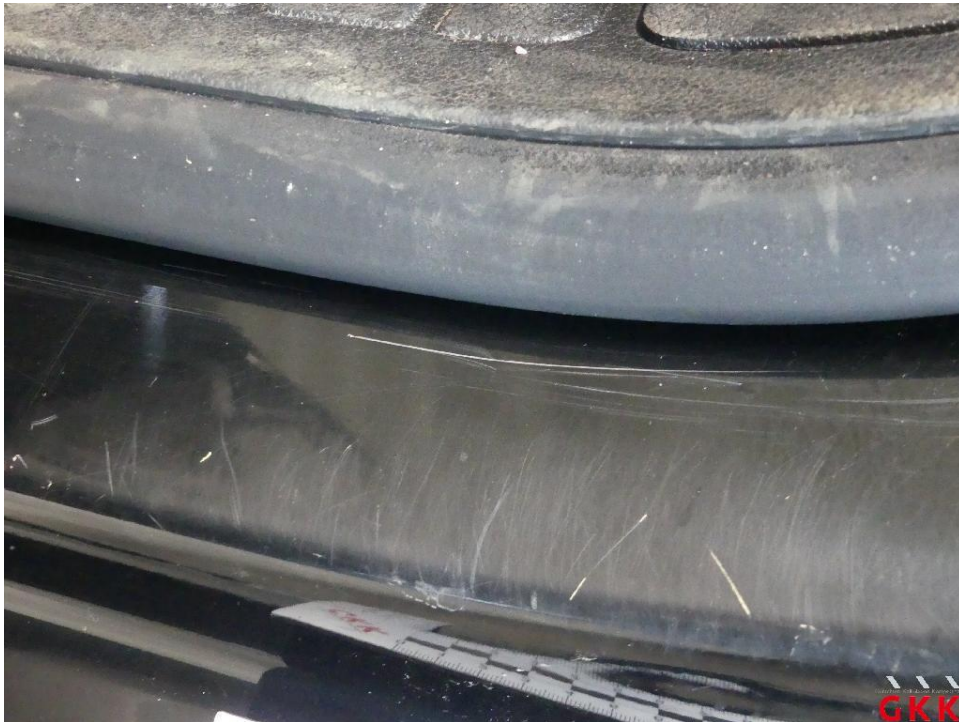
Bild 29 Tür vorne links, Einstieg, verkratzt, Smartrepair
