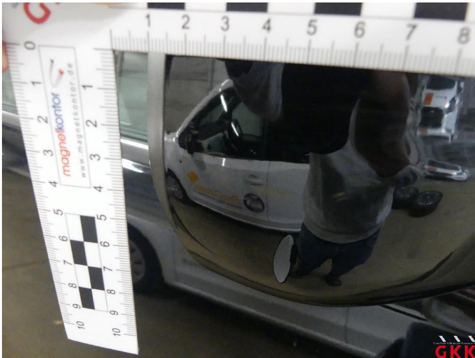
Bild 16 Spiegelgehäuse rechts, Kappe -lackiert-, verkratzt, lackieren
