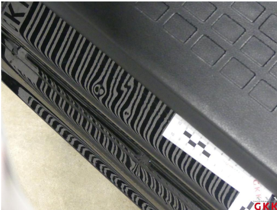
Bild 22 Schiebetür rechts, Einstieg, beschädigt, Smartrepair
