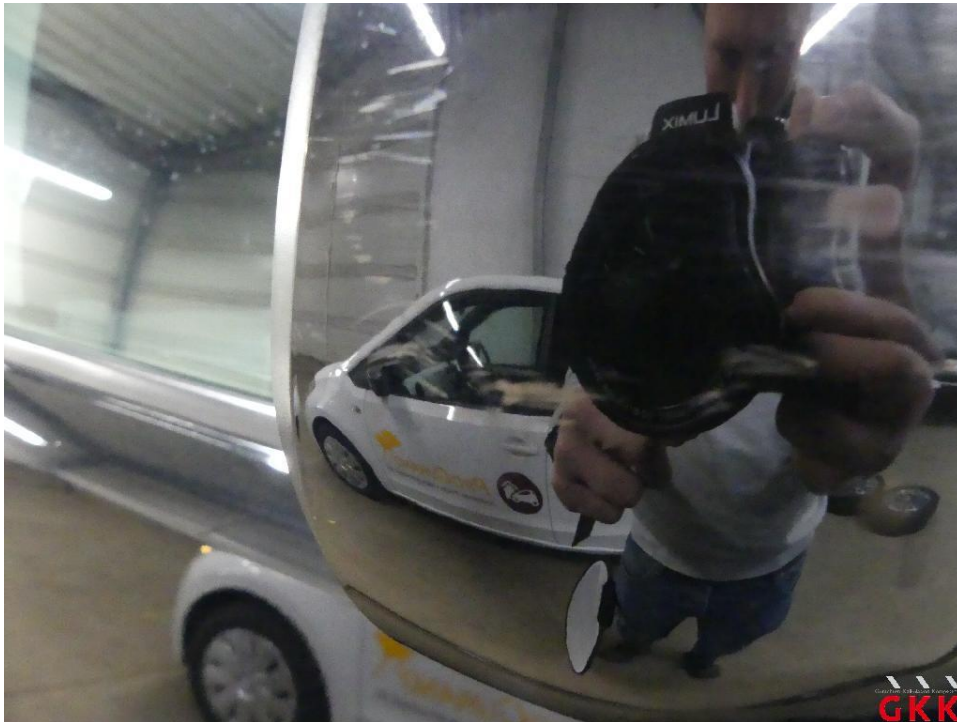
Bild 17 Spiegelgehäuse rechts, Kappe -lackiert-, verkratzt, lackieren
