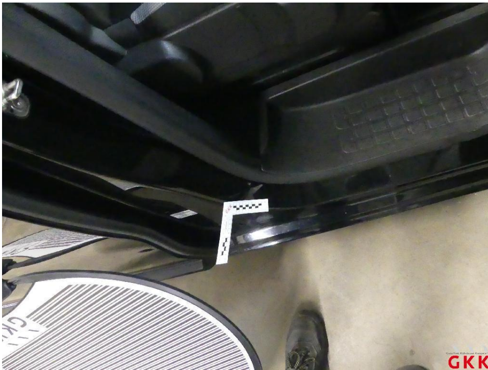
Bild 18 Tür vorne rechts, Einstieg, verkratzt, Smartrepair
