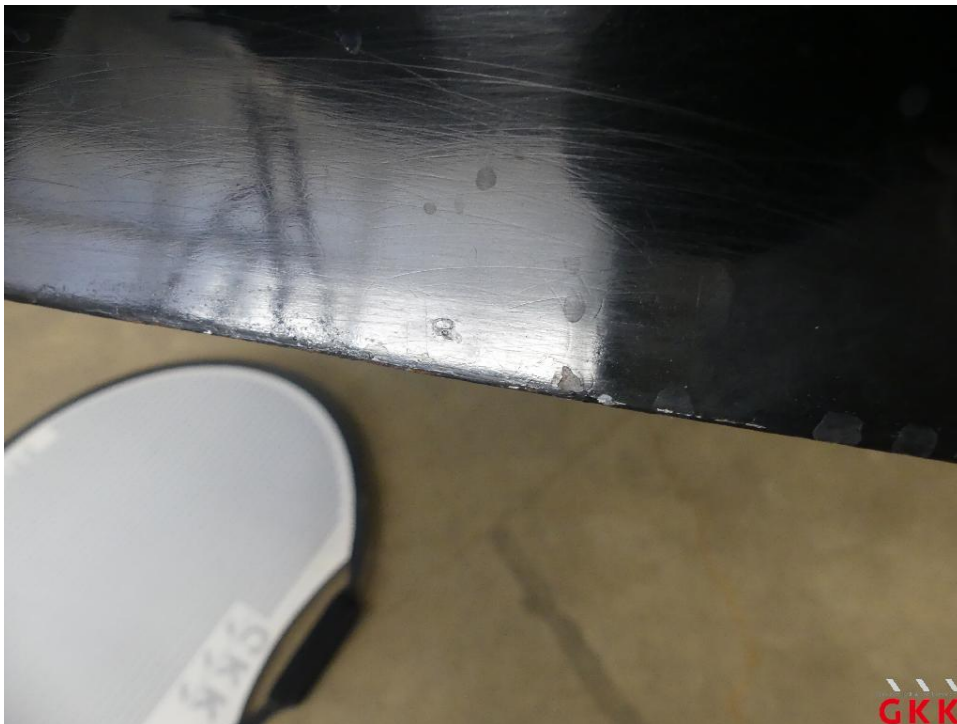
Bild 26 Heckklappe, verkratzt, lackieren
