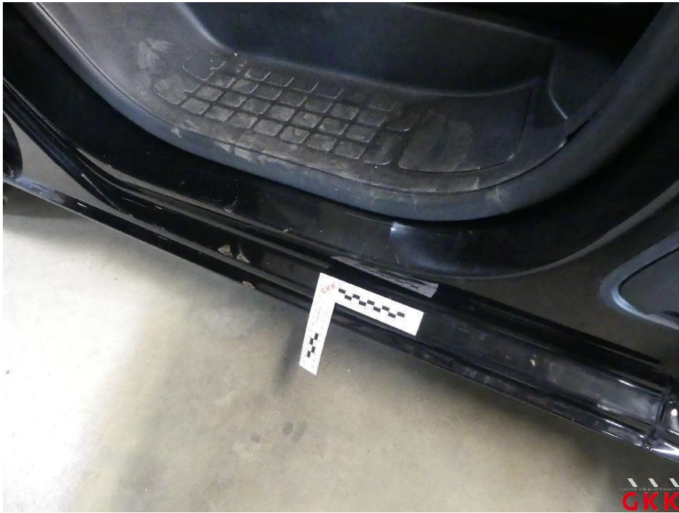
Bild 27 Tür vorne links, Einstieg, verkratzt, Smartrepair
