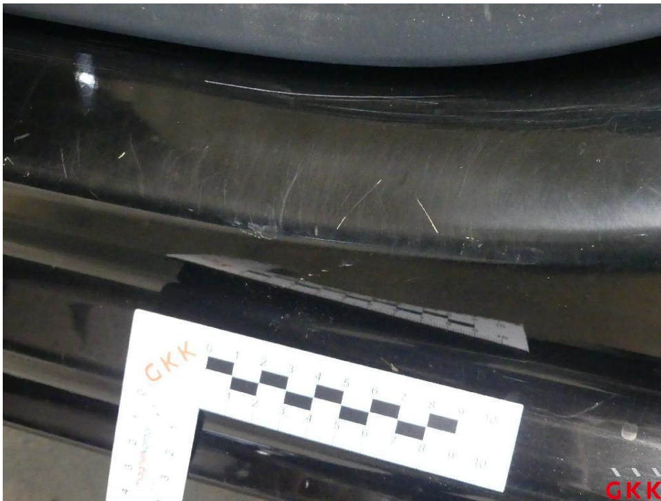
Bild 28 Tür vorne links, Einstieg, verkratzt, Smartrepair
