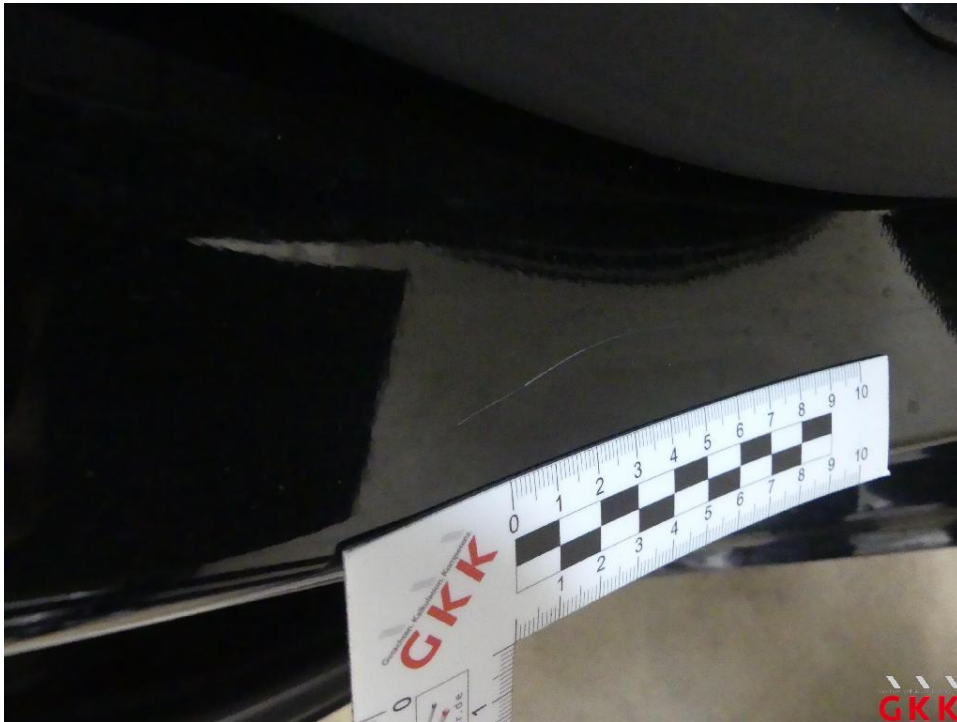
Bild 19 Tür vorne rechts, Einstieg, verkratzt, Smartrepair
