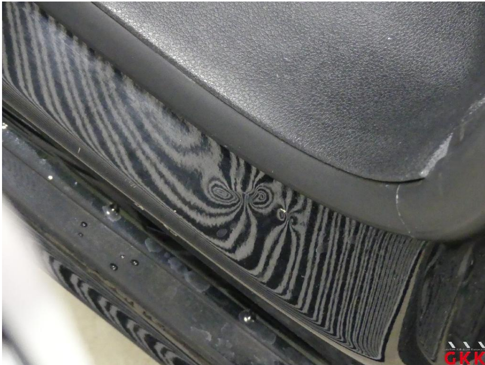
Bild 23 Schiebetür rechts, Einstieg, beschädigt, Smartrepair
