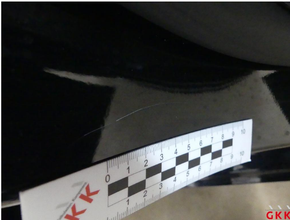
Bild 20 Tür vorne rechts, Einstieg, verkratzt, Smartrepair
