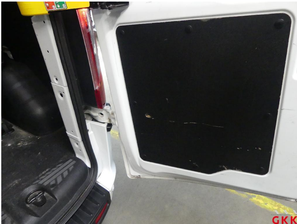
Bild 26 Hecktür rechts, Innenverkleidung -Abdeckung-, beschädigt, ersetzen
