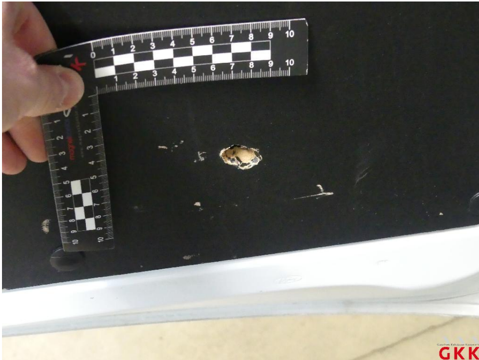
Bild 25 Hecktür links, Innenverkleidung -Abdeckung-, beschädigt, ersetzen
