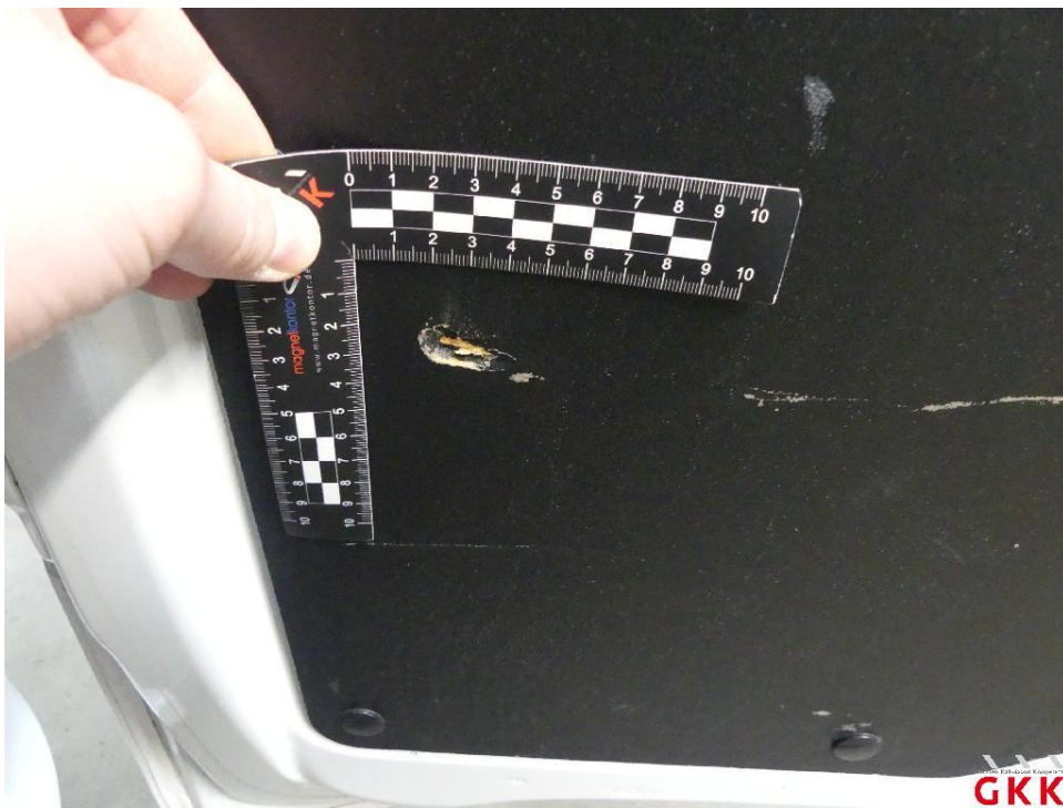
Bild 28 Hecktür rechts, Innenverkleidung -Abdeckung-, beschädigt, ersetzen
