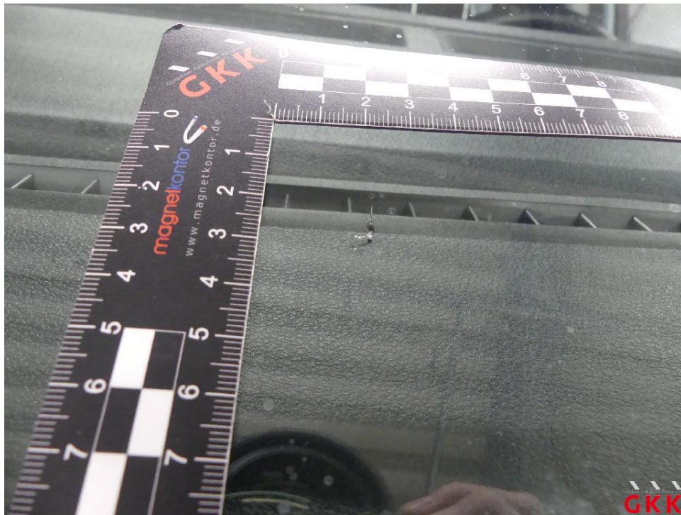
Bild 20 Frontscheibe, beheizt mit Regensensor, Steinschlag mit Rissbildung, instand setzen
