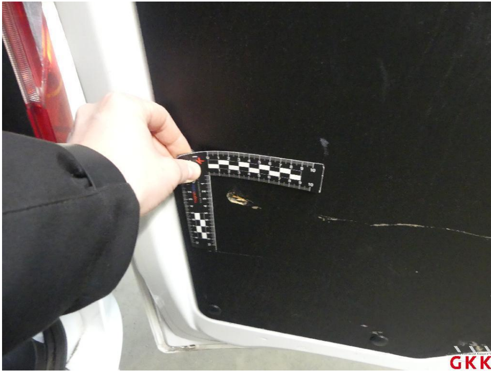
Bild 27 Hecktür rechts, Innenverkleidung -Abdeckung-, beschädigt, ersetzen
