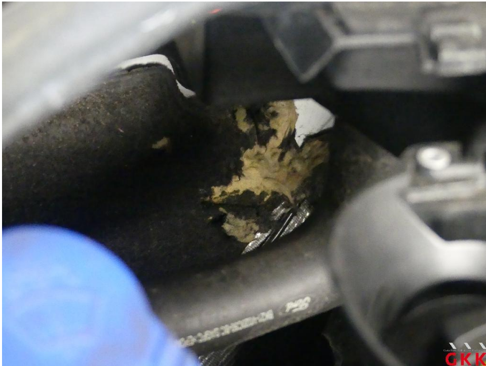
Bild 17 Motorraum, Dämmmatte, beschädigt, ersetzen
