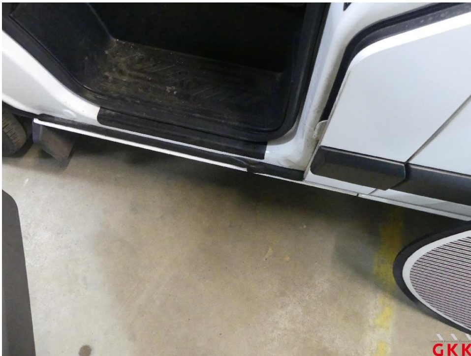
Bild 36 Tür vorne links, Dichtung -Einstieg-, lose, ersetzen
