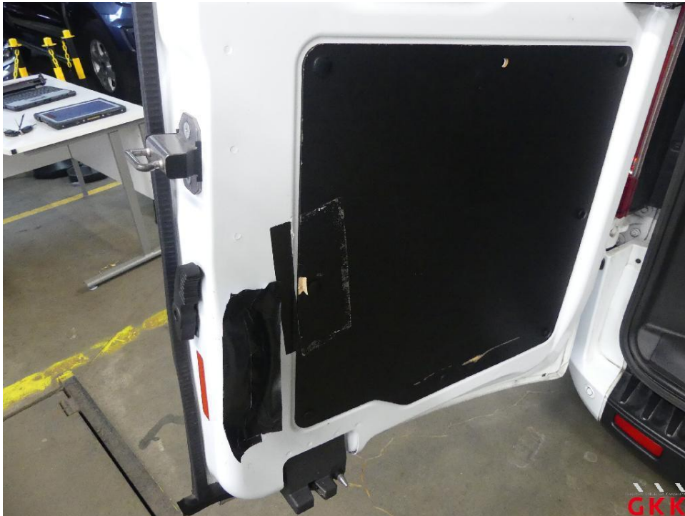
Bild 27 Hecktür links, Innenverkleidung -Abdeckung-, beschädigt, ersetzen
