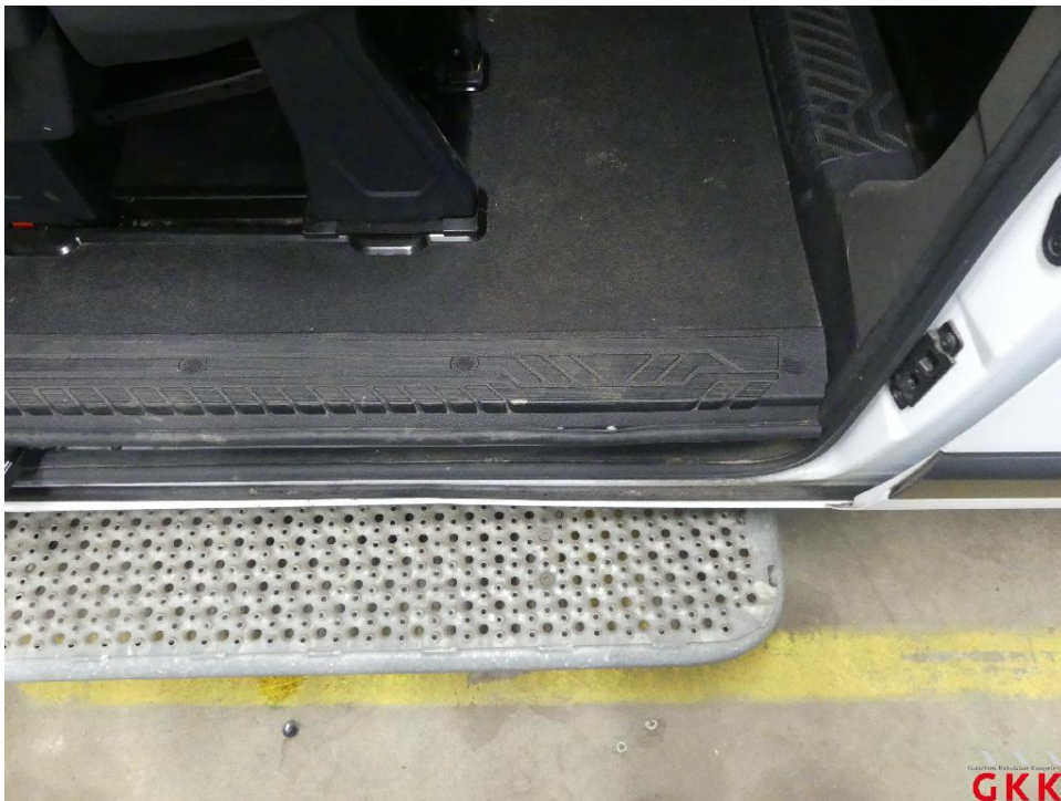
Bild 22 Schiebetür rechts, Dichtung -Einstieg-, lose, ersetzen
