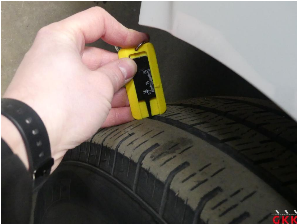
Bild 39 Reifen, vorn links und rechts, Untermaß, ersetzen
