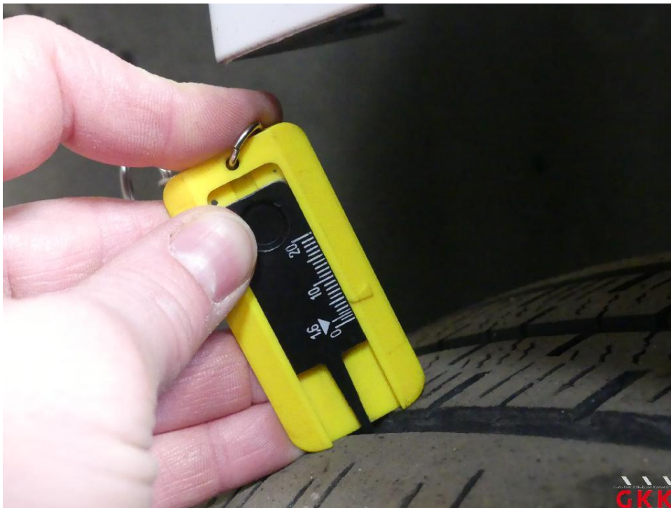
Bild 40 Reifen, vorn links und rechts, Untermaß, ersetzen
