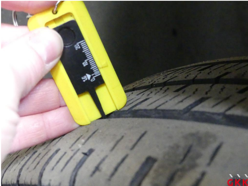
Bild 41 Reifen, vorn links und rechts, Untermaß, ersetzen
