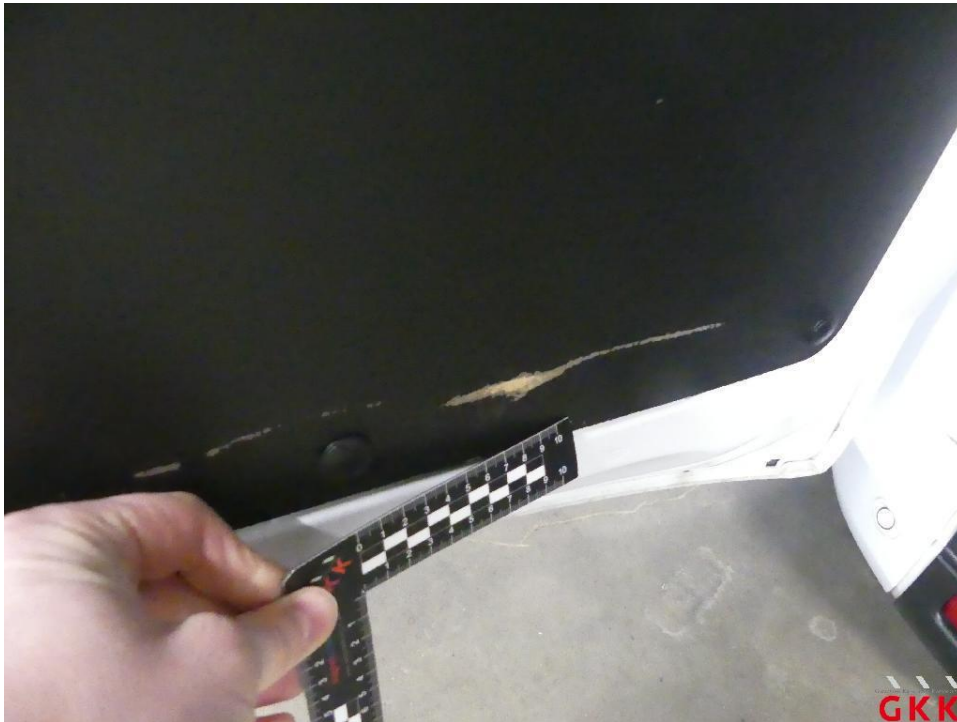
Bild 29 Hecktür links, Innenverkleidung -Abdeckung-, beschädigt, ersetzen
