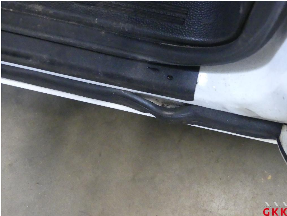
Bild 37 Tür vorne links, Dichtung -Einstieg-, lose, ersetzen
