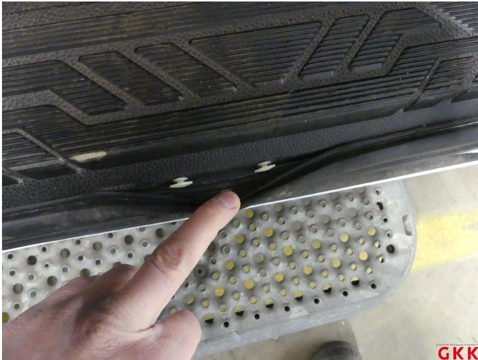
Bild 23 Schiebetür rechts, Dichtung -Einstieg-, lose, ersetzen
