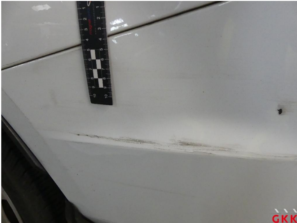
Bild 31 Stoßfänger hinten, Ecke links -lackiert-, verkratzt, lackieren
