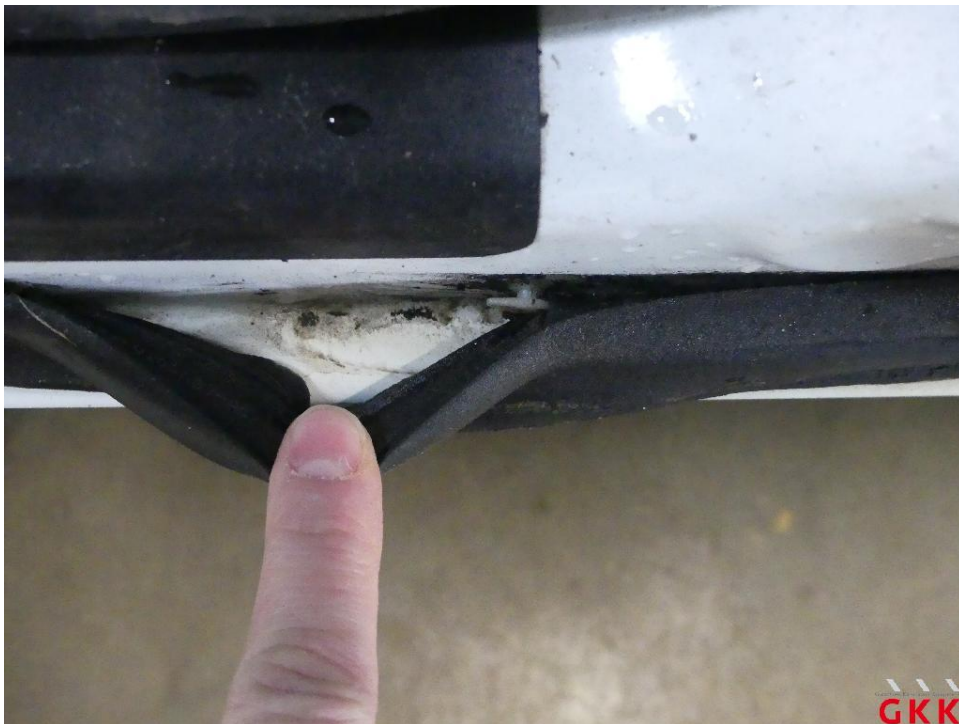
Bild 38 Tür vorne links, Dichtung -Einstieg-, lose, ersetzen
