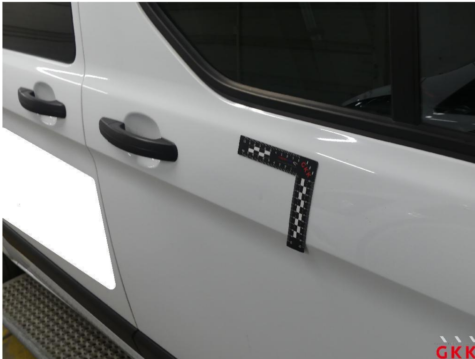
Bild 19 Tür vorne rechts, beschädigt, instand setzen - lackieren
