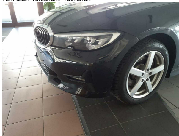
Beschädigung #5: Stossfänger vorn: Stossfänger vorn (inkl. Blende rechts erneuern) - verkratzt / verschürft - erneuern
