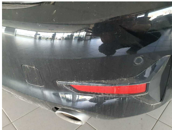
Beschädigung #4: Stossfänger hinten: Stossfänger hinten - verkratzt / verschürft - lackieren
