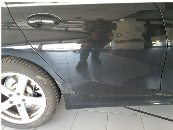
Beschädigung #1: Tür hinten rechts: Tür - verkratzt / verschürft - lackieren
