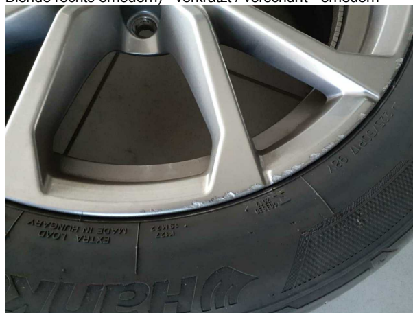
Beschädigung #6: 2.Radsatz: 3 Leichtmetallfelgen (Materialabrieb) - verkratzt / verschürft - erneuern
