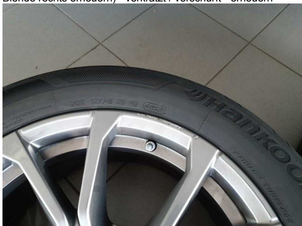
Beschädigung #6: 2.Radsatz: 3 Leichtmetallfelgen (Materialabrieb) - verkratzt / verschürft - erneuern
