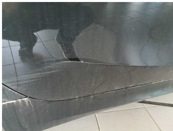
Beschädigung #1: Tür hinten rechts: Tür - verkratzt / versch... - lackieren
