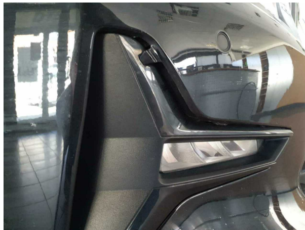
Beschädigung #5: Stossfänger vorn: Stossfänger vorn (inkl. Blende rechts erneuern) - verkratzt / verschürft - erneuern
