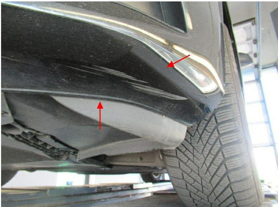
Bild 18 : Stoßfänger vorne unten Lackierung, zerkratzt, smart repair
