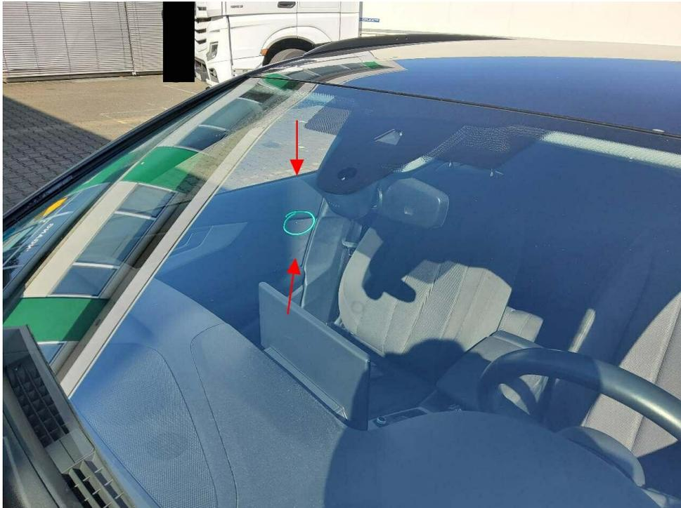
Bild 17 : Frontscheibe, Steinschlag, Gebrauchsspur (Abplatzer) F-Scheibe I.O
