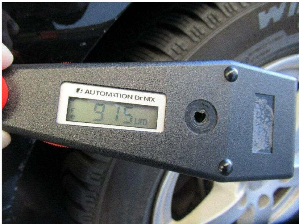
Bild 22 : Seitenteil Radlauf hinten links Nachlackiert.
