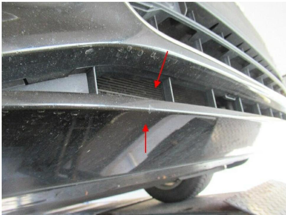
Bild 19 : Stoßfänger vorne unten Lackierung, zerkratzt, smart repair
