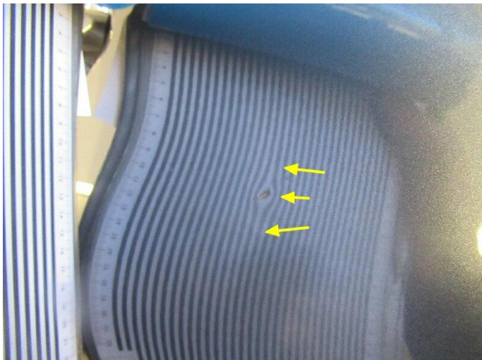
Bild 18 : Tür hinten rechts deformiert
