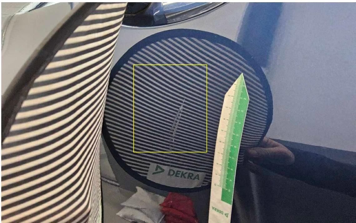
Bild 30 : Tür vorne rechts Lackierung, zerkratzt, lackieren mit Lackaufbau
