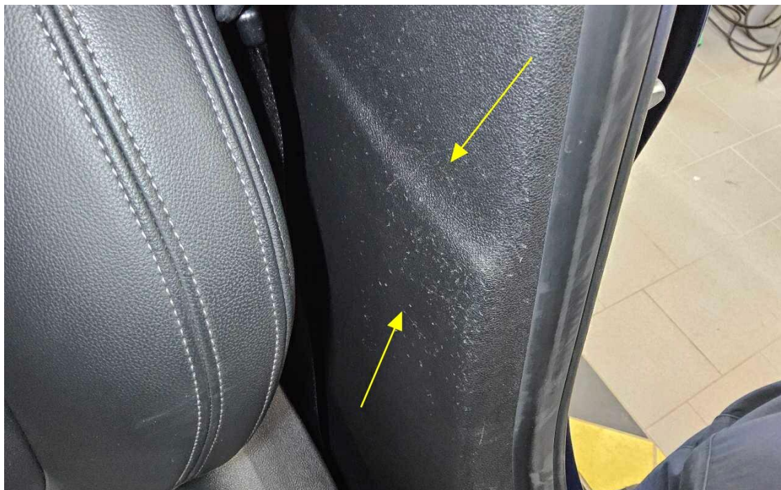
Bild 16 : Verkleidung B-Säule links, verschrammt, Gebrauchsspur
