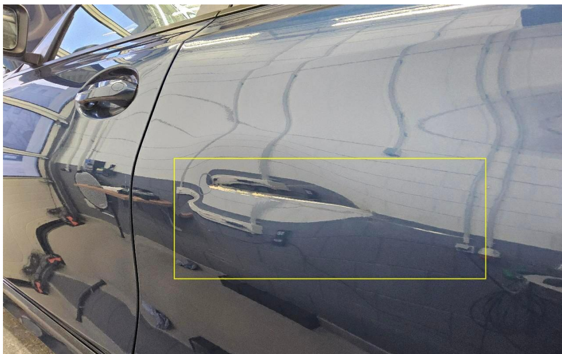
Bild 26 : Tür hinten links verformt und verschrammt
