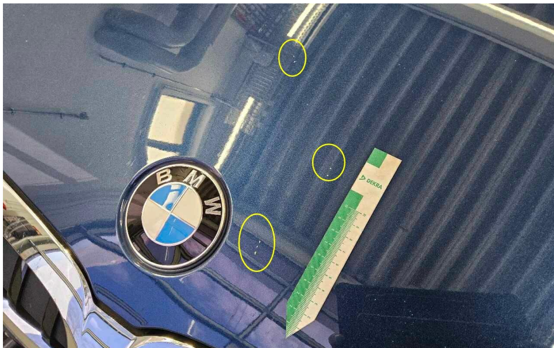
Bild 25 : Motorhaube Lackierung, Steinschlag, Gebrauchsspur
