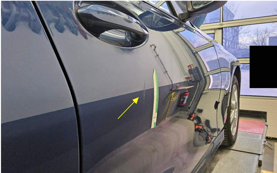
Bild 29 : Tür vorne rechts Lackierung, zerkratzt, lackieren mit Lackaufbau
