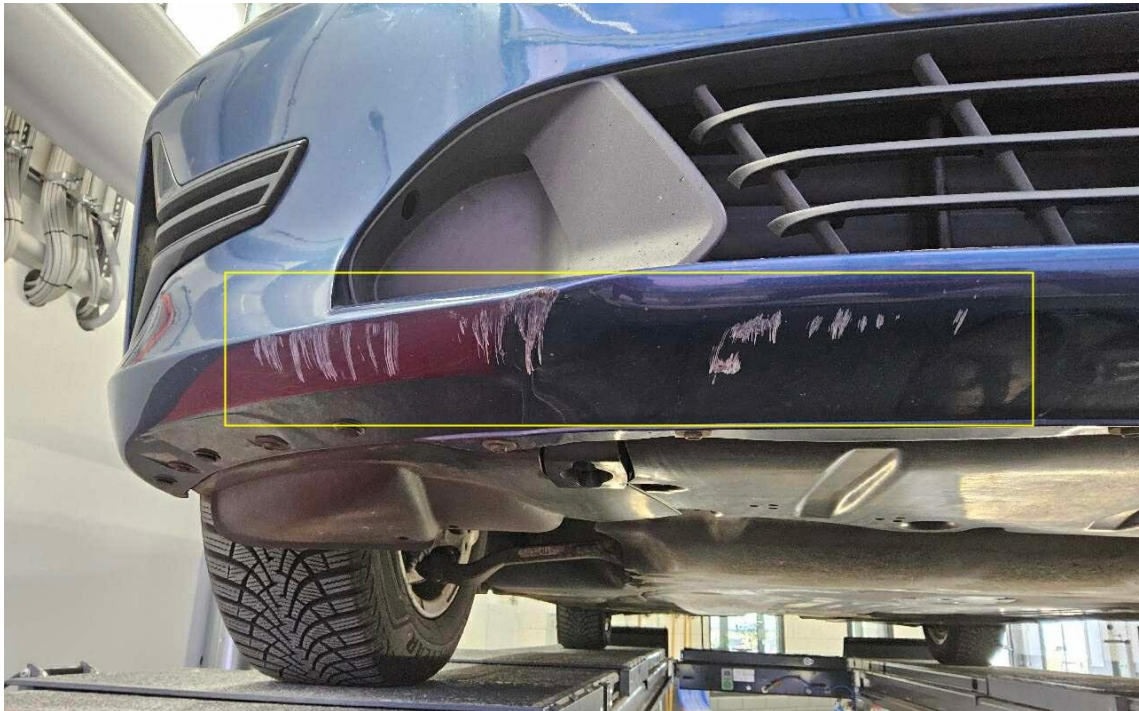
Bild 31 : Frontspoiler Lackierung, verschrammt, lackieren mit Lackaufbau
