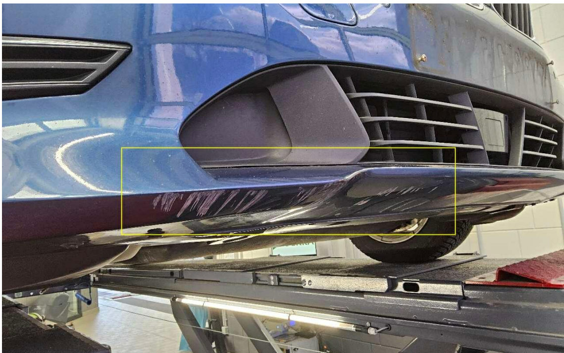
Bild 32 : Frontspoiler Lackierung, verschrammt, lackieren mit Lackaufbau
