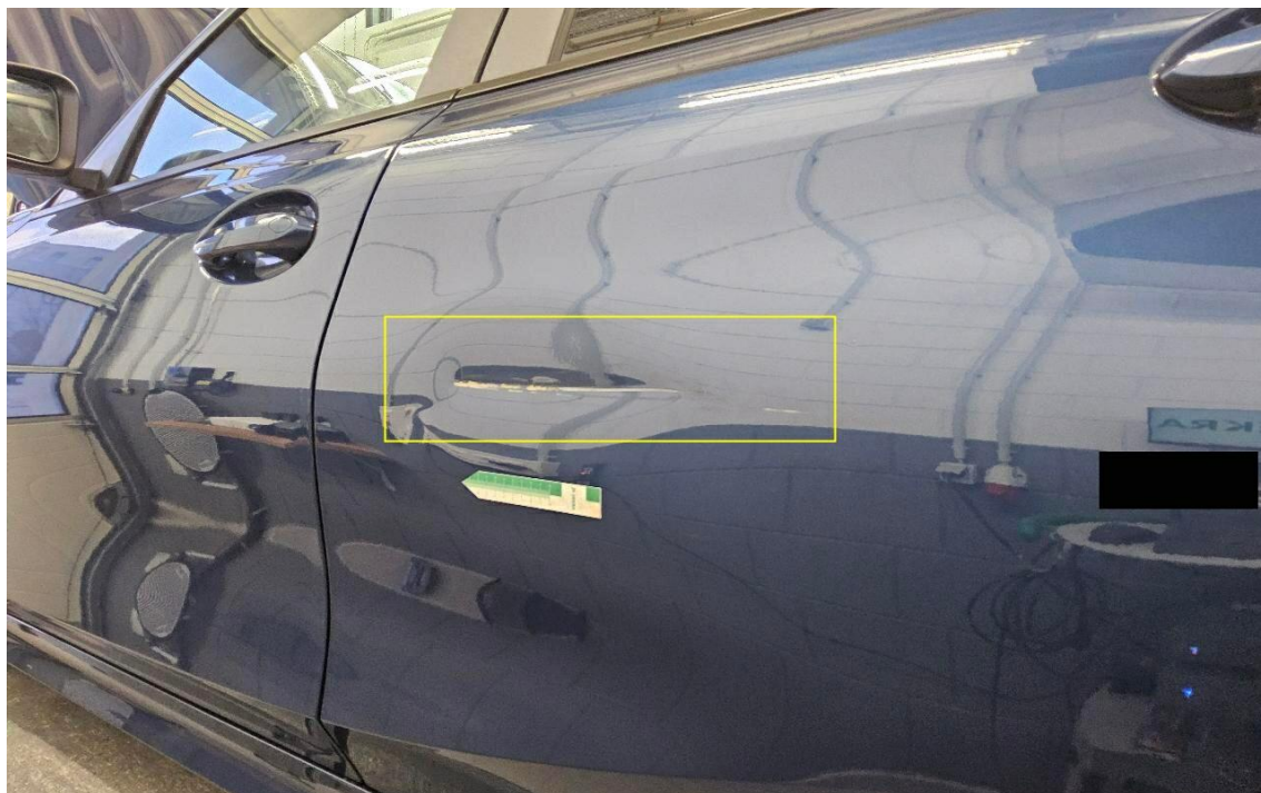
Bild 27 : Tür hinten links verformt und verschrammt
