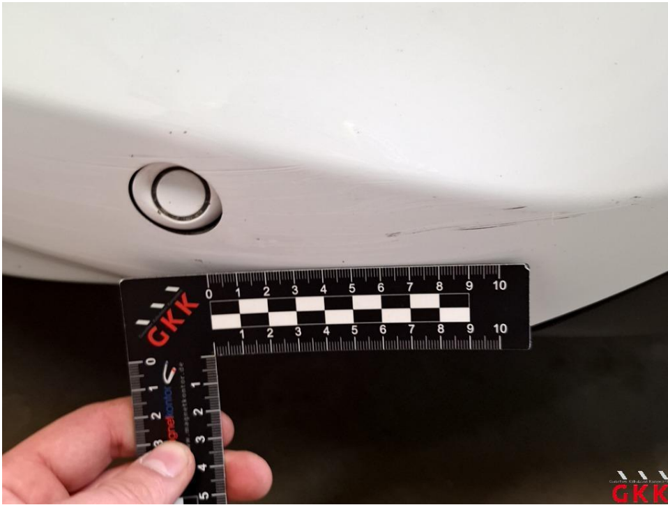
Bild 21 Stoßfänger vorne, Verkleidung -lackiert-, verkratzt, Spotlackieren
