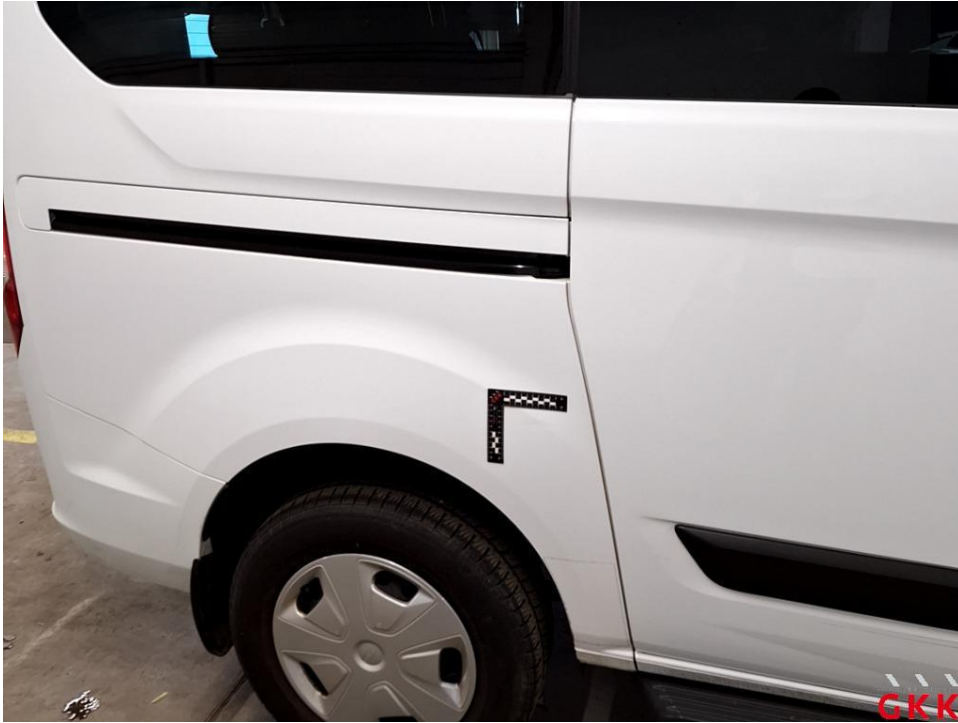
Bild 41 Seitenwand rechts, beschädigt, instand setzen - lackieren
