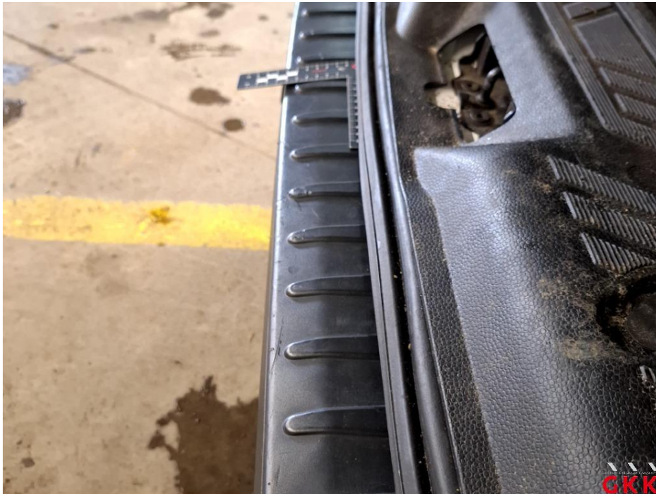
Bild 49 Stoßfänger hinten, Verkleidung -unlackiert-, beschädigt, ersetzen
