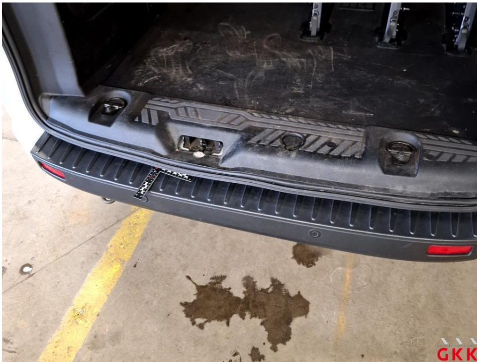
Bild 48 Stoßfänger hinten, Verkleidung -unlackiert-, beschädigt, ersetzen
