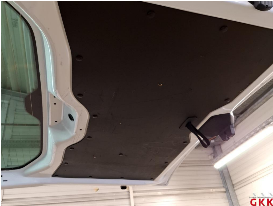
Bild 45 Heckklappe, Innenverkleidung, beschädigt, ersetzen
