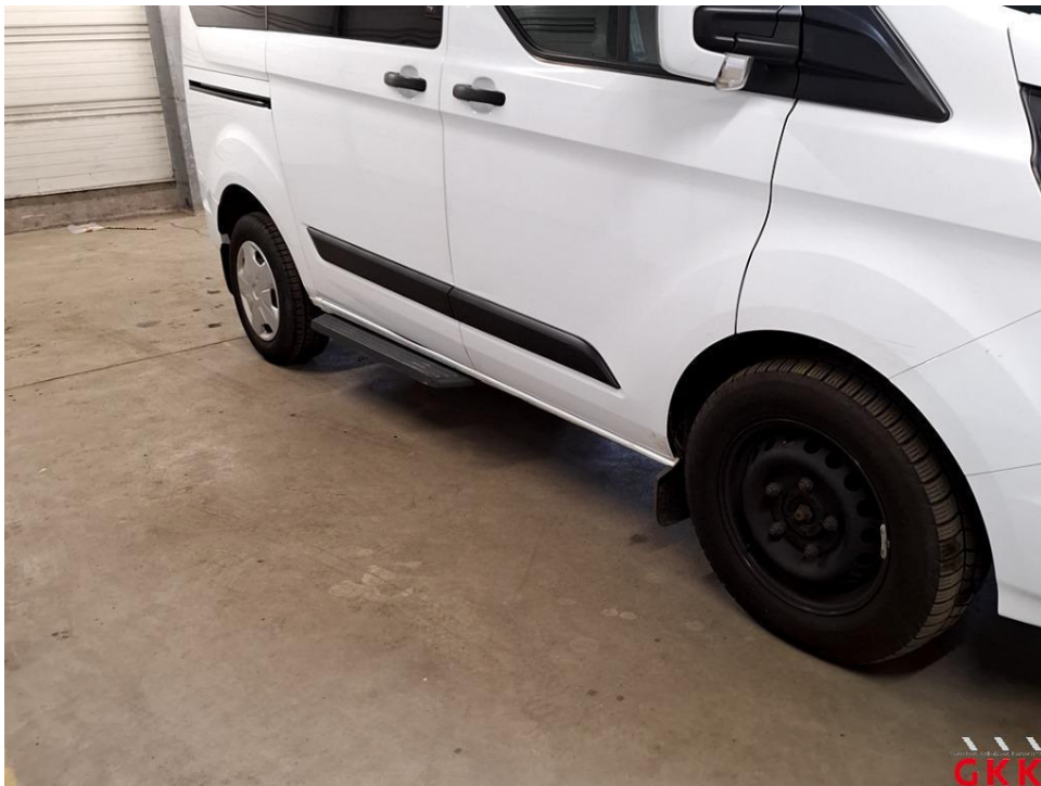
Bild 30 Radkappe(n), vorne rechts, fehlt, ersetzen
