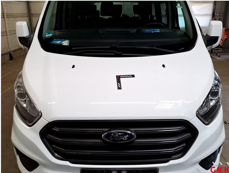
Bild 25 Motorhaube, Lackierung verwittert / matt, polieren
