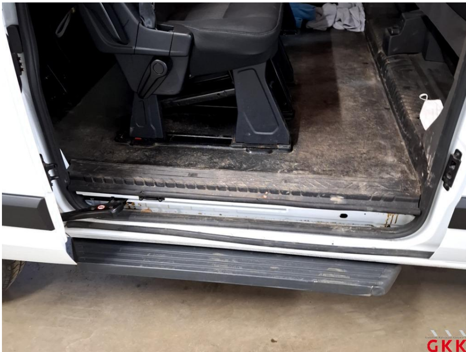
Bild 38 Schiebetür rechts, Dichtung -Einstieg-, beschädigt, ersetzen
