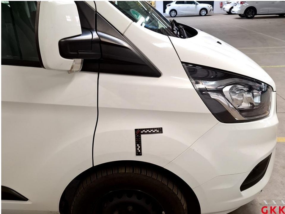
Bild 27 Kotflügel vorne rechts, verkratzt, polieren
