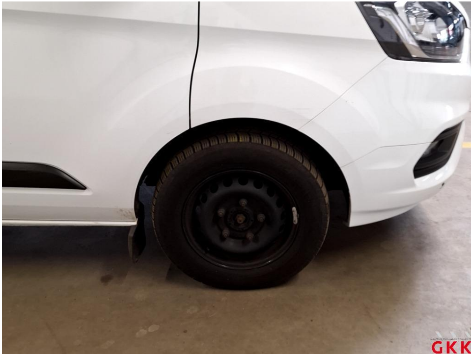
Bild 29 Radkappe(n), vorne rechts, fehlt, ersetzen
