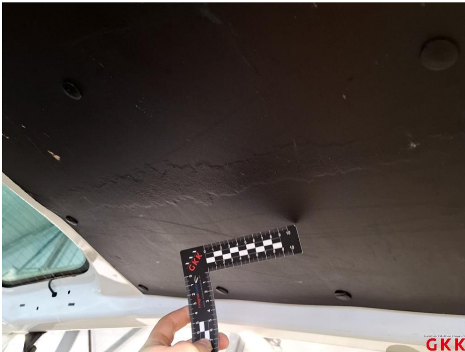
Bild 46 Heckklappe, Innenverkleidung, beschädigt, ersetzen
