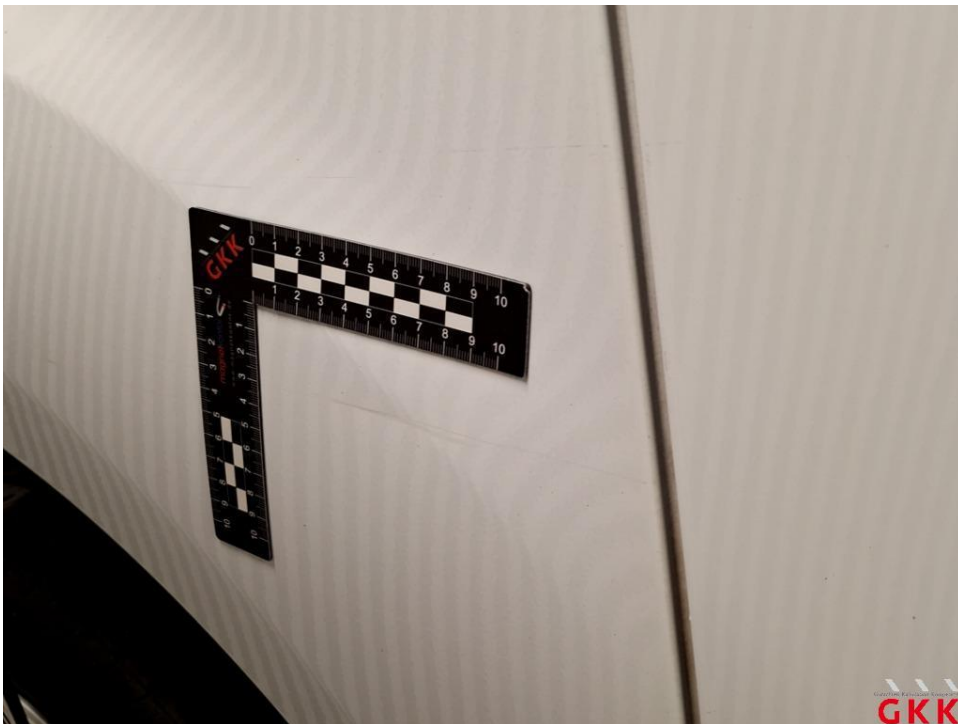
Bild 42 Seitenwand rechts, beschädigt, instand setzen - lackieren
