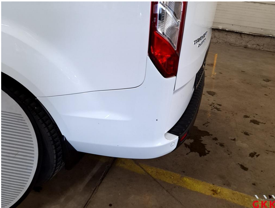
Bild 50 Stoßfänger hinten, Ecke links -lackiert-, verkratzt, auslegen, schleifen, polieren
