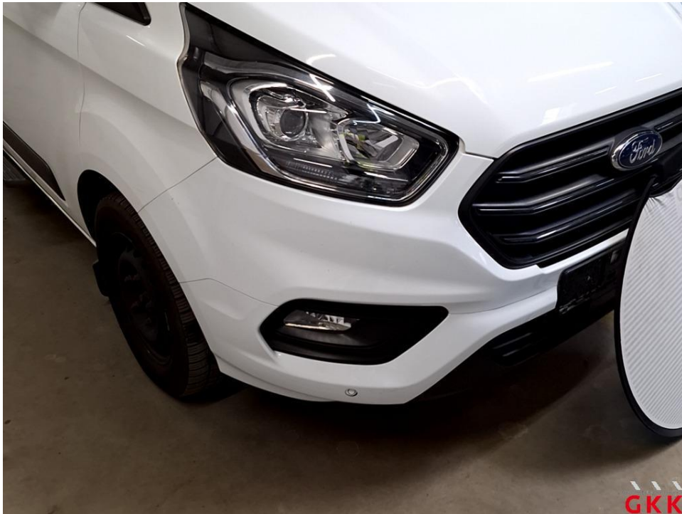
Bild 23 Stoßfänger vorne, PDC-Sensor, beschädigt, ersetzen
