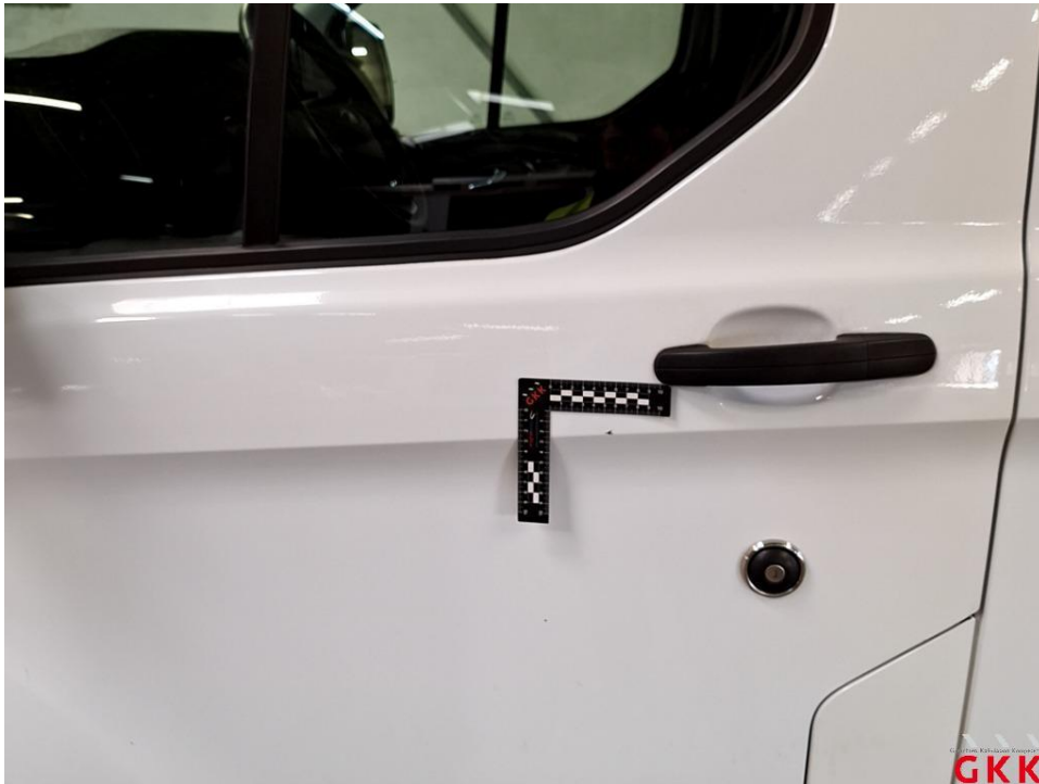
Bild 17 Tür vorne links, verkratzt, auslegen, schleifen, polieren
