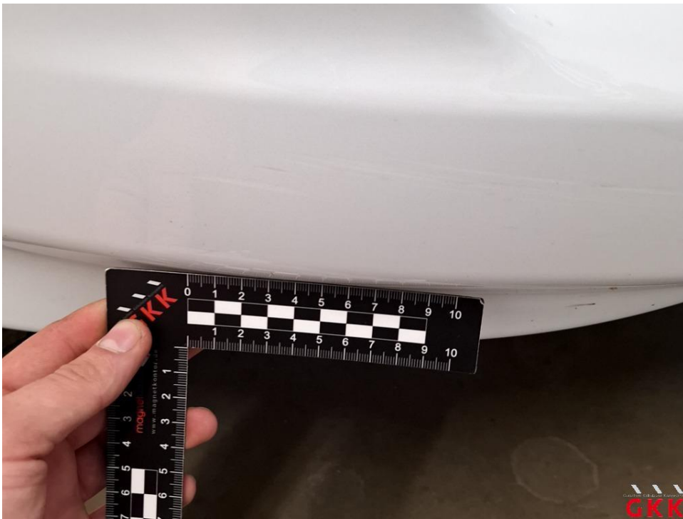
Bild 22 Stoßfänger vorne, Verkleidung -lackiert-, verkratzt, Spotlackieren
