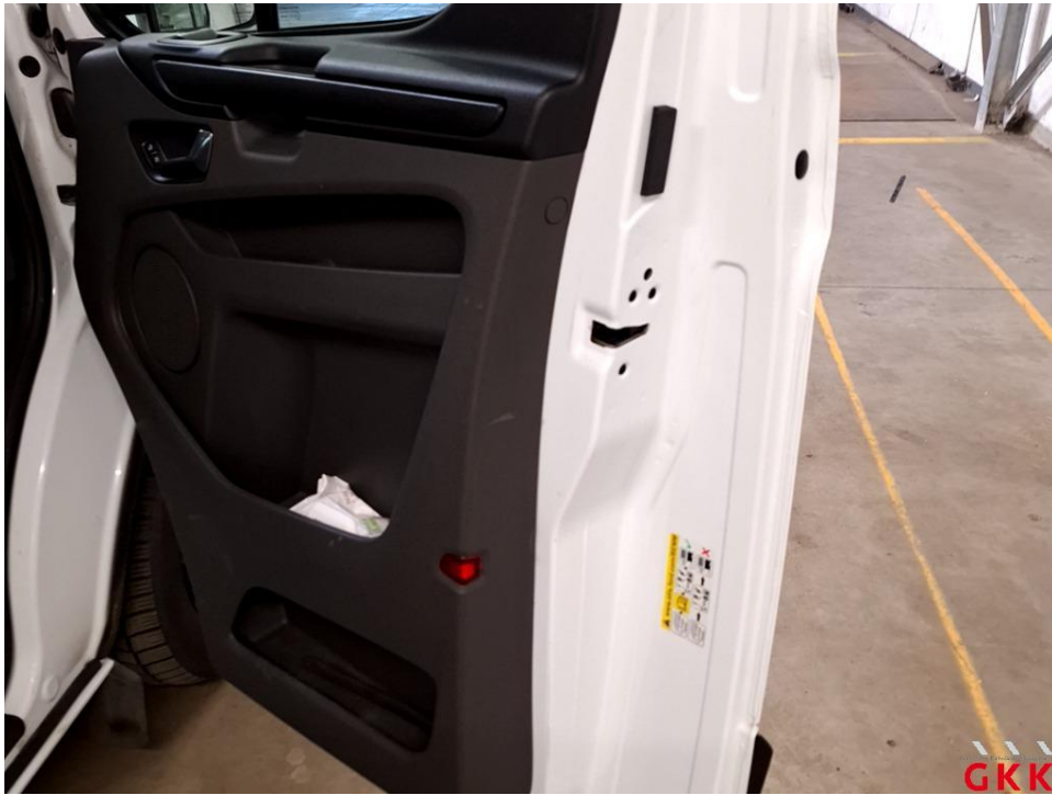
Bild 33 Tür vorne rechts, Innenverkleidung -Standard-, verkratzt, Smartrepair
