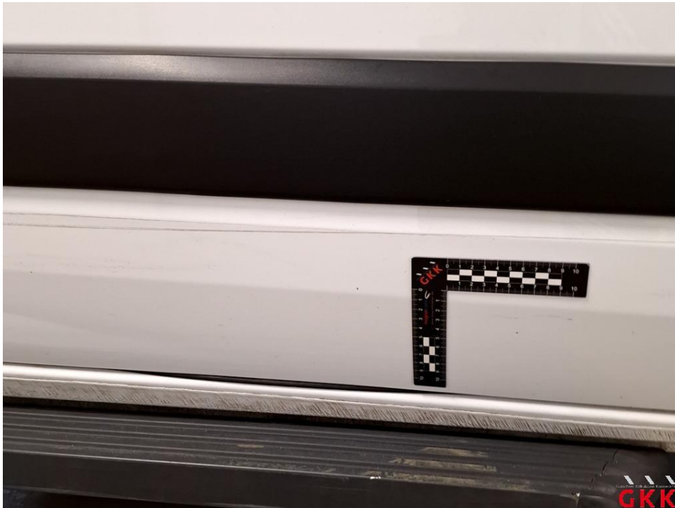
Bild 37 Schiebetür rechts, beschädigt, instand setzen - lackieren
