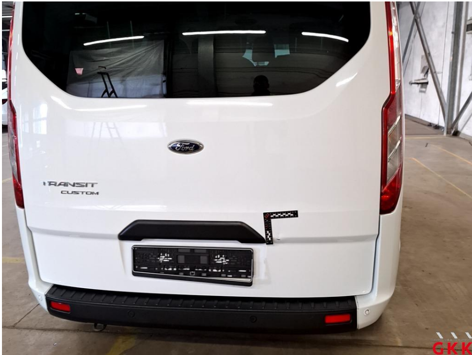
Bild 43 Heckklappe, beschädigt, instand setzen - lackieren
