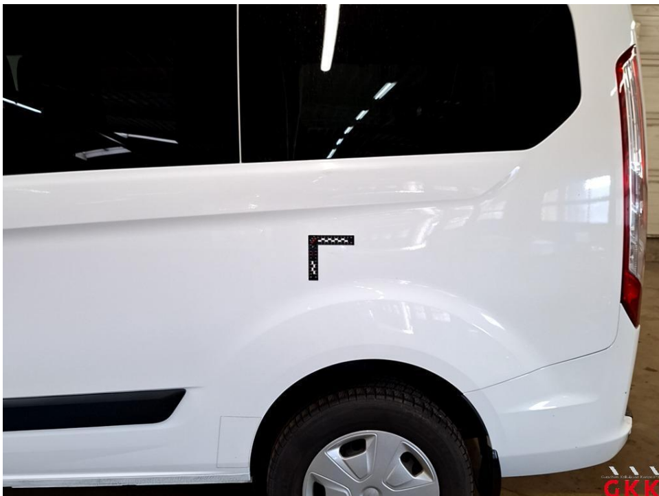
Bild 14 Seitenwand links, verkratzt, lackieren
