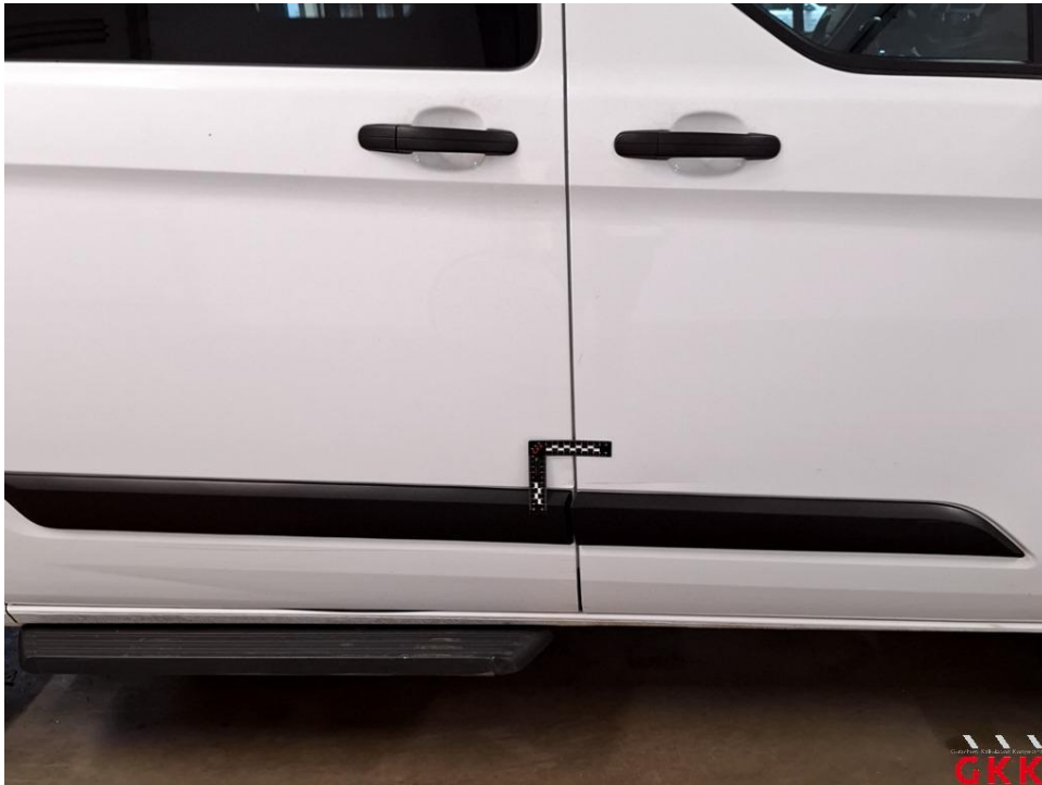
Bild 35 Schiebetür rechts, beschädigt, instand setzen - lackieren
