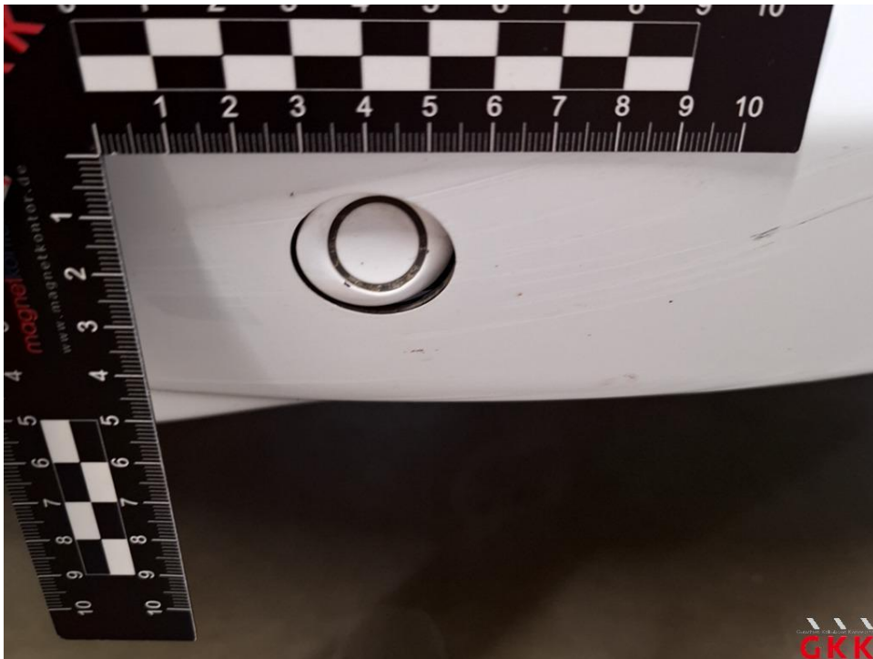
Bild 24 Stoßfänger vorne, PDC-Sensor, beschädigt, ersetzen
