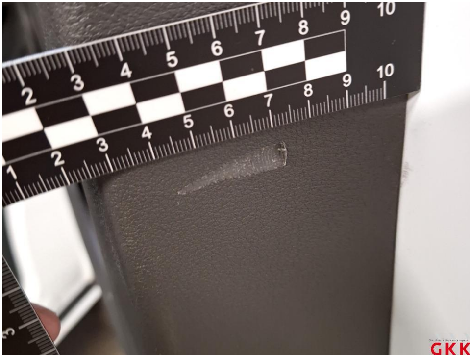
Bild 34 Tür vorne rechts, Innenverkleidung -Standard-, verkratzt, Smartrepair
