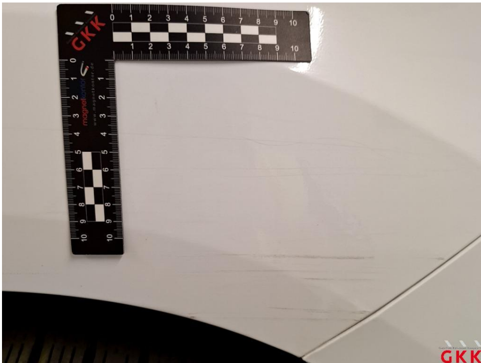
Bild 28 Kotflügel vorne rechts, verkratzt, polieren
