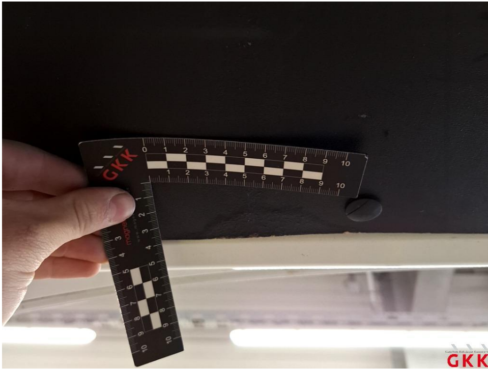
Bild 47 Heckklappe, Innenverkleidung, beschädigt, ersetzen
