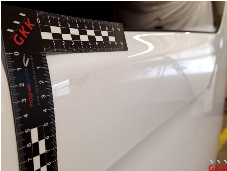
Bild 16 Seitenwand links, verkratzt, lackieren
