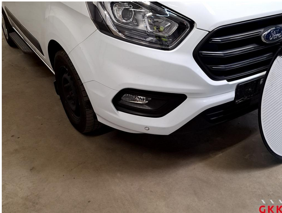
Bild 20 Stoßfänger vorne, Verkleidung -lackiert-, verkratzt, Spotlackieren
